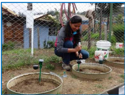
Extracción del aire con la bomba de vacío.
