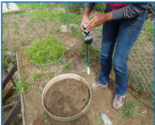
Colocación en el suelo de los lisímetros.
