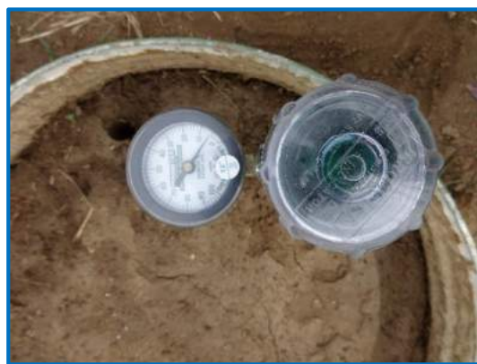
Tensiómetro ya instalado y marcando cero.
