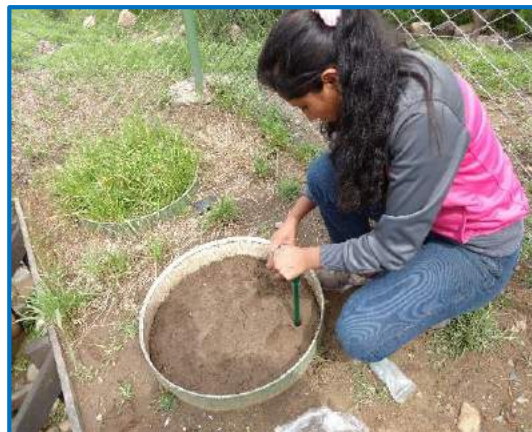
Colocación en el suelo de los lisímetros.
