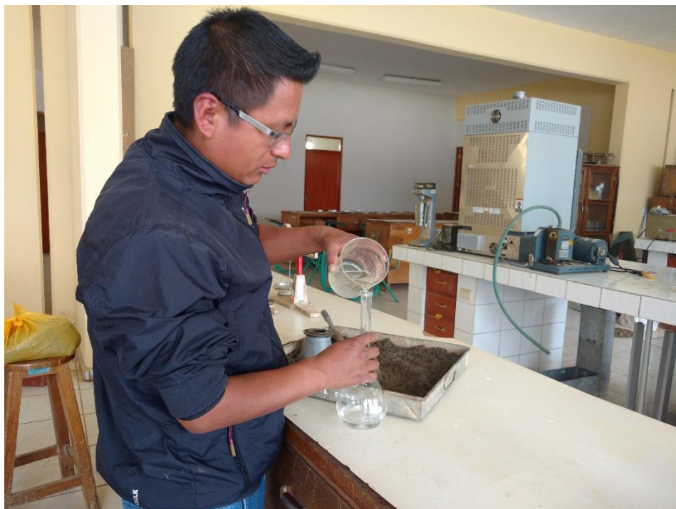
Figura N° 09. Equipos para determinar el peso del material saturado superficialmente seco del agregado fino.
