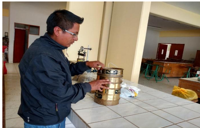
Figura N° 12: Equipos para realizar análisis granulométrico del agregado grueso.
