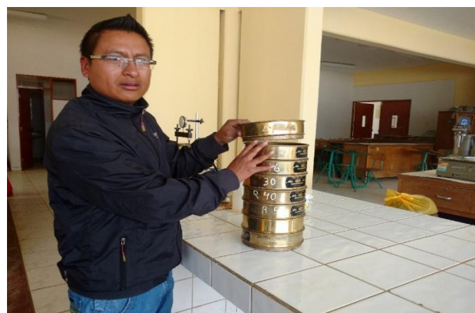
Figura N° 13: Equipos para realizar el análisis granulométrico del agregado fino.
