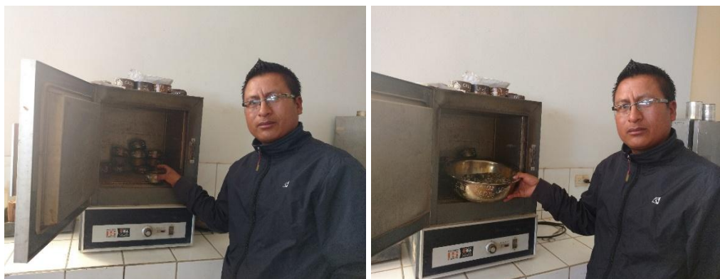
Figura N° 04: Estufa para el secado del agregado fino y agregado grueso.
