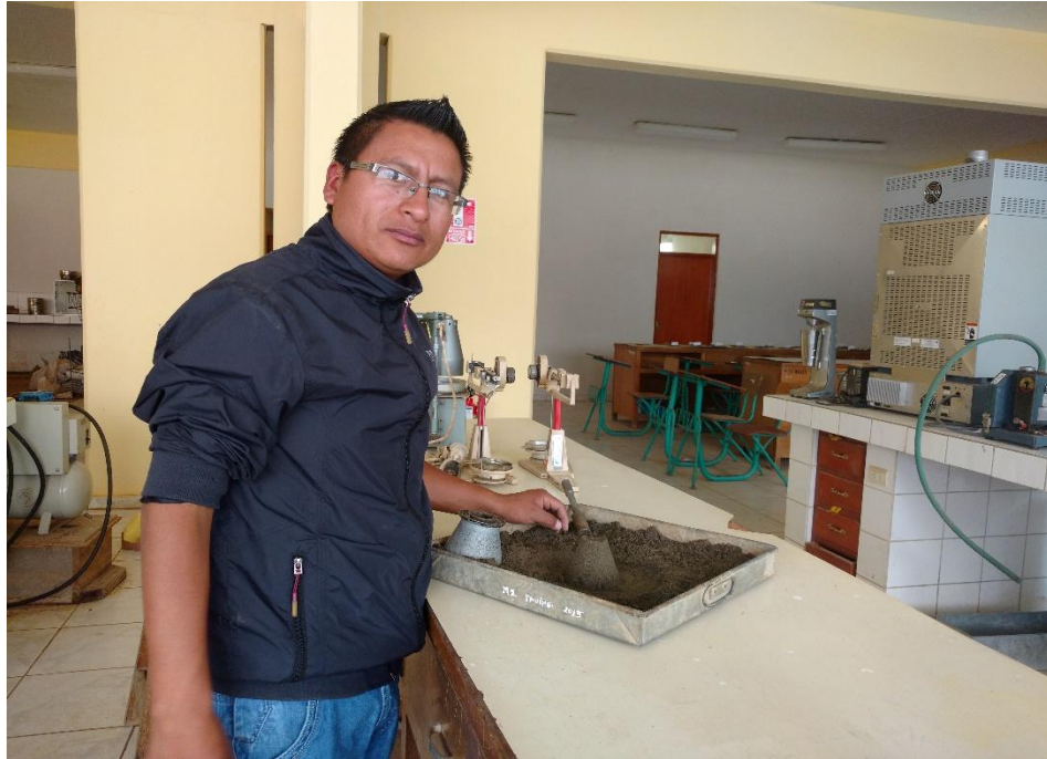
Figura N° 08. Equipo para realizar ensayo de peso específico del agregado fino.
