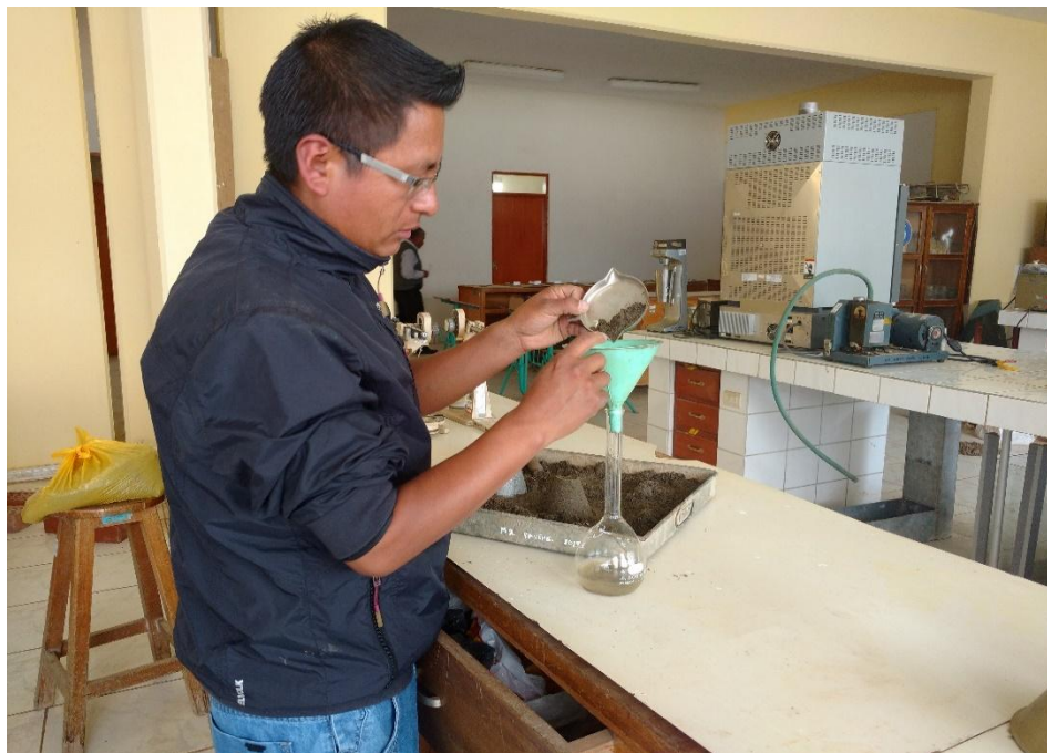
Figura N° 11. Equipo para determinar el peso de material saturado superficialmente seco del agregado fino.
