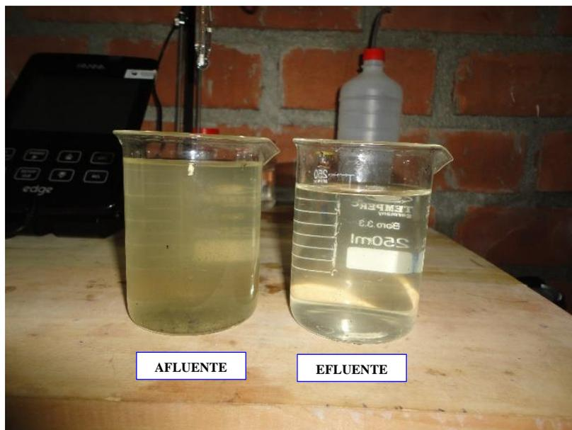
*Fotografía 18:* Comparación visual del color entre el afluente y efluente del sistema de esponjas colgantes continuas
