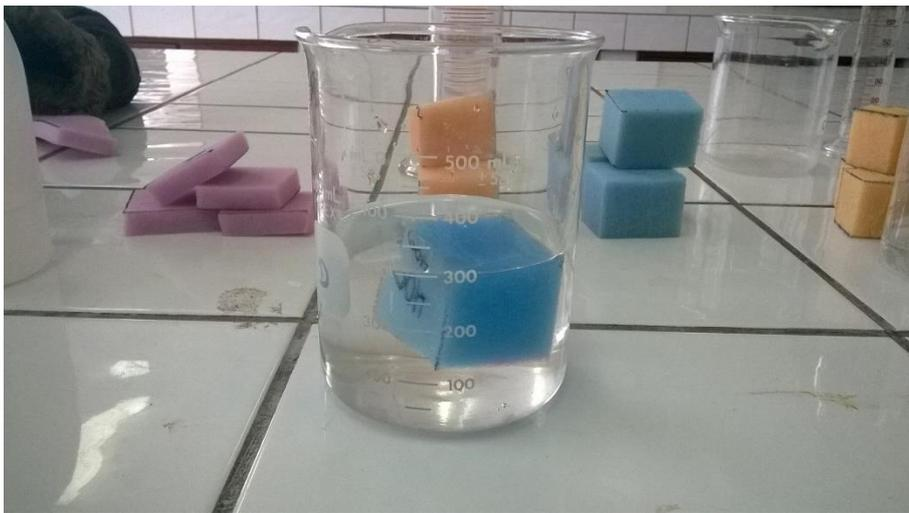
**Fotografía 26:** Determinación del porcentaje de porosidad de la espuma de poliuretano
