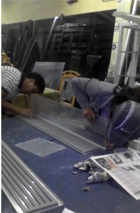
**Fotografía 27:** Construcción del reactor – armado de las placas de acrílico del reactor
