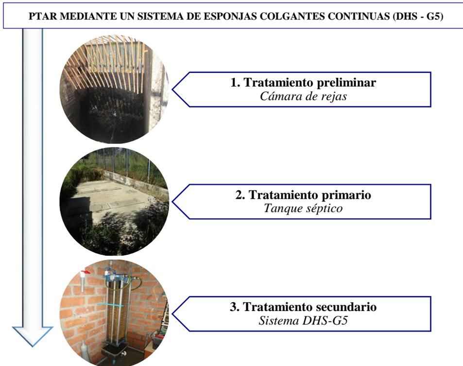
**Figura 18:** PTAR mediante un sistema de filtros de esponjas colgantes continuas
