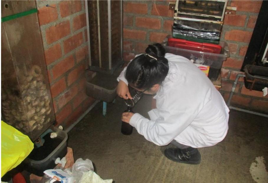
**Fotografía 37:** Toma de muestra para el análisis de parámetros de indicadores de contaminación microbiológica
