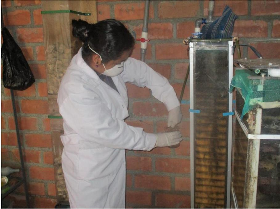
**Fotografía 35:** Aforo del afluente del sistema DHS-G5
