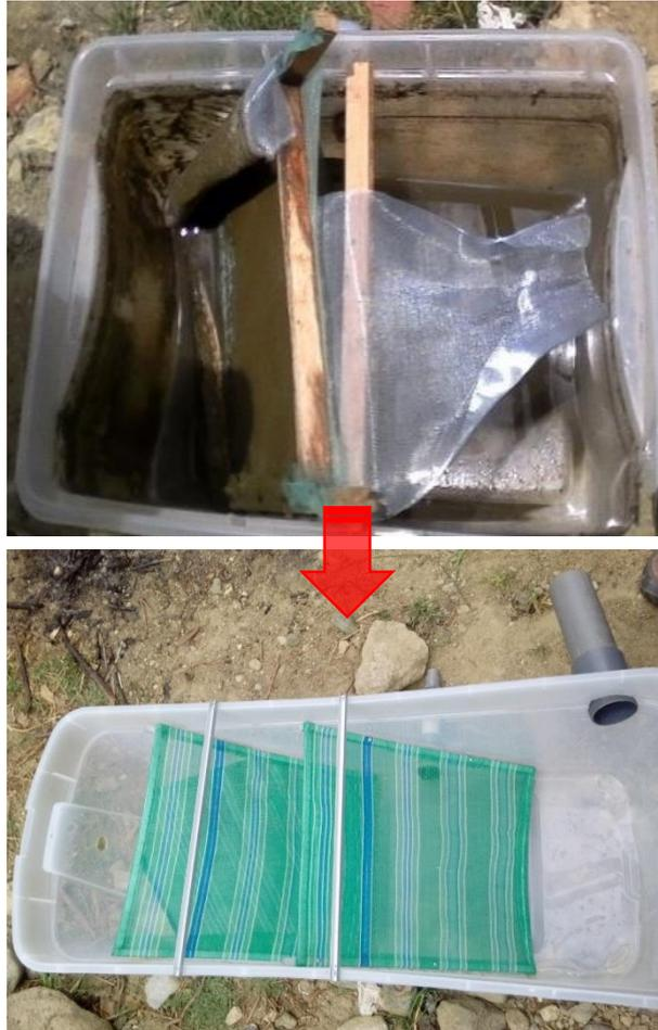
**Fotografía 9:** Implementación con láminas de malla de plástico
