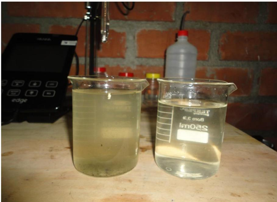
**Fotografía 52:** Comparación visual del color entre el afluente y efluente del sistema de filtros de esponjas colgantes continuas
