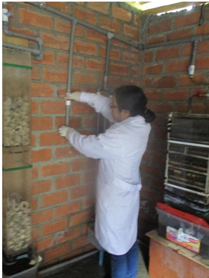
**Fotografía 36:** Toma de muestra para el monitoreo de los parámetros de pH y temperatura
