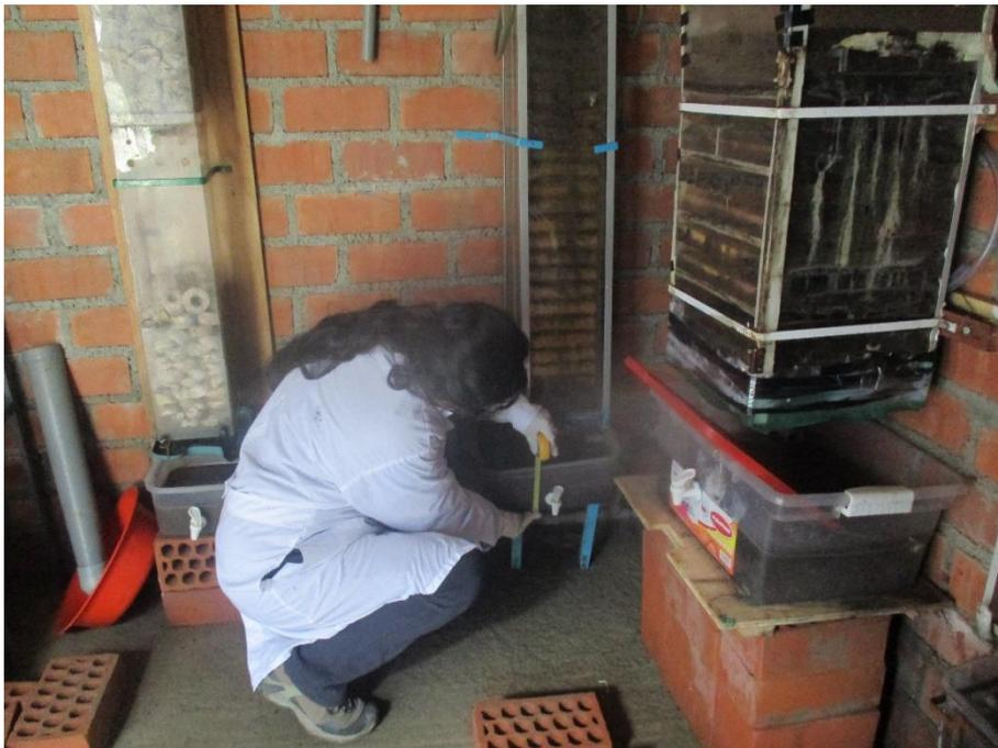
*Fotografía 54:* Medición de la cantidad de lodos en el sedimentador secundario
