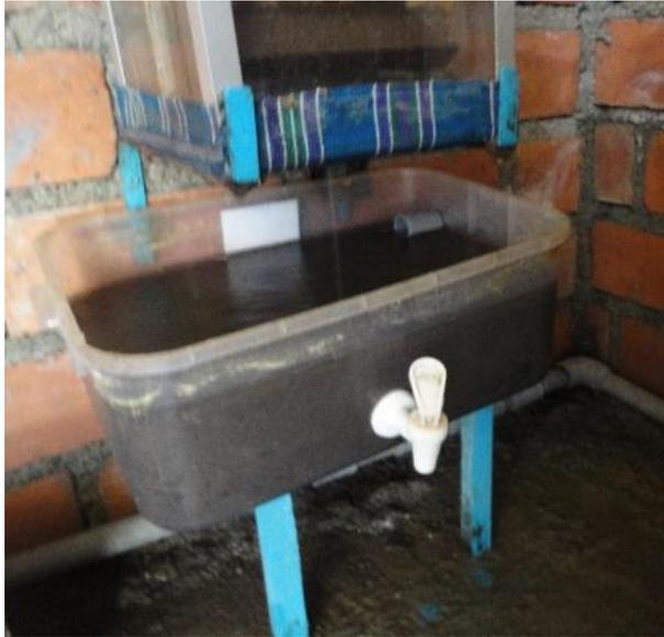
*Fotografía 14:* Implementación de un sedimentador de mayor capacidad
