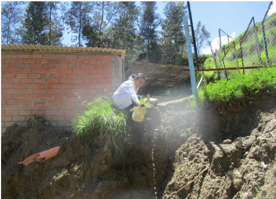
**Fotografía 34:** Aforo del afluente del sedimentador primario
