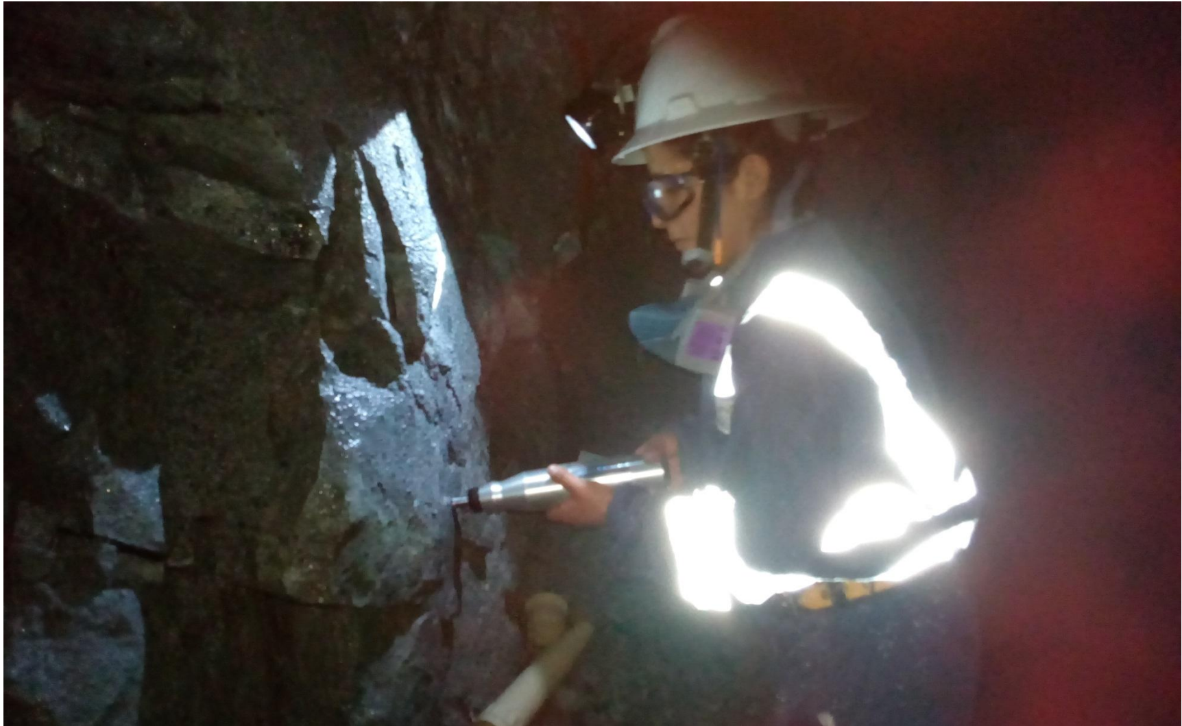
Anexo N° 09. Prueba de rebote con el Martillo Schdmith.
