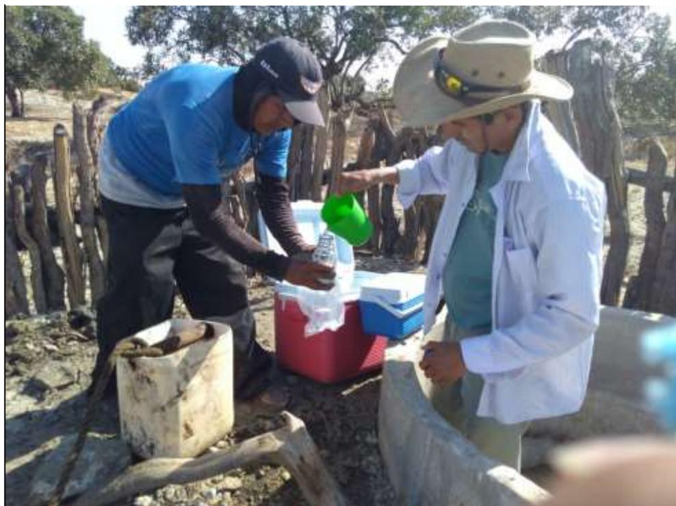
**Ilustración N°08: Recolección de muestras de 1 litro con depósitos esterilizados para analizar en la UDEP**
