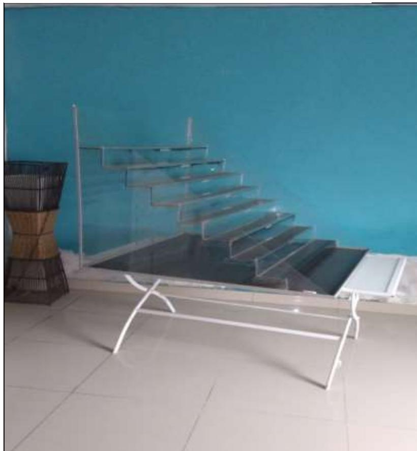
**Ilustración N°11: Módulo de destilación solar modelo en terrazas sin tapa con base mayor bases menores de vidrio negro.**
