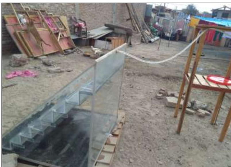
**Ilustración N°13: Ingreso del agua a tratar hacia el módulo es por gravedad**
