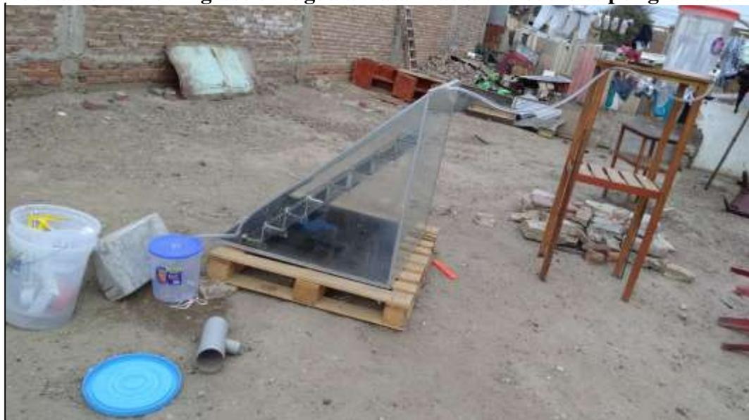
**Ilustración N°14: Módulo de destilación solar modelo en terrazas instalado y trabajando**
