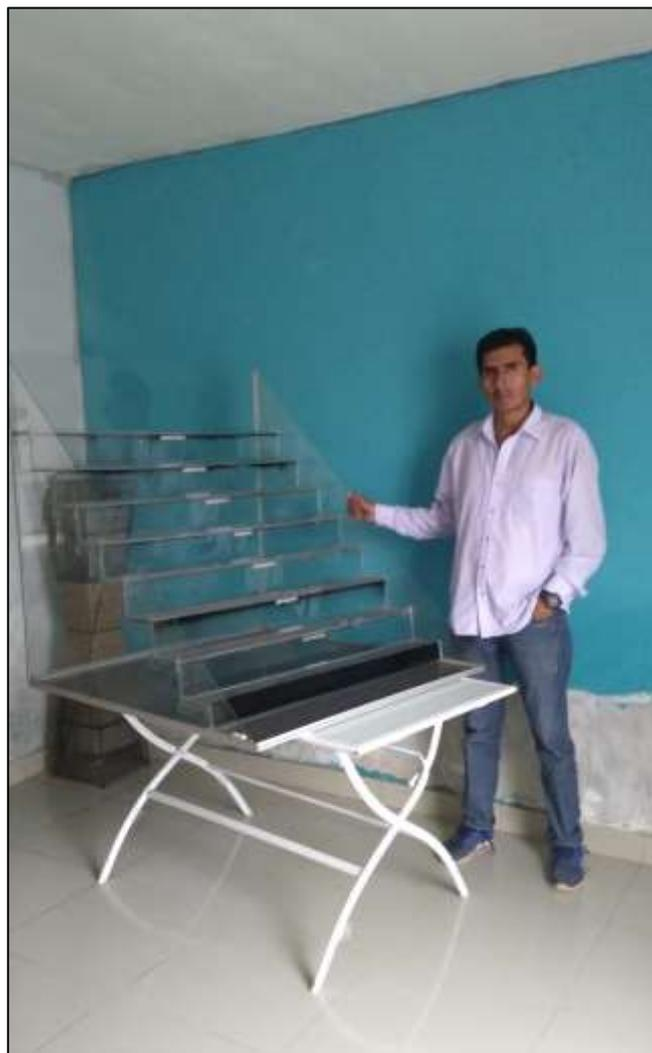
**Ilustración N°12: Módulo de destilación solar modelo en terrazas instalado y trabajando**
