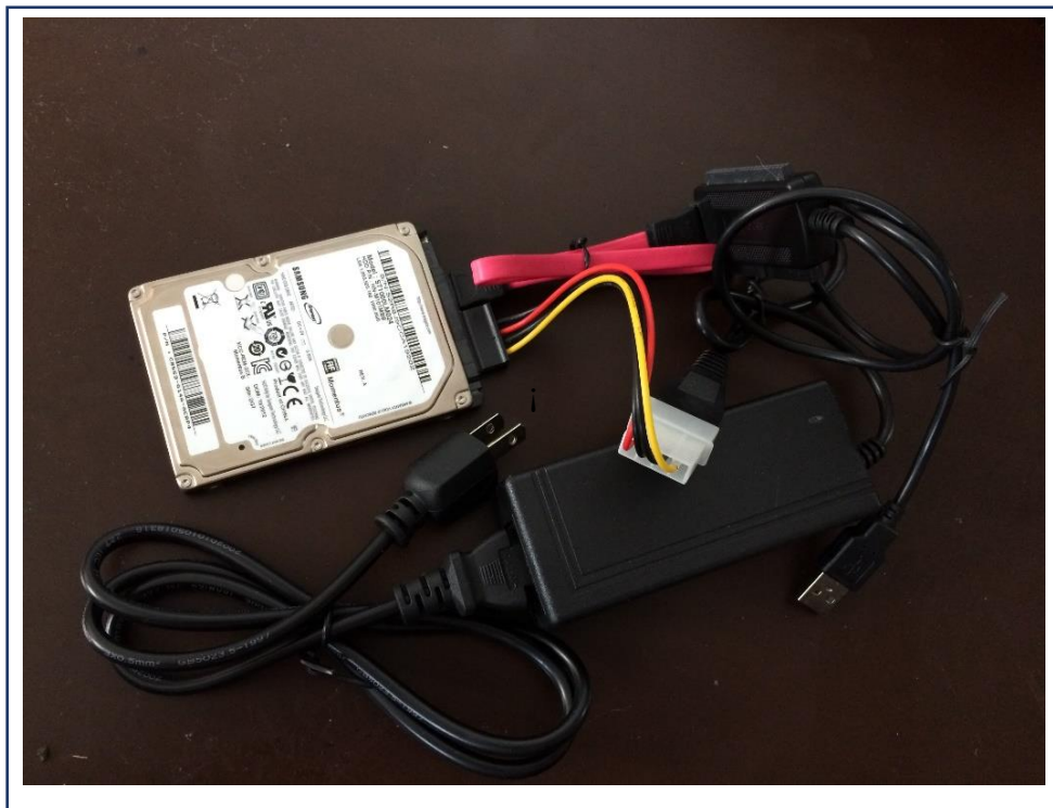
Figura 2.15. Disco duro sata de laptop conectado a Equipo Firewir
