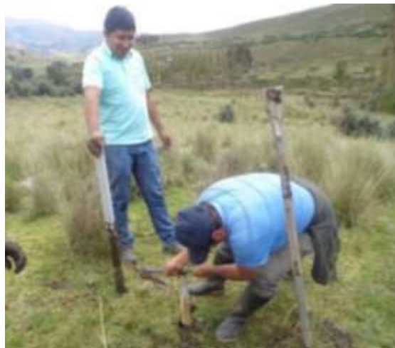
Figura 15. Instalación del Piezómetro (zona dominada por pastos)
