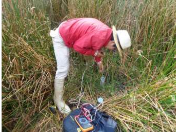
Fotografía N° 14. Medida del nivel de la napa freática en los piezómetros.
