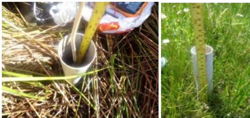
Figura 16. Medición de nivel de napa freática en el piezómetro (zona dominada por Jueb).
