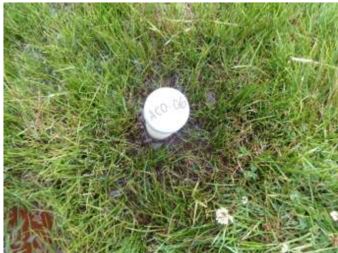
Fotografía N° 10. Vista de uno de los piezómetros instalados (Aco-06) en una zona donde domina el Jueb.
