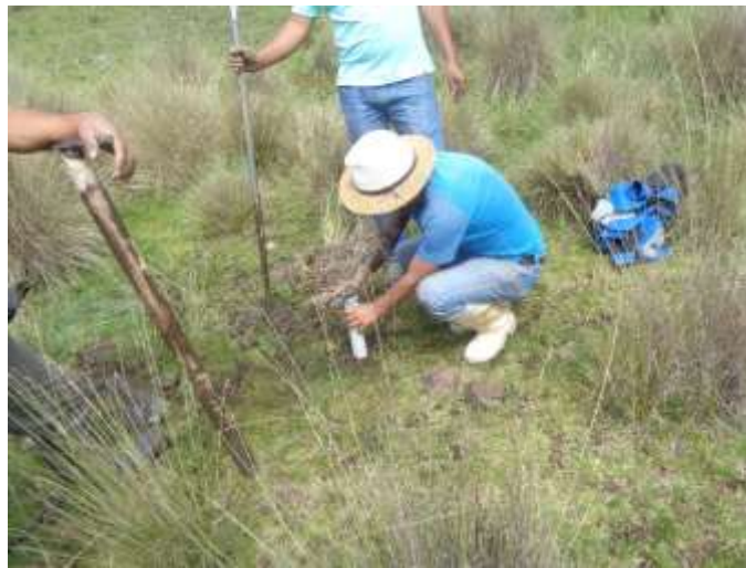
Fotografía N° 9. Instalación de los piezómetros en los 13 sitios de evaluación.
