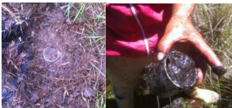
Figura 11. Toma de muestra de suelo para determinar la densidad aparente.
