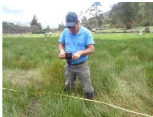
Figura 10. Medición de la compactación y/o profundidad con el penetrómetro.
