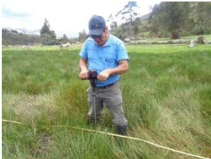
Fotografía N° 13. Medida de compactación y profundidad del suelo con el Penetrómetro.
