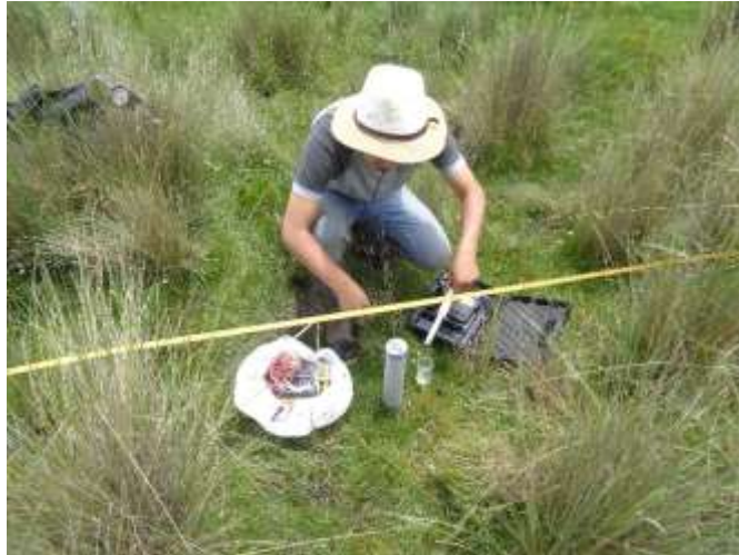
Fotografía N° 11. Medición de parámetros de campo (pH, T°, CE, TDS) de agua en los piezómetros.
