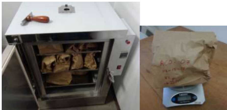
Figura 20. Secado y pesado de muestras
