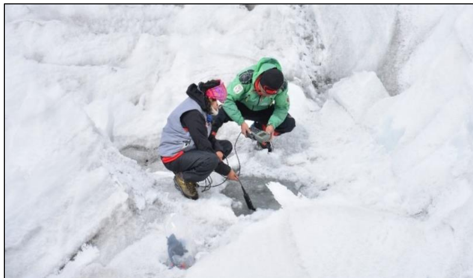
Figura 32: Medición de parámetros físico-químicos en los pozos de acumulación por fusión, Nevado Pastoruri 5145 msnm
