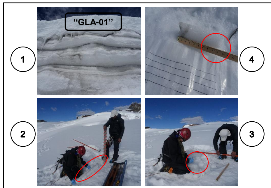
Figura 31: Esquema de obtención de muestras de hielo por perforación "B", Nevado Pastoruri 2017.
