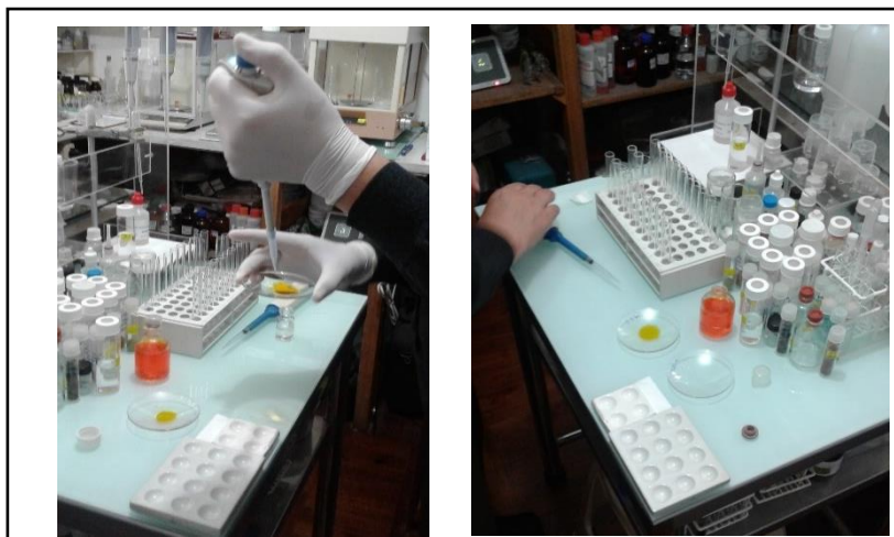
Figura 40: Oxidación del carbono orgánico para la determinación de Carbono orgánico total en muestras de sedimento.
