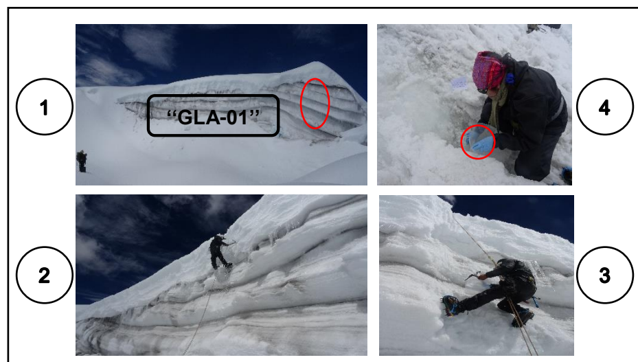
Figura 29: Esquema de obtención de muestras de hielo Operación “A”, frente glaciar Pastoruri
