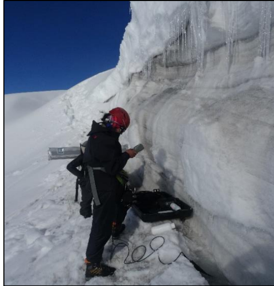
Figura 33: Medición de parámetros físico-químicos in situ (pH, Conductividad), pozo de acumulación por fusión, Nevado Pastoruri, 2017
