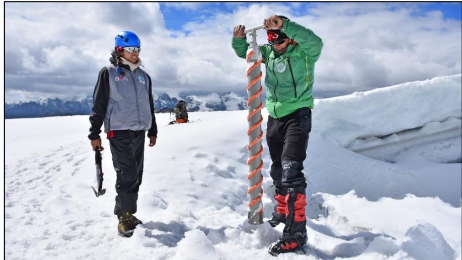
Figura 30: Perforación de estratos de hielo mediante la operación "B", Nevado Pastoruri 2017.
