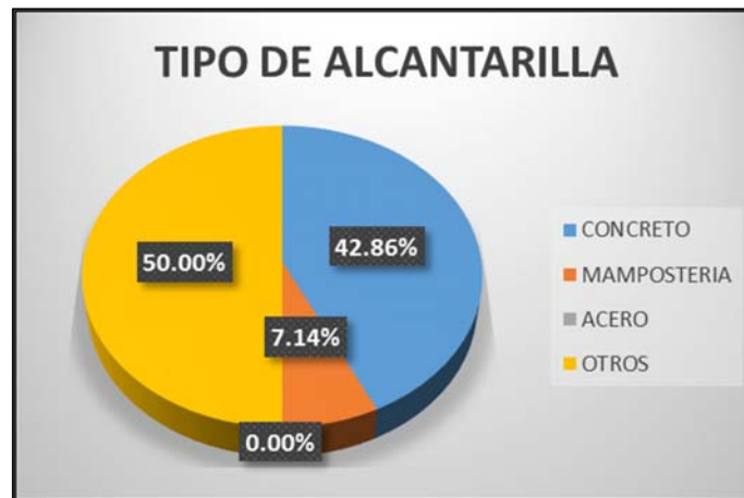
Figura N° 22: Tipo de Alcantarillas
