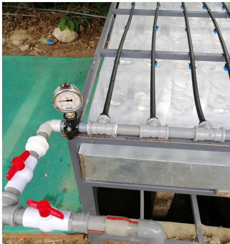
Anexo 9.16. calibración de la llave de paso para graduar la presión de trabajo.
