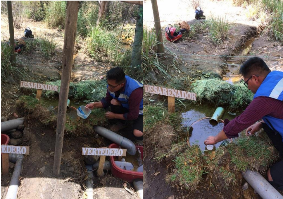
Figura 13: Medición de pH en campo y toma de muestra, al ingreso del sistema de canales
