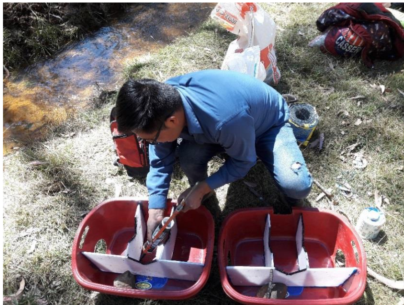
Figura 7: Colocación y sellado de los vertederos triangulares y rectangular sobre la tina de plástico
