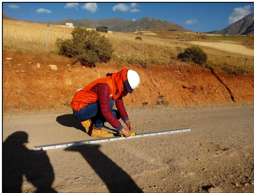
Figura 15. Medición del Tramo Inicial con un Eclímetro En la figura se muestra la medición de la pendiente de la Carretera con la ayuda de un eclímetro.
