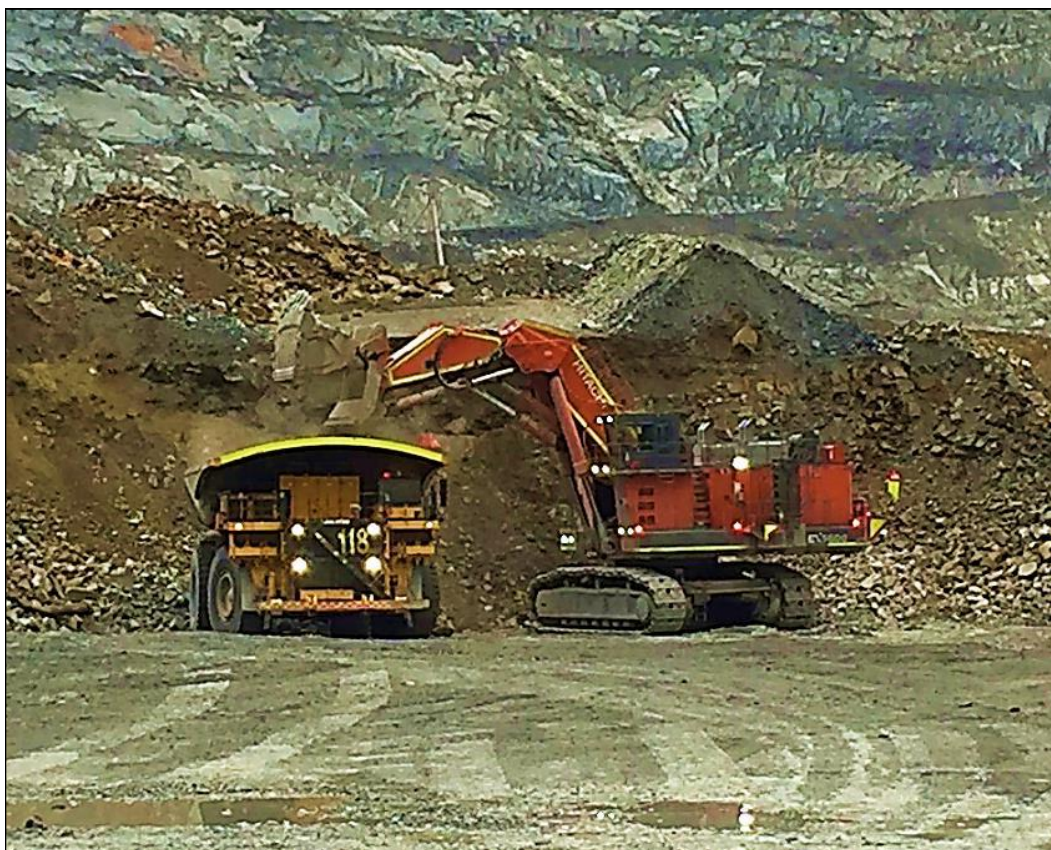
Figura N° 17: Pala hidráulica Hitachi Fuente: Operaciones Antamina
