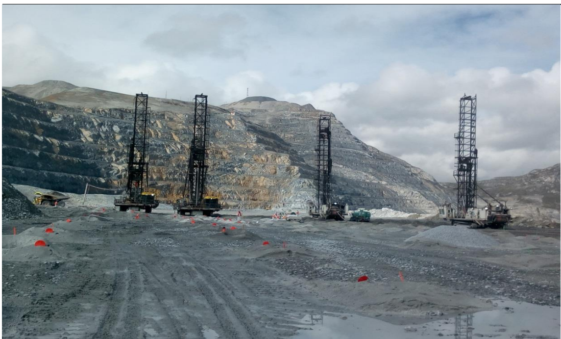
Figura N° 8: perforadoras de diámetro de 12 1/4" Fuente: Operaciones Antamina
