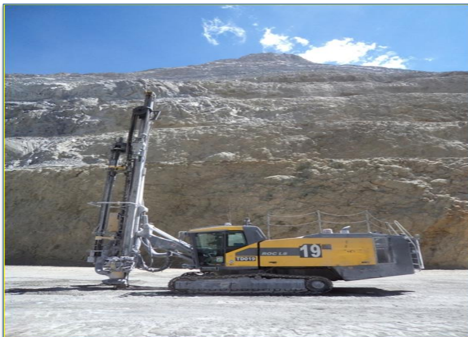
Figura N° 10: perforadora de diámetro 5” Fuente: Operaciones Antamina
