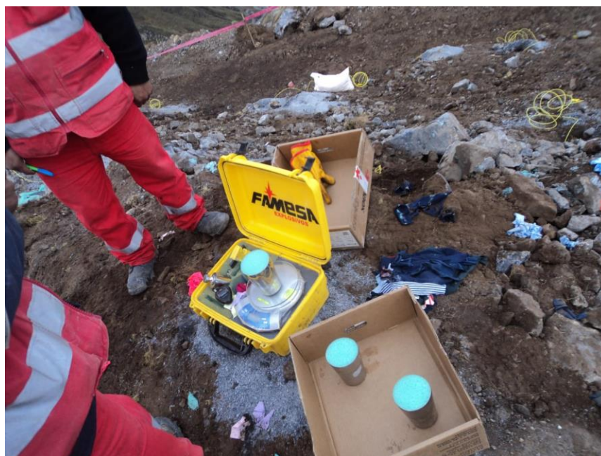
Fotografía N° 8: Medición de la densidad en campo en la mina Antamina fase 8
