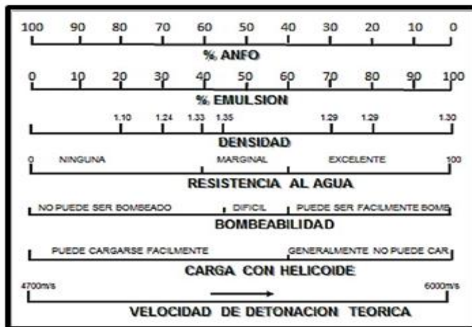
Figura N° 25: Características de diferentes mezclas de ANFO Pesado. Fuente: Du Pont, 1986.
