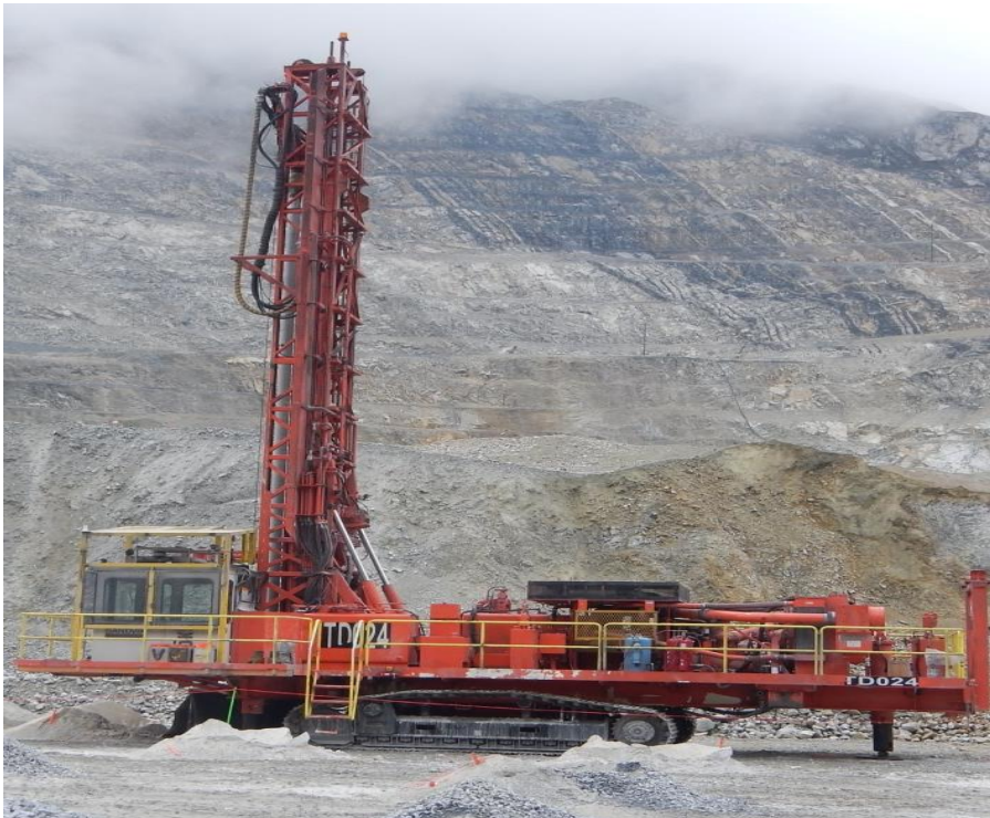
Figura N° 9: perforadoras de diámetro de 9 7/8” Fuente: Operaciones Antamina
