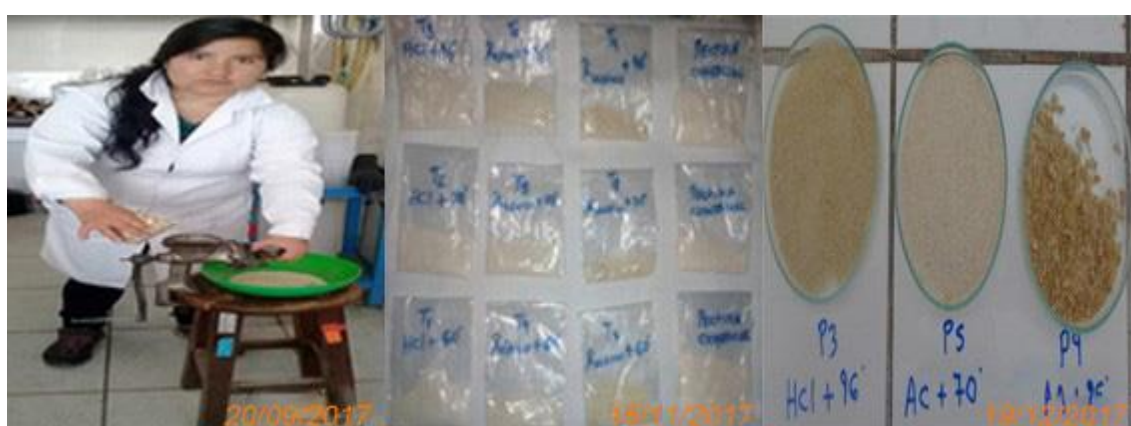
Anexo 07-Imagen 7. Molienda y envasado de la pectina del albedo seco de naranja
