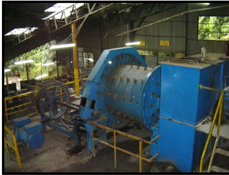
Foto 02: molino de bolas 5 a x5 a
