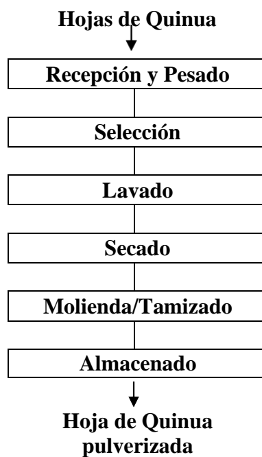
Figura 1: Diagrama de flujo de la hoja de quinua pulverizada
