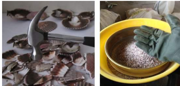
Figura 2.7. Proceso de trituración y tamizado
