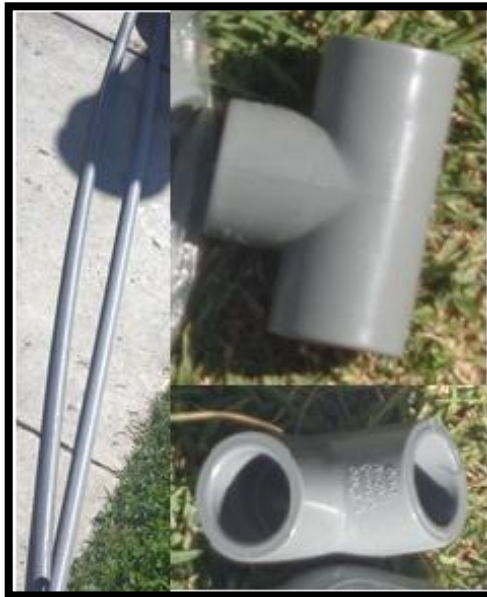
Fotografía 3.11 Accesorios para la conducción del agua cruda.
