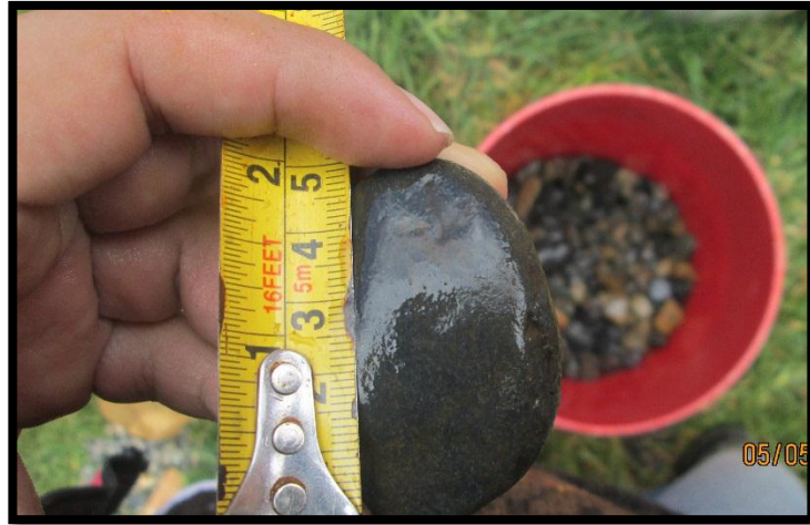
Fotografía 3.33 Instalación de la grava como medio soporte
