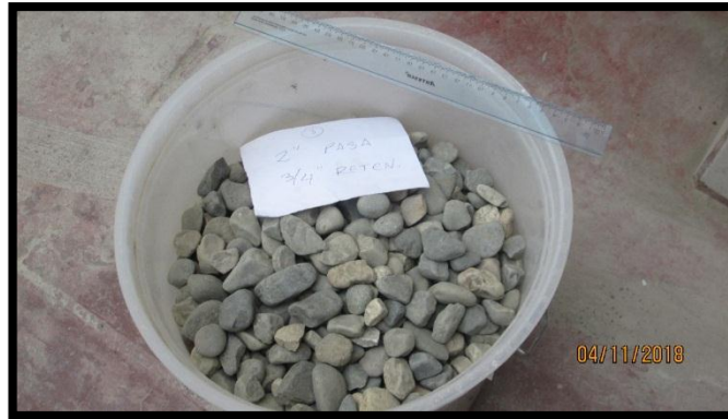
Fotografía 3.2 Grava de 50 milímetros a 19 milímetros
