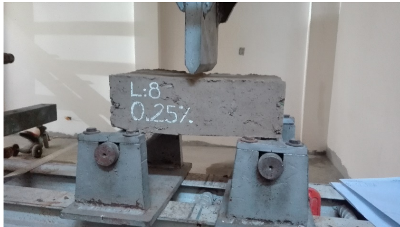
Figura 14. Disposición de la máquina de ensayo a tracción por flexión de la unidad de adobe compactado.
