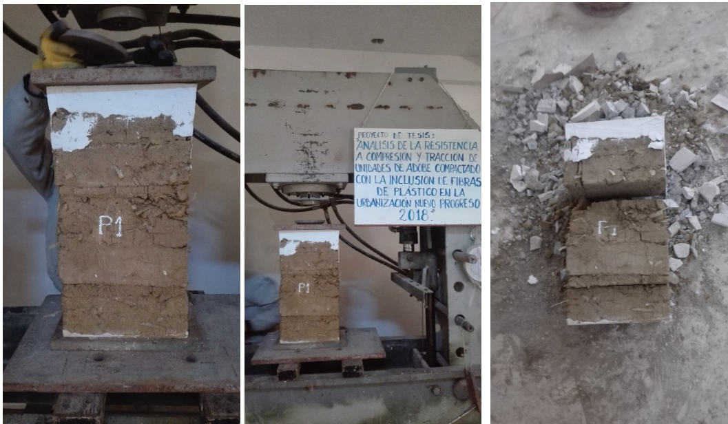
Figura G.1.3. Ensayo de la pila P1 y su tipo de falla.
