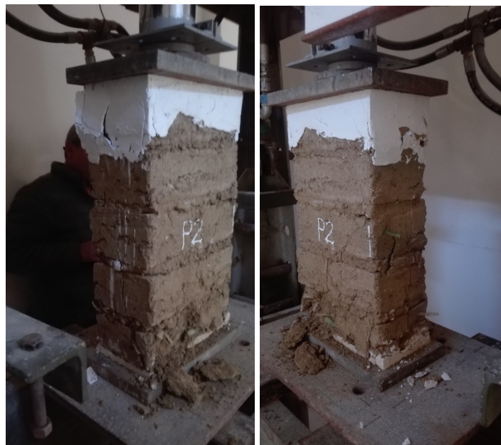
Figura G.1.5. Ensayo de la pila P2 y su tipo de falla.
