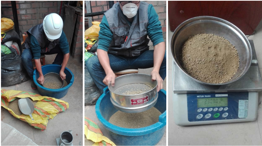
Figura A.2.1. Proceso de tamizado y determinación de los pesos a utilizar en el ensayo.
