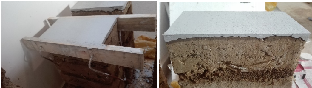
Figura G.1.2. Refrentado de las pilas de adobe compactado.
