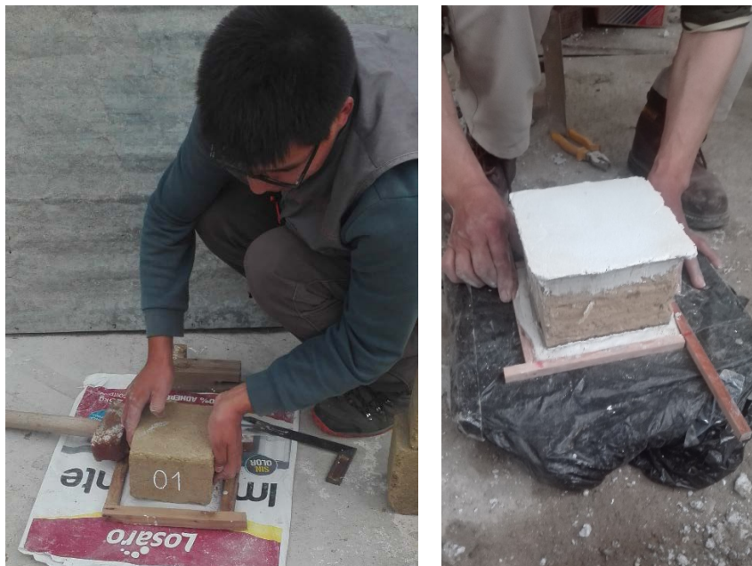
Figura E.1.2. Proceso de refrentado de las unidades.
