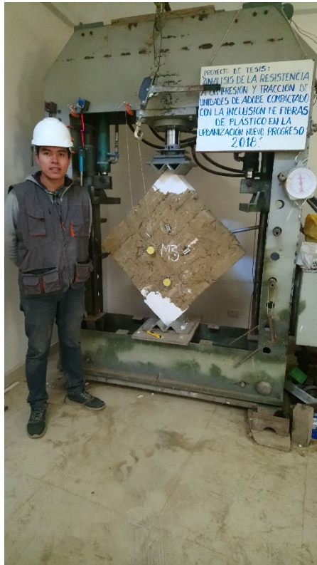
Figura G.1.4. Presentación del murete 3 a la máquina de ensayo.
