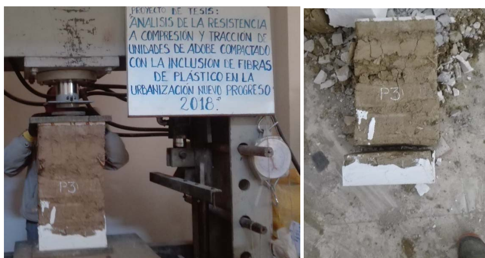
Figura G.1.6. Ensayo de la pila P3 y su tipo de falla.
