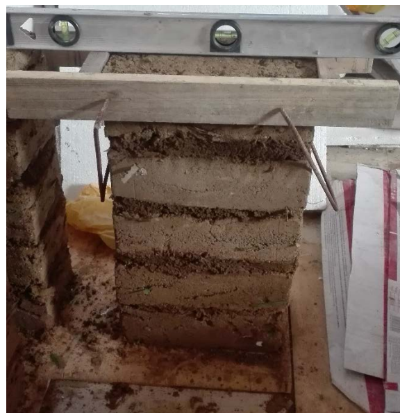
Figura 24. Disposición de las unidades en la construcción de las pilas
