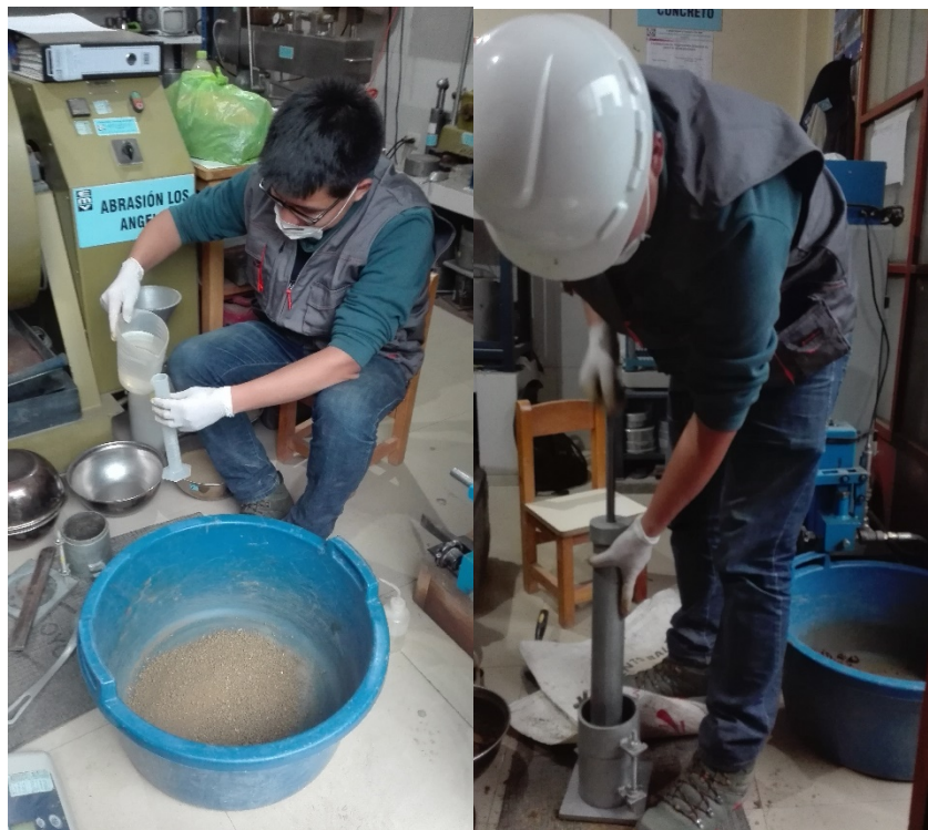
Figura A.2.2. Proceso de tamizado y determinación de los pesos a utilizar en el ensayo.
