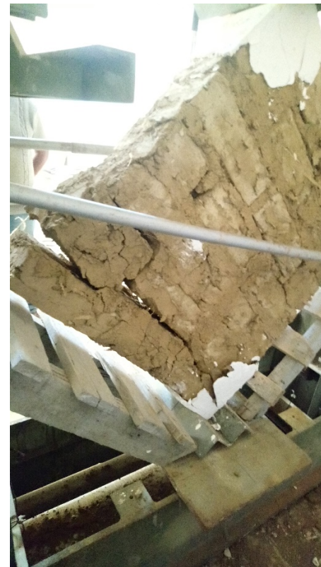
Figura G.1.5. Ensayo del murete 3 y tipo de falla.
