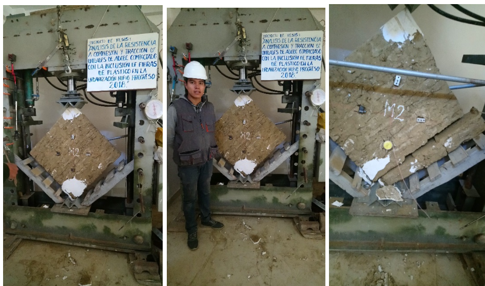
Figura G.1.3. Ensayo del murete 2 y tipo de falla.
