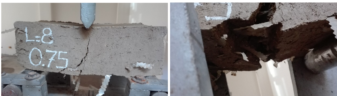
Figura F.1.4. Forma de falla de la unidad de adobe compactado.
