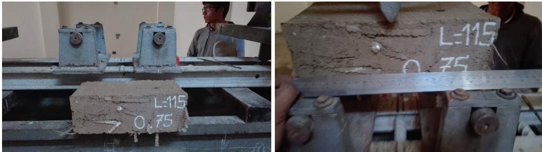
Figura F.1.1. Preparación de la máquina de ensayo y toma de medidas longitudinales de la unidad de adobe compactado.
