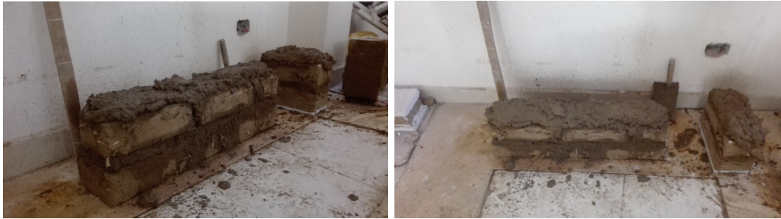
Figura G.1.1. Elaboración de muretes de adobe compactado.
