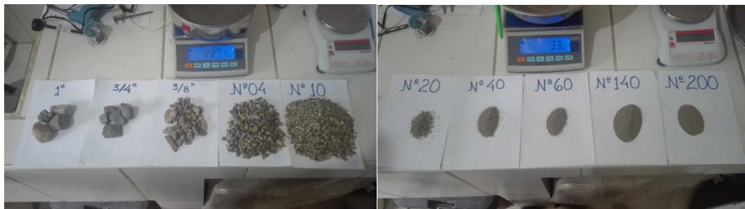
Figura A.1.2. Granulometría del suelo empleado en la elaboración de las unidades de adobe compactado.
