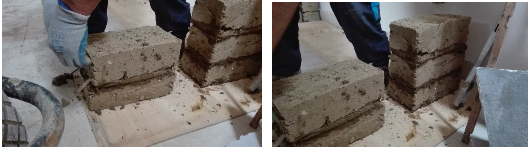
Figura G.1.1. Elaboración de las pilas de adobe compactado.
