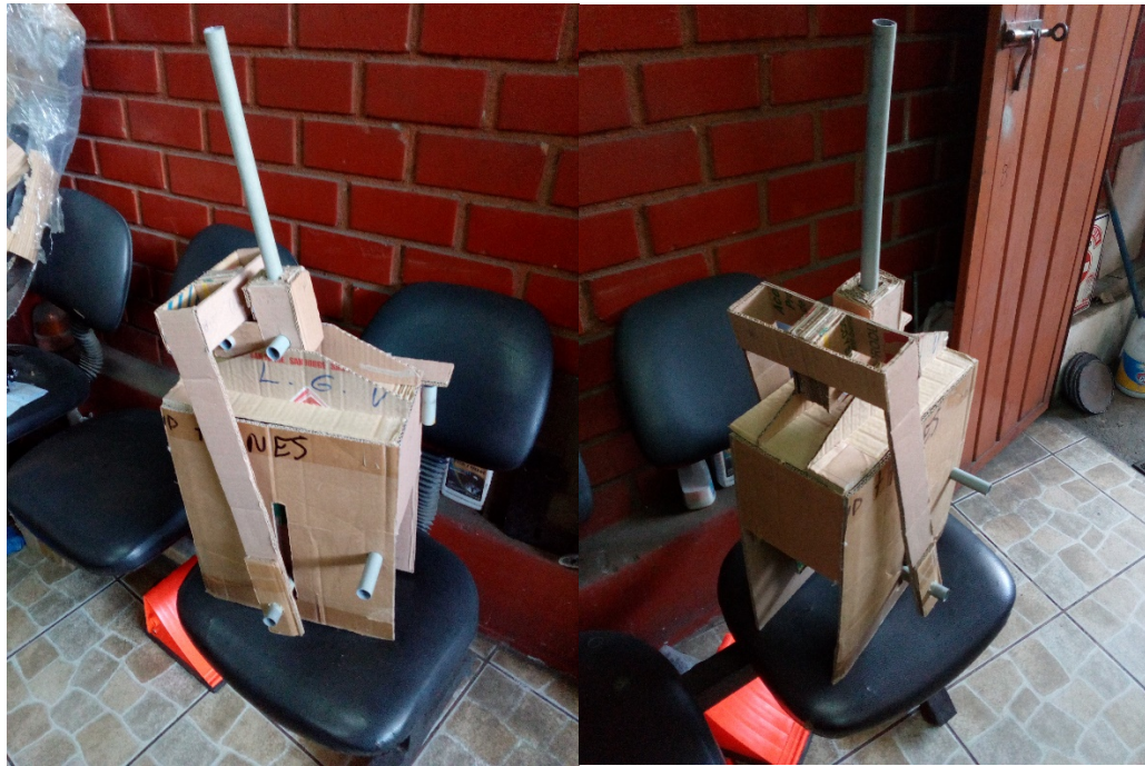
Figura C.1. Vistas de la maqueta de la máquina CINVA RAM
