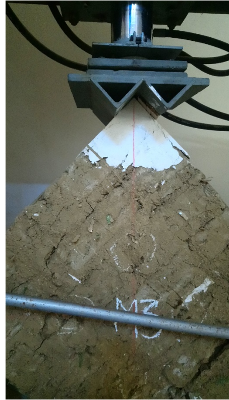
Figura G.1.4. Presentación del murete 3 a la máquina de ensayo.
