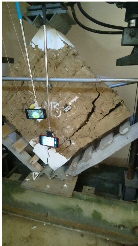
Figura G.1.5. Ensayo del murete 3 y tipo de falla.
