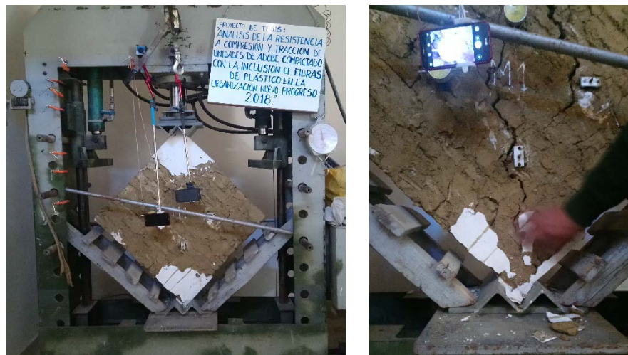
Figura G.1.2. Ensayo del murete 1 y tipo de falla.
