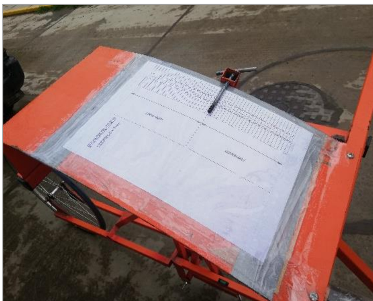
Fotografía 8: Calibración del brazo móvil, en el número 25 de la escala de medición. Fuente: Propia
