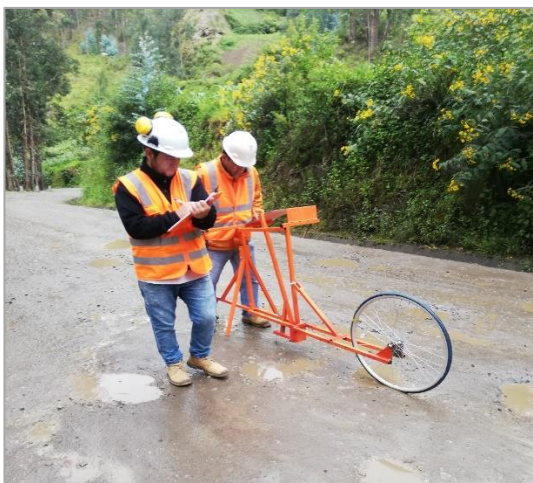
Fotografía 20: Medición con el rugosímetro de Merlín, tramo 06. Progresiva km 2+200. Fuente: propia.
