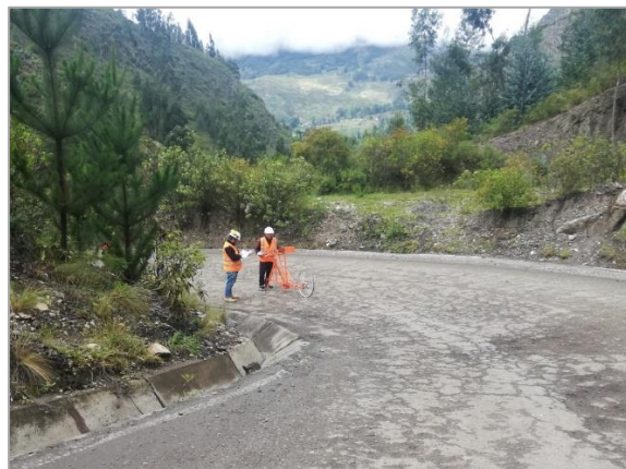
Fotografía 13: Medición con el rugosímetro de Merlín, tramo 02. Progresiva km 0+720. Fuente: propia.
