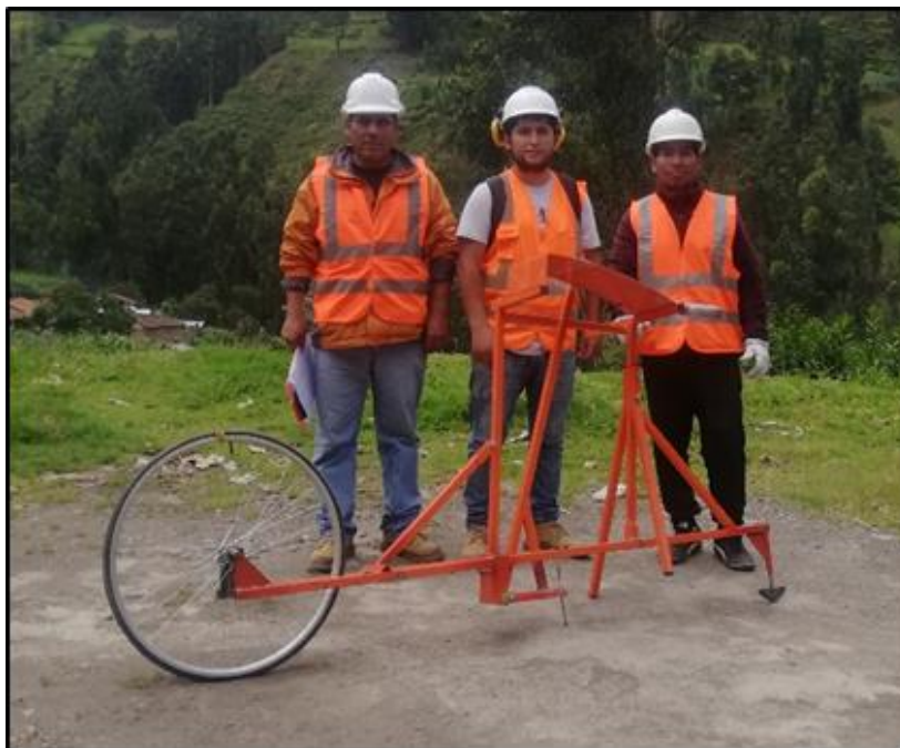
Figura 6: Rugosímetro de merlín empleado para los ensayos en esta tesis. Fuente: Imagen propia.
