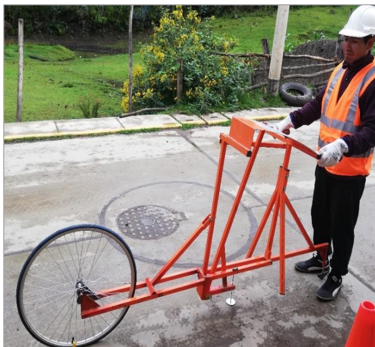
Fotografía 9: Nivelación con la pastilla de 6mm, el equipo del rugosímetro de merlín. Fuente: Propia
