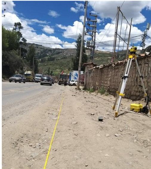
**Figura 45.** Medición de las cotas de la carretera Huaraz-Recuay.
