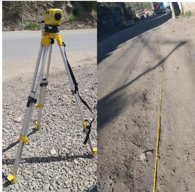
**Figura 44.** Instalación del nivel de ingeniero y colocación de la cinta métrica.
