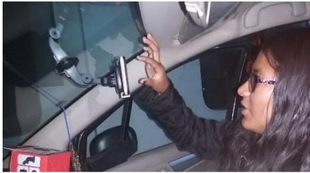
Fotografía 1. Instalación del dispositivo para la toma de datos por el método Roadroid.
