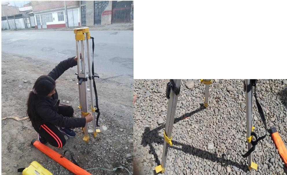
**Figura 43.** Posicionamiento del trípode.
