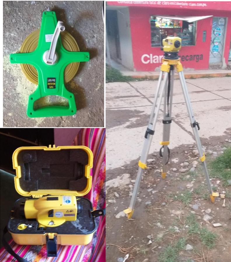
**Figura 42.** Instrumentos utilizados en la recolección de datos con el Método Mira y Nivel.
