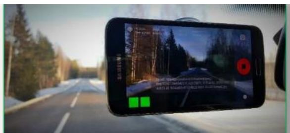
*Figura 9.* Teléfono inteligente con la aplicación Roadroid, para medir el IRI.
