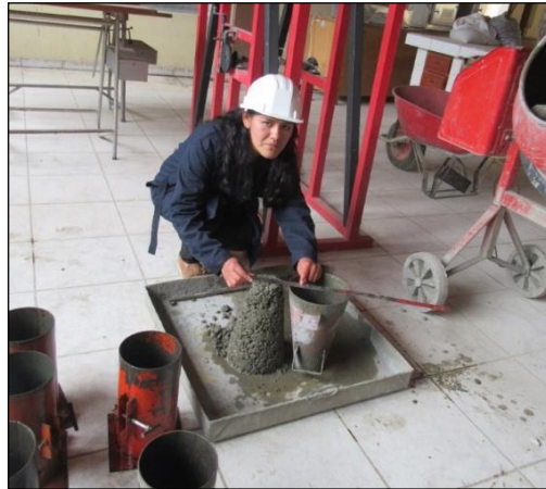
Medición del asentamiento
