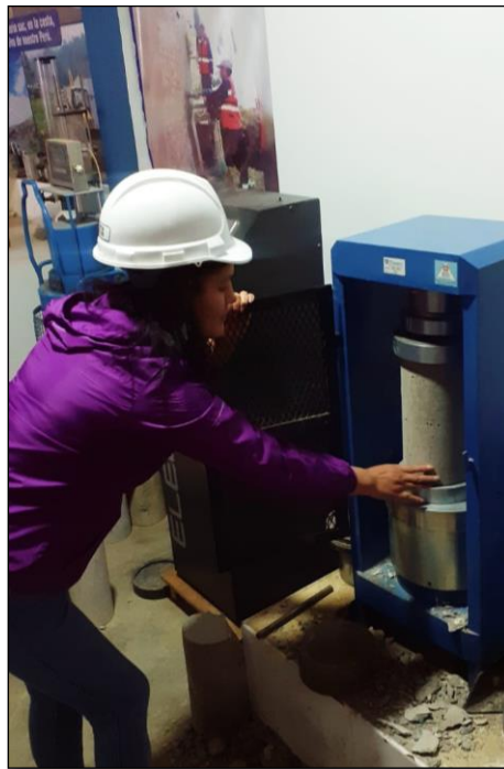
Colocando la probeta para el ensayo a la compresión
