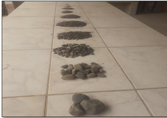
El agregado separado de acuerdo a las mallas
