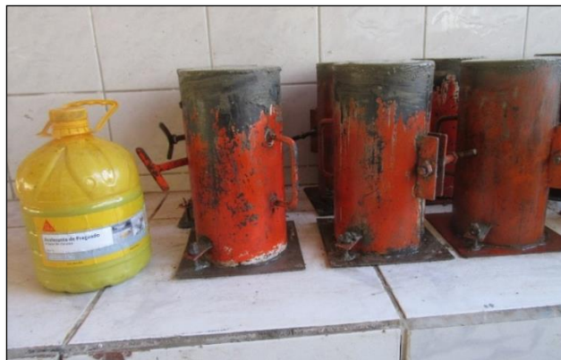
Probetas de concreto con aditivo acelerante Sika 3
