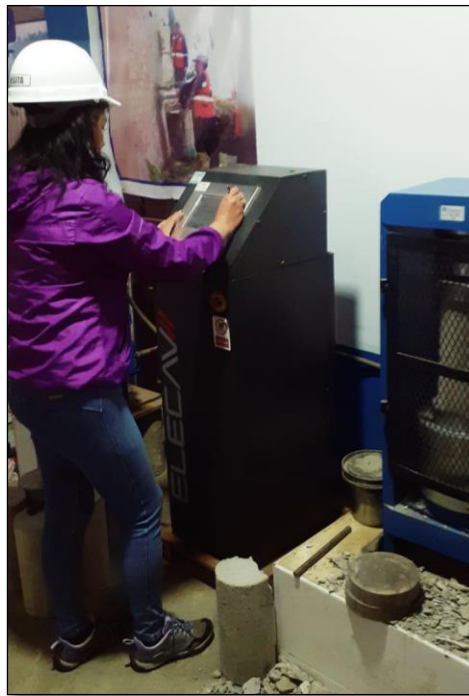
Realizando el ensayo de compresión
