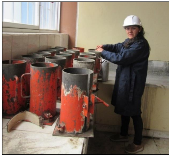
Aplicación de una capa ligera de petróleo sobre los moldes
