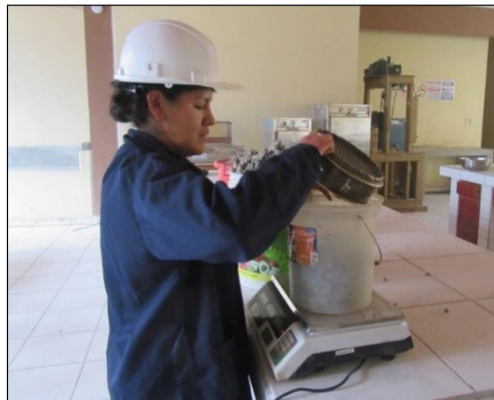
Pesando el agregado grueso
