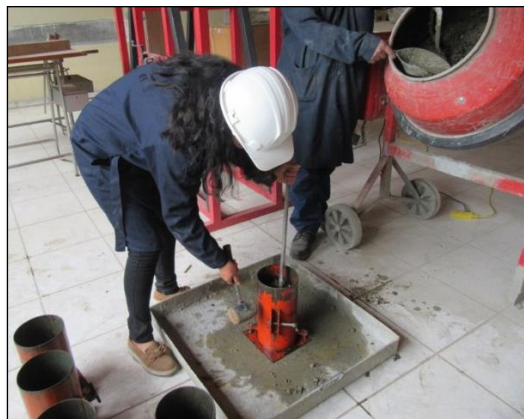
Vaciado de la mezcla en el molde
