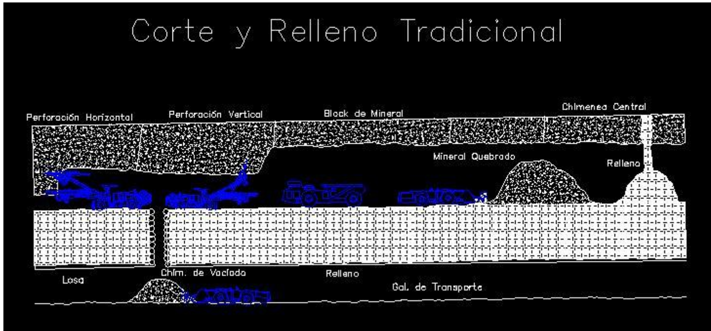
FIGURA N° 01: CORTE Y RELLENO TRADICIONAL.
