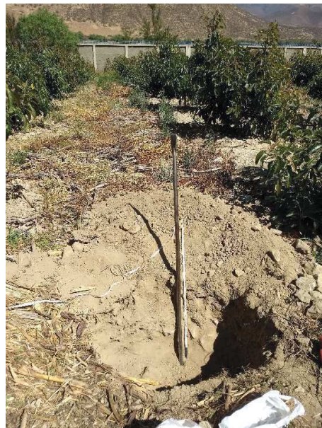
Imagen 08: Calicata de 0.60 m de profundidad
