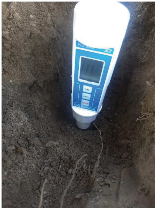
Imagen 23: Medición del contenido de humedad utilizado el PMS-714.
