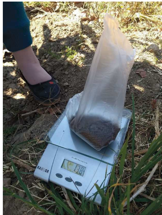
Imagen 20: Pesado de la muestra de suelo para el control de humedad.
