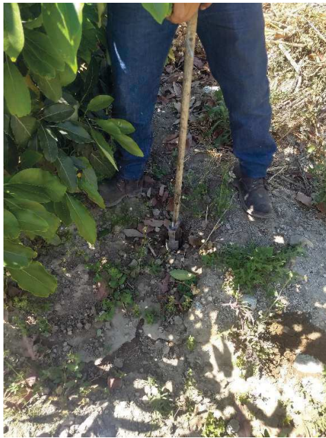
Imagen 19: Muestreo de suelo para control de humedad a una profundidad de 20-35 cm.
