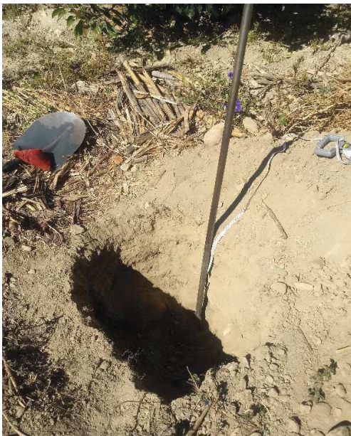
Imagen 07: Excavación de calicata de 0.8x1.00 m para sacar muestra de suelo.
