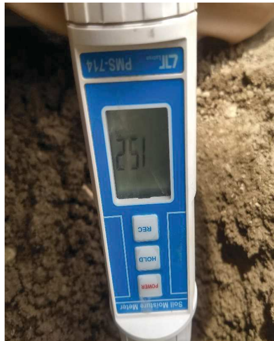
Imagen 24: Medición del contenido de humedad utilizado el PMS-714.
