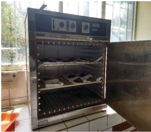
Imagen 23: Medición del contenido de humedad utilizado el PMS-714.
