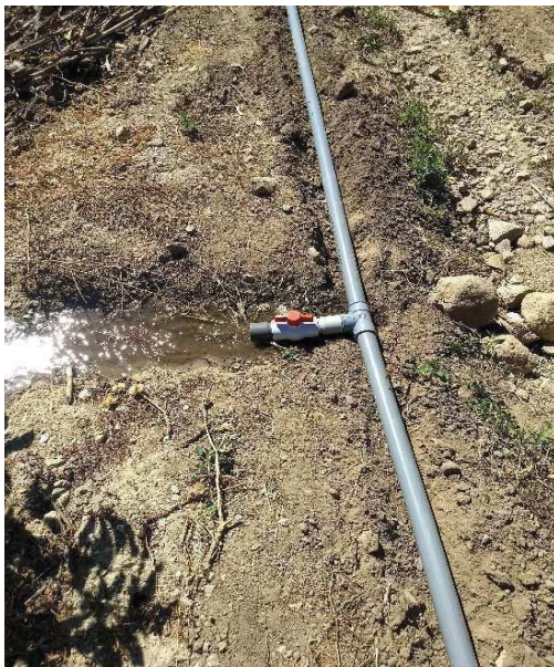
Imagen 11: Aplicación del caudal máximo no erosivo.
