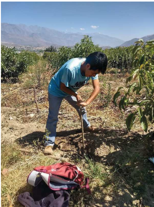
Imagen 19: Muestreo de suelo para control de humedad a una profundidad de 20-35 cm.
