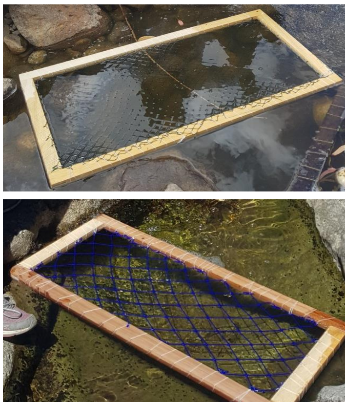
Fotografía 5. Soporte para el bioindicador Allium cepa expuesto en el cauce del río
