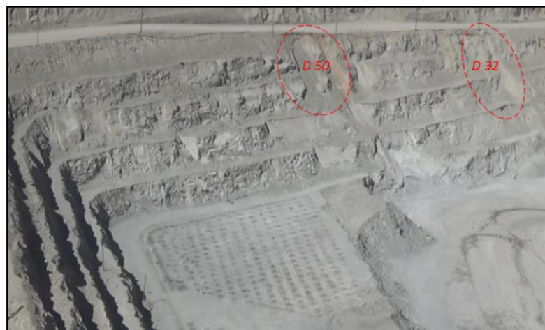
Figura 60. Se muestra el Deslizamiento 50 (D50) por Efecto de Energía Asociada a Bajas Frecuencias en el Campo Lejano. Fuente: Diseño Propio.
