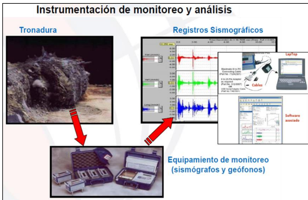
Figura 58. Esquema de Instrumentación de Monitoreo de Vibraciones. Fuente: Diseño Propio, Adaptada de Geoblast.
