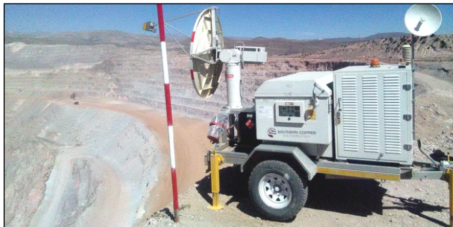
Figura 12. Ubicación del Radar 059, Ubicado en el Talud Sur Oeste (539491.8, 84598.9, 3776.9), Monitorea Fase 8, Fase 6A y Fase 6B2. Fuente: Superintendencia de Geotecnia Mina Cuajone (2018).
