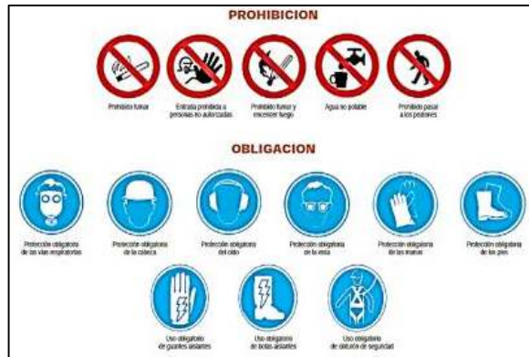
Figura 40. Señalización de prohibición y obligación.
