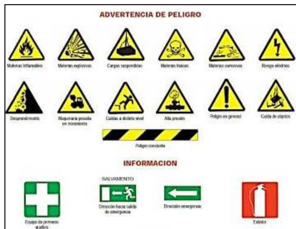
Figura 41. Señalización de Advertencia de peligro.
