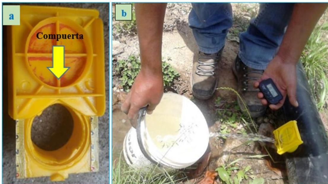
Nota: a) Se controló con una compuerta con medidas, b) Se estimó el QMNE teórico mediante el aforo volumétrico.
