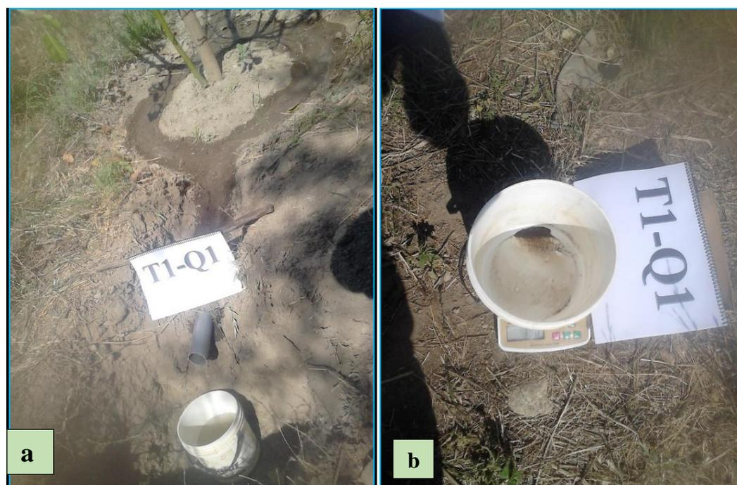
Nota: a). La medición de la pérdida del volumen de agua por escorrentía. b). La medición del peso del sedimento.
