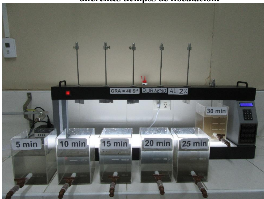
Fotografía N°32 Parámetros de Floculación con la Gradiente de 40 \text{ S}^{-1} a diferentes tiempos de floculación.
