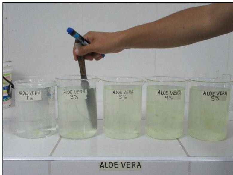
Fotografía N°16: Coagulante Aloe Vera agitado y preparado a distintas concentraciones.
