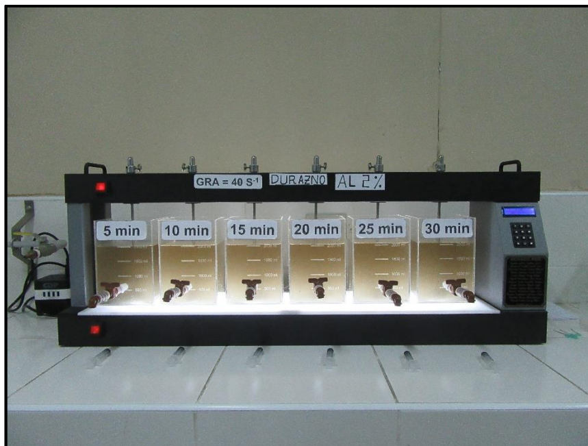
Fotografía N°31 Equipo de Prueba de jarras – Previo a la Determinación de Parámetros de Floculación con la Gradiente de 40 \text{ S}^{-1} y Velocidad de 34 rpm.
