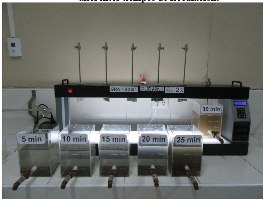
Fotografía N°28 Parámetros de Floculación con la Gradiente de 80 \text{ S}^{-1} a diferentes tiempos de floculación.
