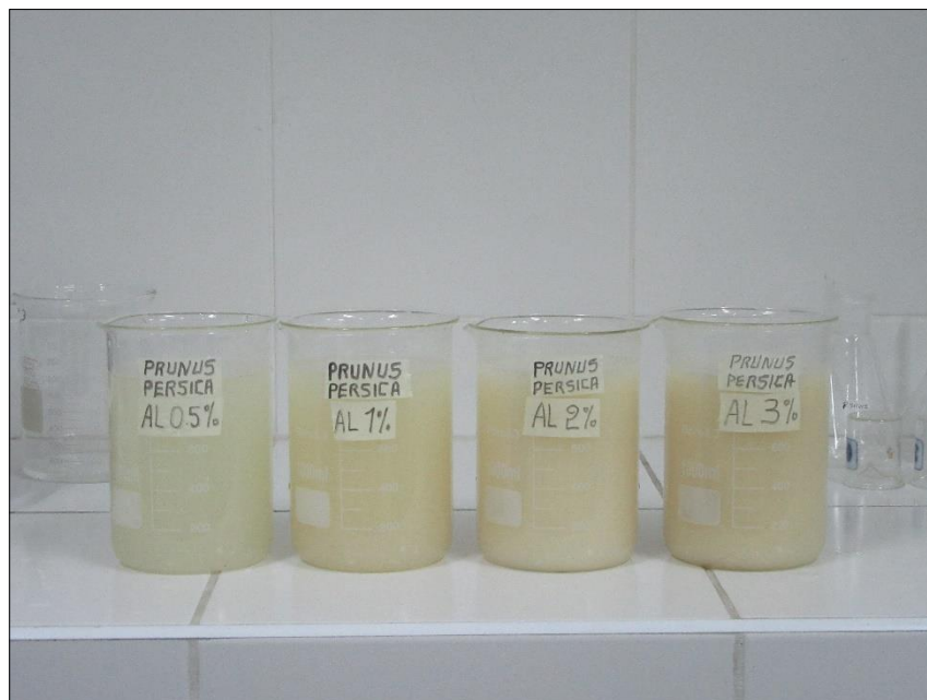
Fotografía N°12: Muestras preparadas de coagulante natural de la Prunus Pérsica a diferentes concentraciones.
