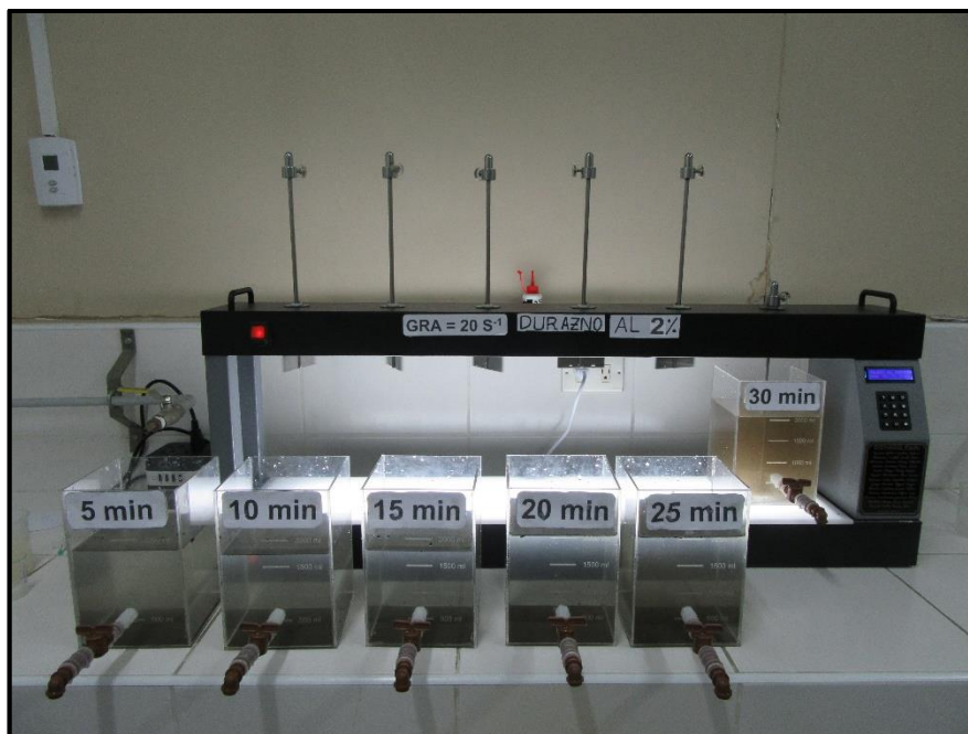
Fotografía N°34 Parámetros de Floculación con la Gradiente de 20 \text{ S}^{-1} a diferentes tiempos de floculación.
