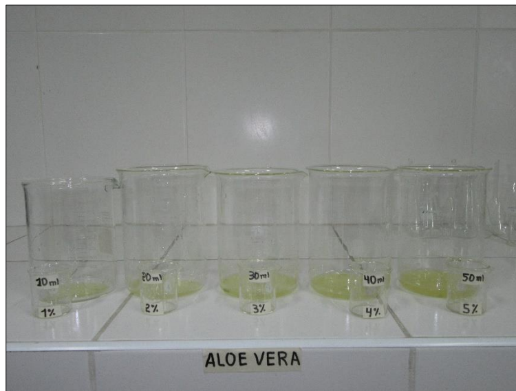
Fotografía N°15: Preparación del coagulante Aloe Vera a distintas concentraciones
