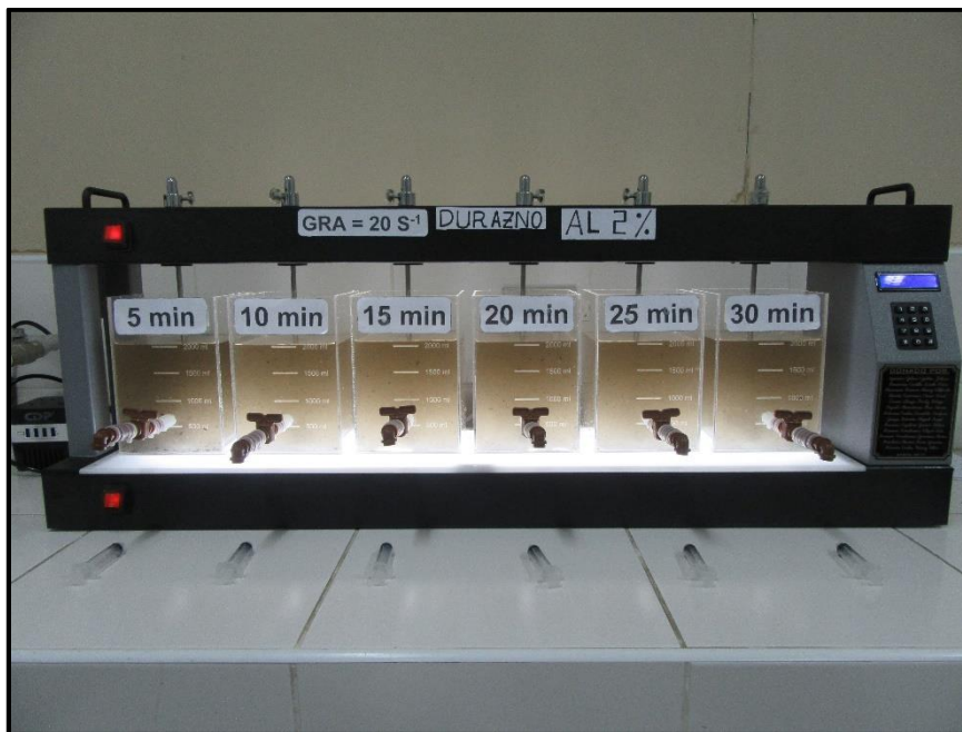
Fotografía N°33 Equipo de Prueba de jarras – Previo a la Determinación de Parámetros de Floculación con la Gradiente de 20 \text{ S}^{-1} y Velocidad de 20 \text{ rpm} .
