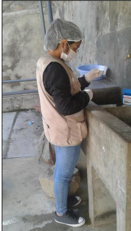
**Fotografía N° 17:** Medición del cloro residual en la vivienda intermedia (cota media)
