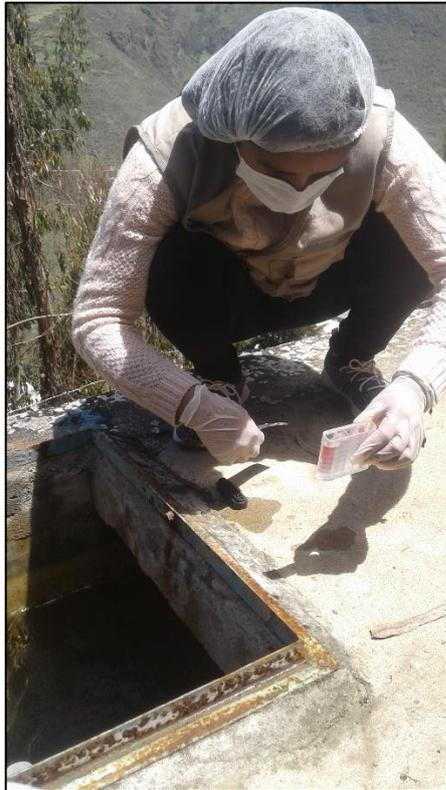
**Fotografía N° 15:** Medición del cloro residual en el reservorio
