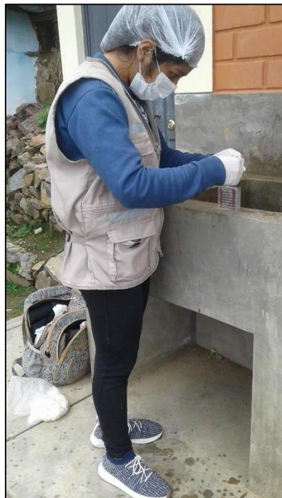
**Fotografía N° 18:** Medición del cloro residual en la vivienda final (cota baja)
