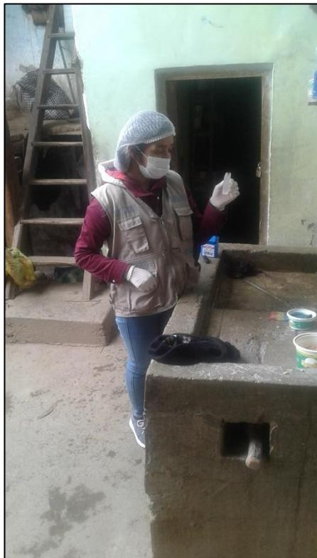
**Fotografía N° 16:** Medición del cloro residual en la vivienda inicial (cota alta)
