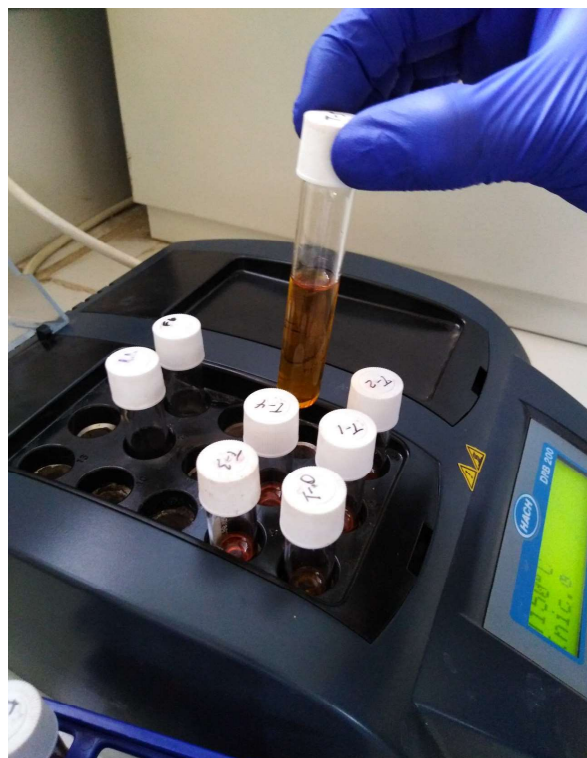
Imagen 20: Lectura de la muestra en el espectrofotómetro a 600 nm
