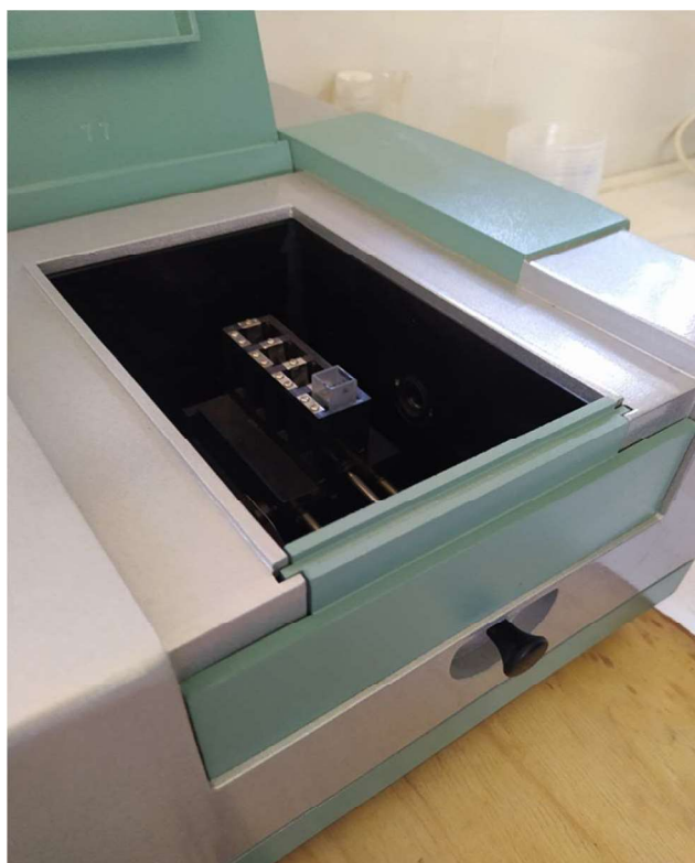
Imagen 20: Lectura de la muestra en el espectrofotómetro a 600 nm
