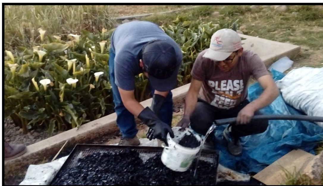
Fotografía N°12: Lavado y tamizado del carbón vegetal.
