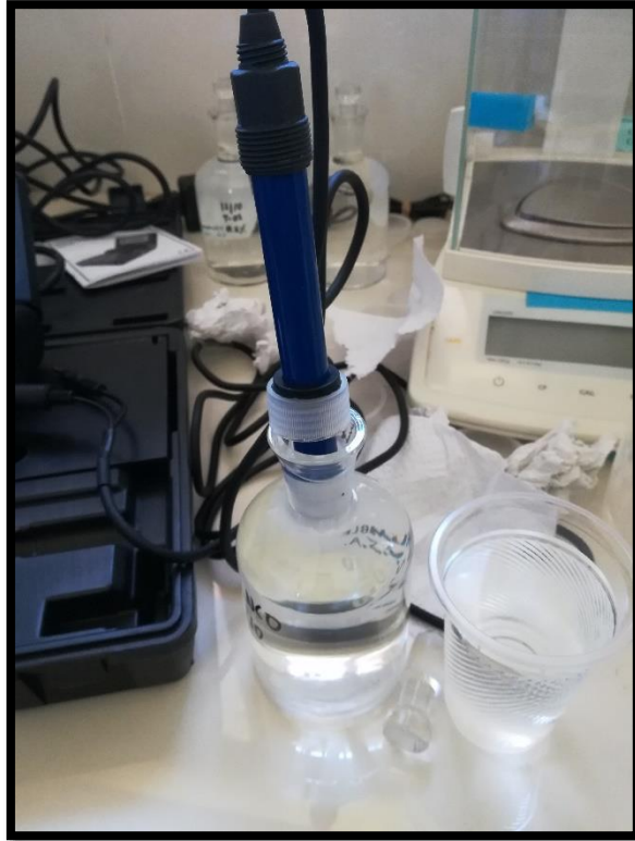
Fotografía N°24: Medición de la DBO en el día cero y en el día 5.
