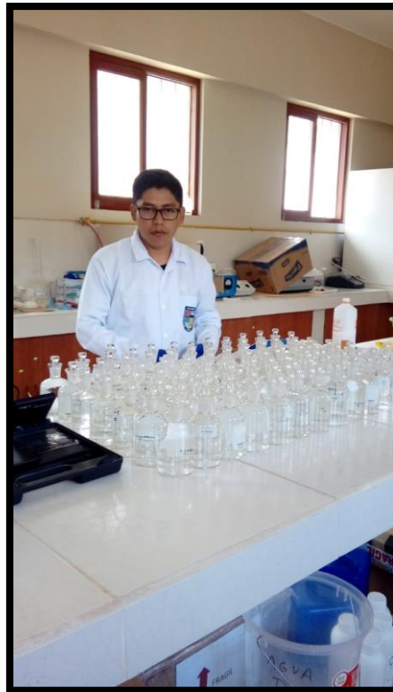
Fotografía N°24: Medición de la DBO en el día cero y en el día 5.
