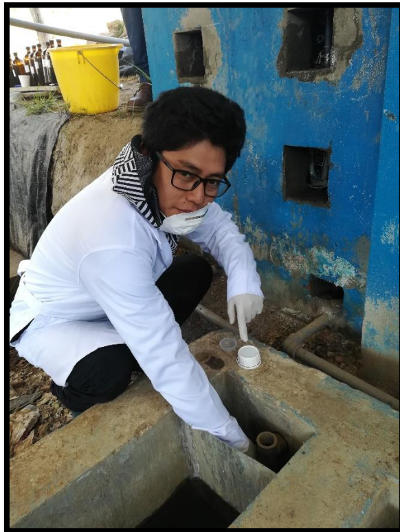
Fotografía N°21: Toma de muestra en las entradas y salidas del filtro para ser analizadas.
