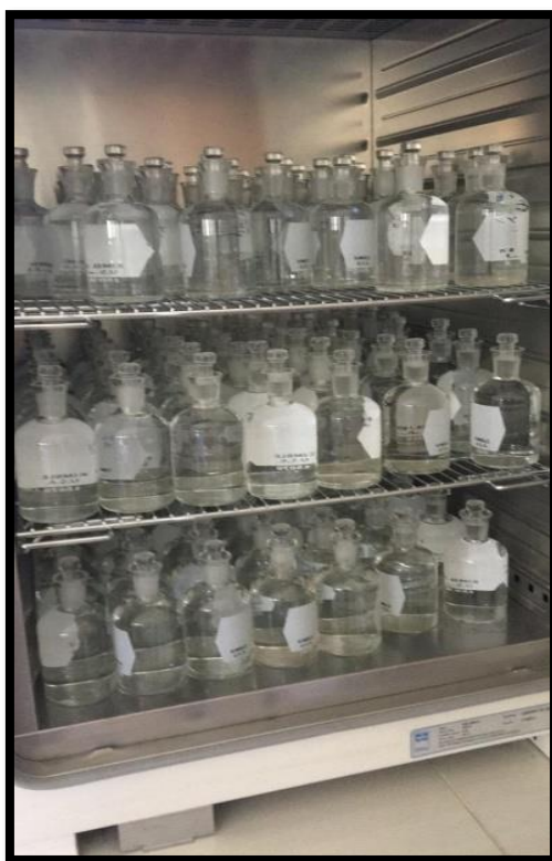
Fotografía N°26: Ingreso de las botellas Winkler a la incubadora por 5 días.
