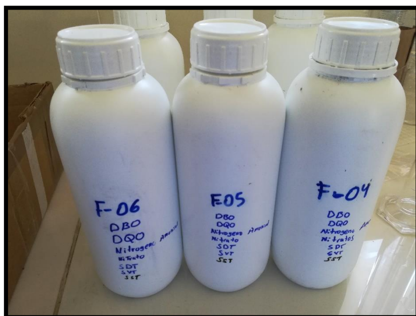
Fotografía N°23: Rotulado de muestras de los demás filtros con los parámetros a ser analizado.
