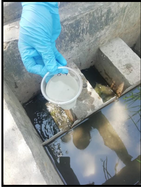
Fotografía N°20: Medición del caudal de ingreso al sistema de tratamiento y en los filtros percoladores.
