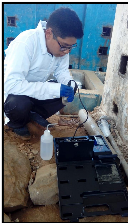
Fotografía N°18: Medición de la conductividad y temperatura semanalmente en campo.
