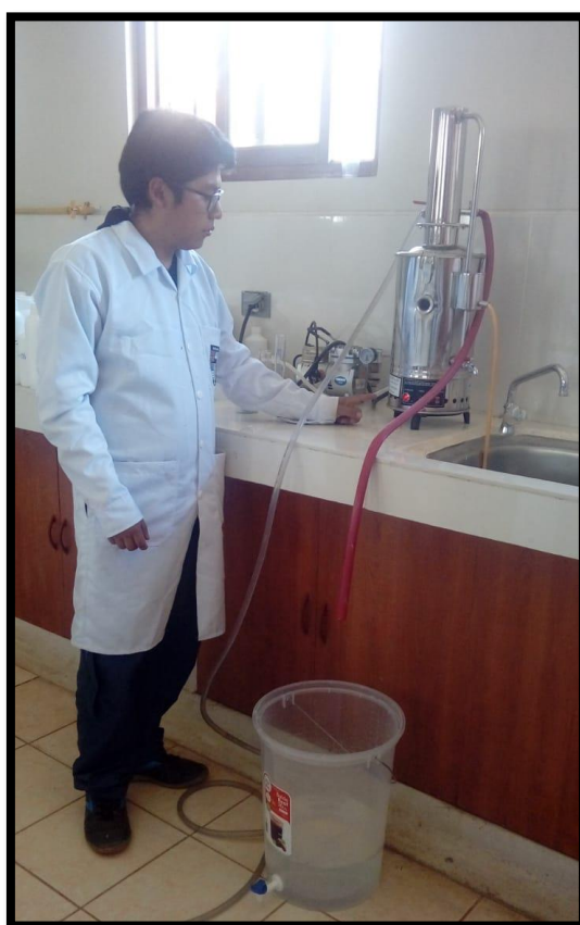
Fotografía N°18: Destilación de agua para determinar la DBO.
