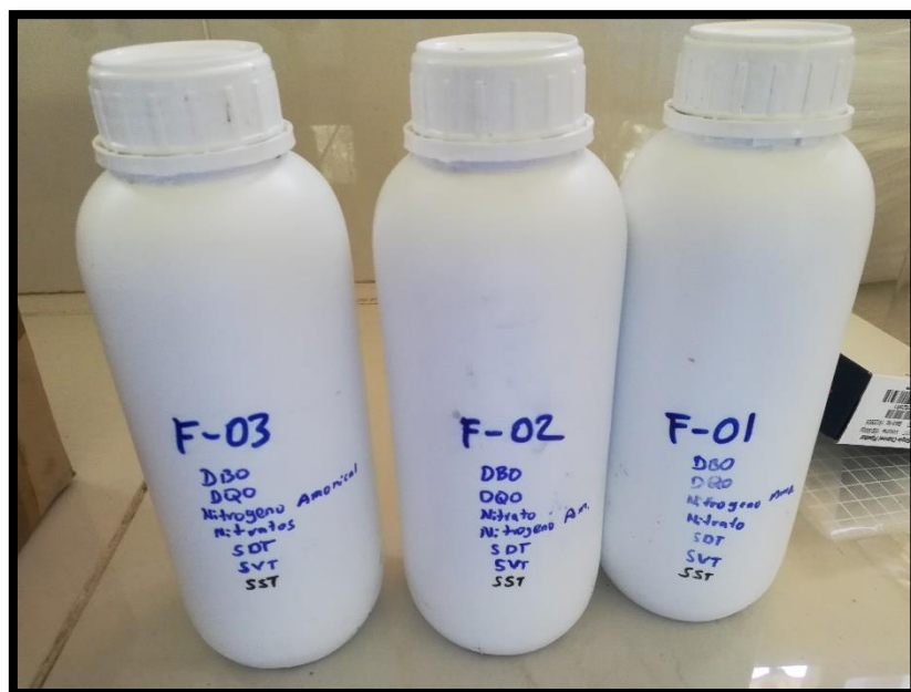
Fotografía N°22: Rotulado de muestras de los tres primeros filtros con los parámetros a ser analizado.
