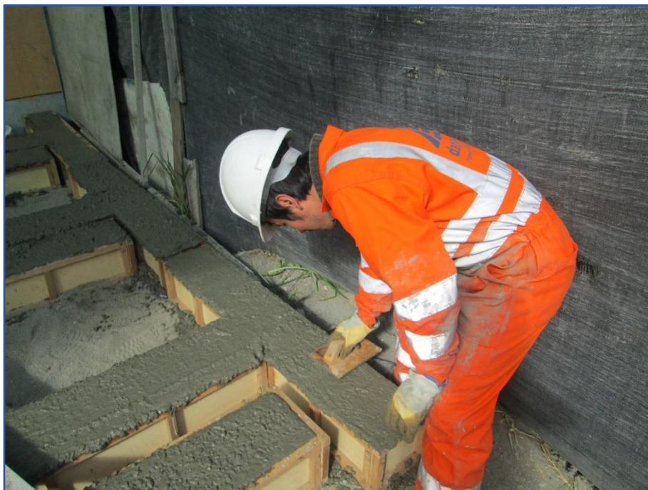
Figura 117: Primer acabado de la superficie externa de los especímenes (regleado y frotchado). Fuente: Elaboración propia.
