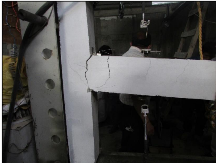
Figura 152: Prueba de Carga del Espécimen N° 02. Fuente: Elaboración propia.
