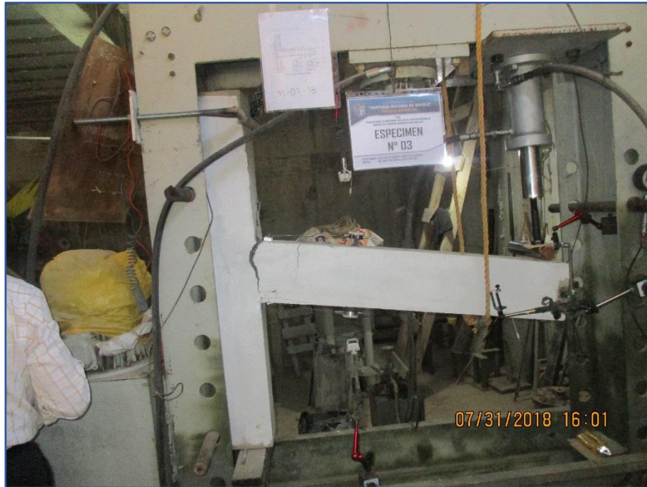
Figura 124: Vista frontal del ensayo del espécimen N° 03 Sección crítica formada en la cara de la columna. Fuente: Elaboración propia.
