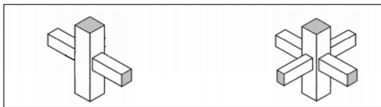
Figura 3: Nudos Interiores a) En pórticos unidireccionales b) En pórticos bidireccionales. Fuente: ACI 352 R-02, p. 21).
