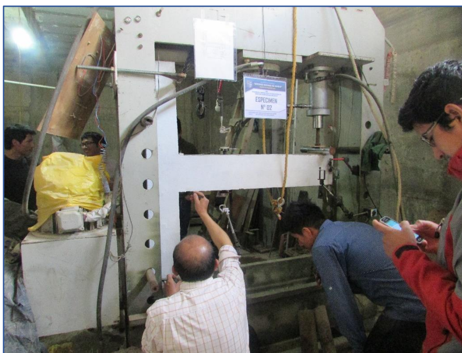
Figura 122: Montaje de especímenes e instalación de equipos de medida para la prueba de carga. Fuente: Elaboración propia.
