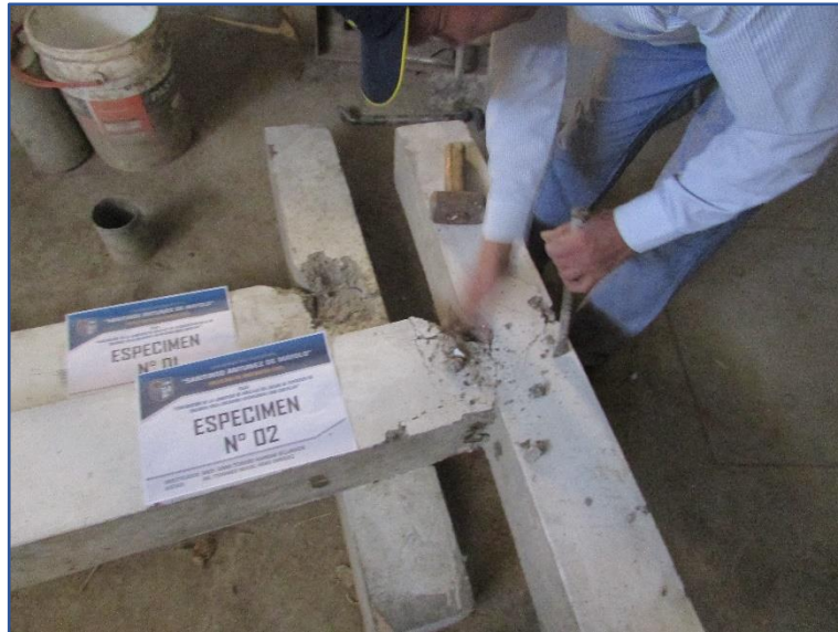
Figura 128: Inspección del acero de refuerzo en los nudos de los especímenes N° 01 y N°02. Fuente: Elaboración propia.
