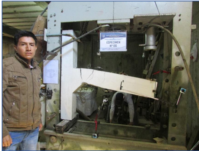
Figura 126: Vista general del ensayo del espécimen N° 06 Sección crítica formada al final de la cartela. Fuente: Elaboración propia.
