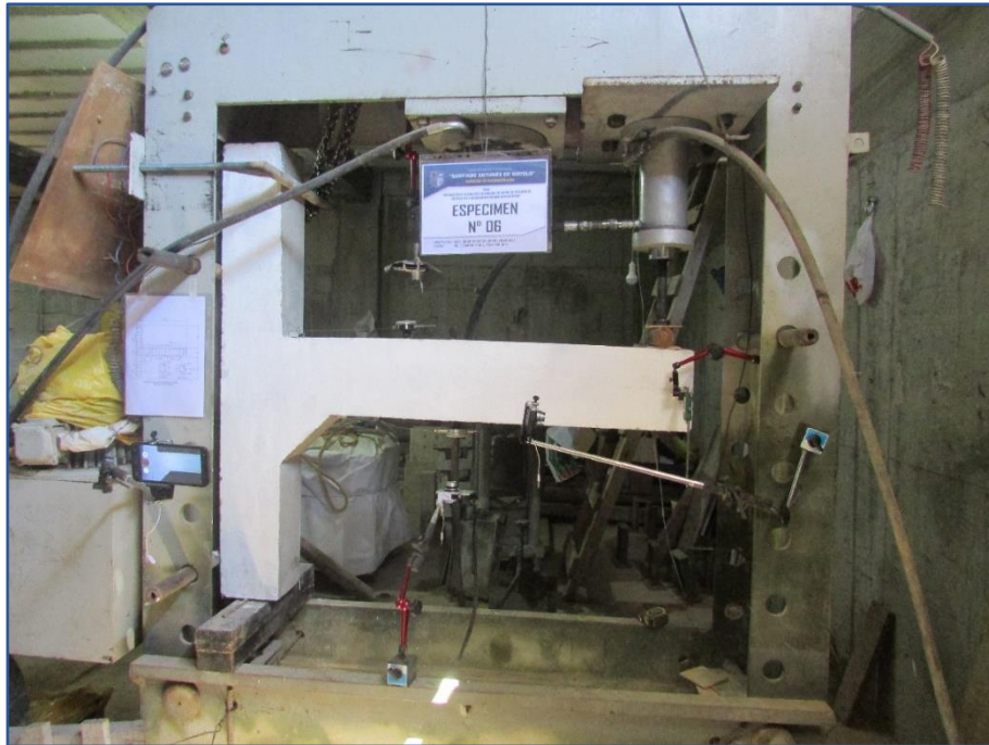
Figura 123: Instalación de cámaras fotográficas para el registro de las lecturas en la prueba de carga. Fuente: Elaboración propia.
