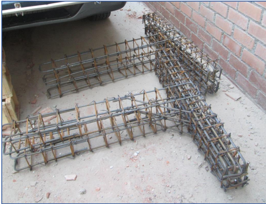
Figura 99: Armadura de acero del espécimen. Fuente: Elaboración propia
