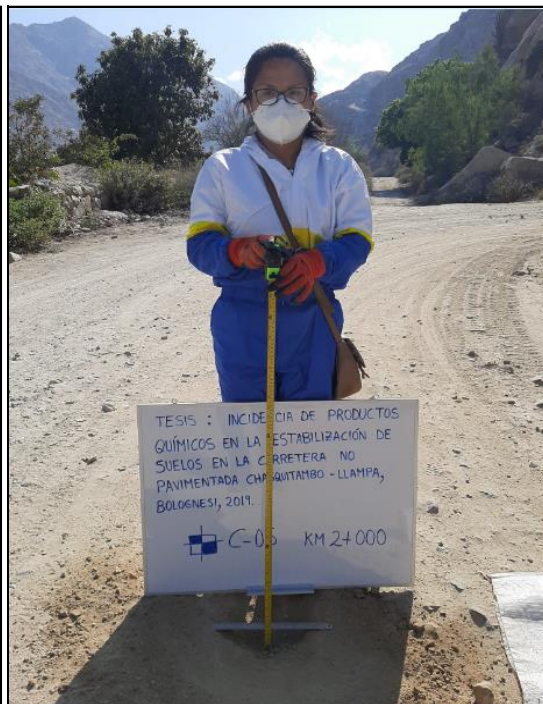
Verificación del espesor de afirmado existente de 0.05m, en la progresiva: Km 02+000.
