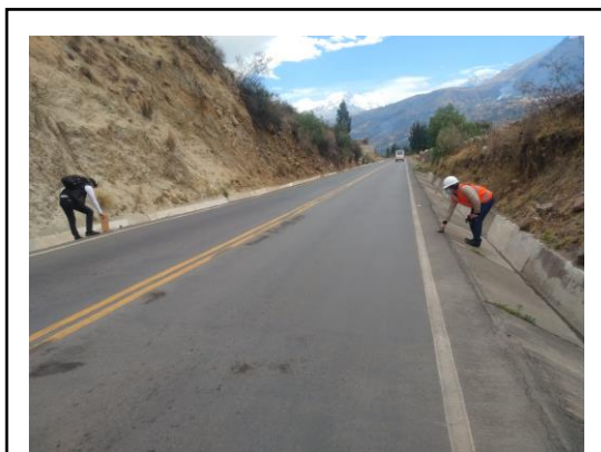
Foto 03: Medición del ancho de la pavimentación cada 100 m
