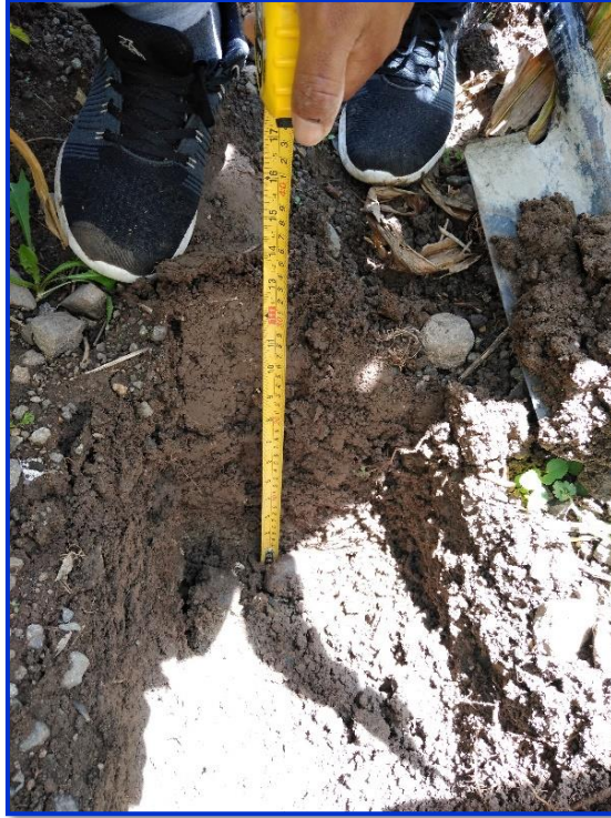
Fotografía N° 07: Medición de la profundidad de muestreo.
