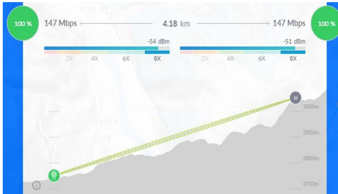
Figura 22: Propiedades de la conexión entre la antena transmisora y antena repetidora
