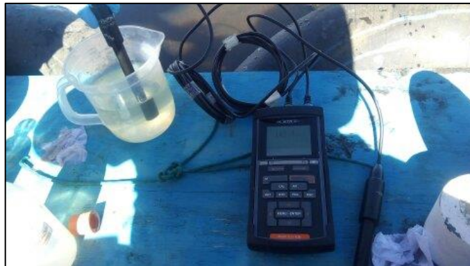
Figura 10. Imagen de la medición de conductividad eléctrica
