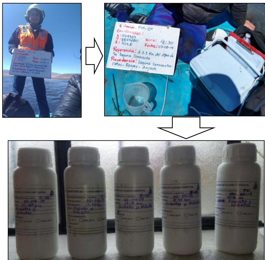
Figura 14. Imagen del muestreo para fósforo total y nitrato
