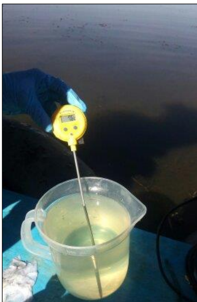
Figura 12. Imagen de la medición de temperatura del agua
