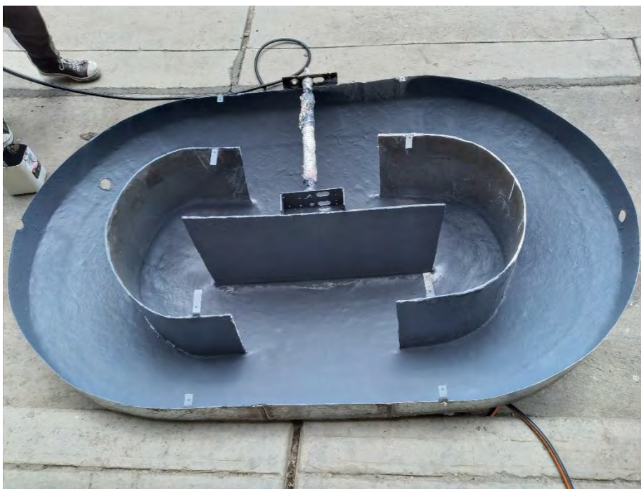
Fotografía 17. Pintado con esmalte epóxica de color gris
