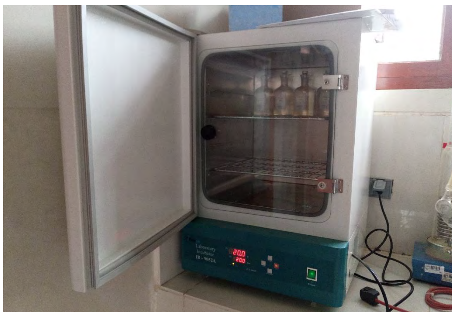
Fotografía 122. Incubación de las muestras a 20°C
