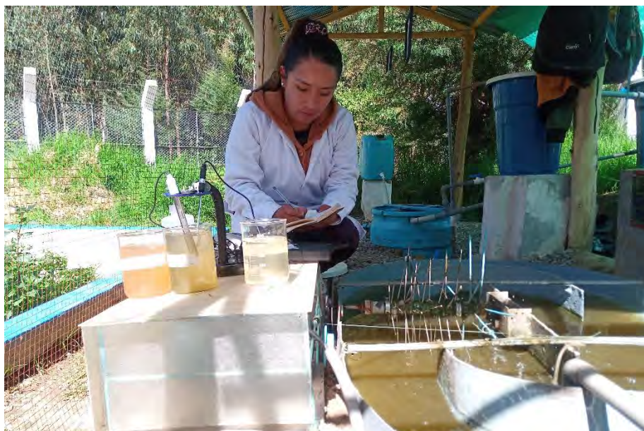
Fotografía 77. Registro de datos de los parámetros de campo en el reactor
