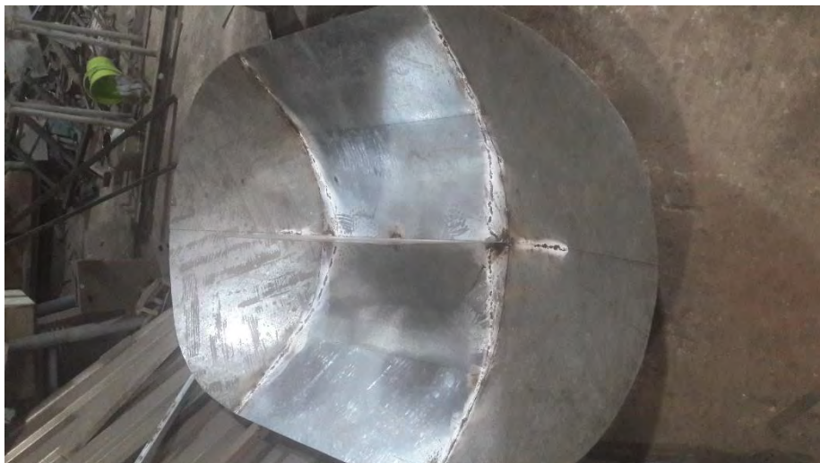
Fotografía 6. Base cilíndrica de acero inoxidable de 2 mm
