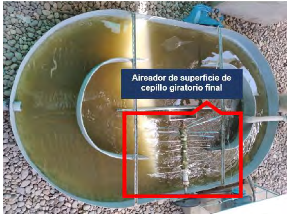
Imagen 24. Configuración de las paletas final
