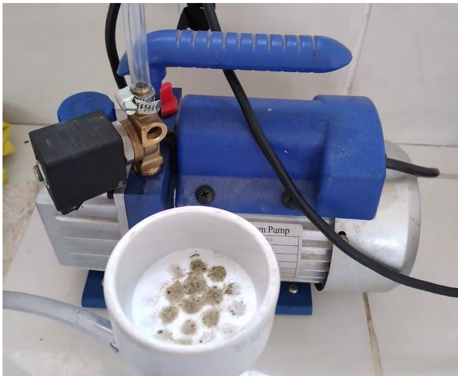
Fotografía 133. Filtración del lodo activado con la bomba de vacío
