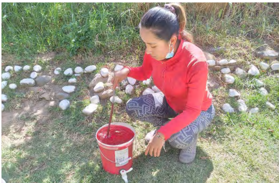
Fotografía 73. Preparación del trazador a inyectar
