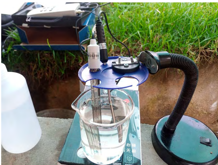
Fotografía 97. Medición de temperatura en la salida
