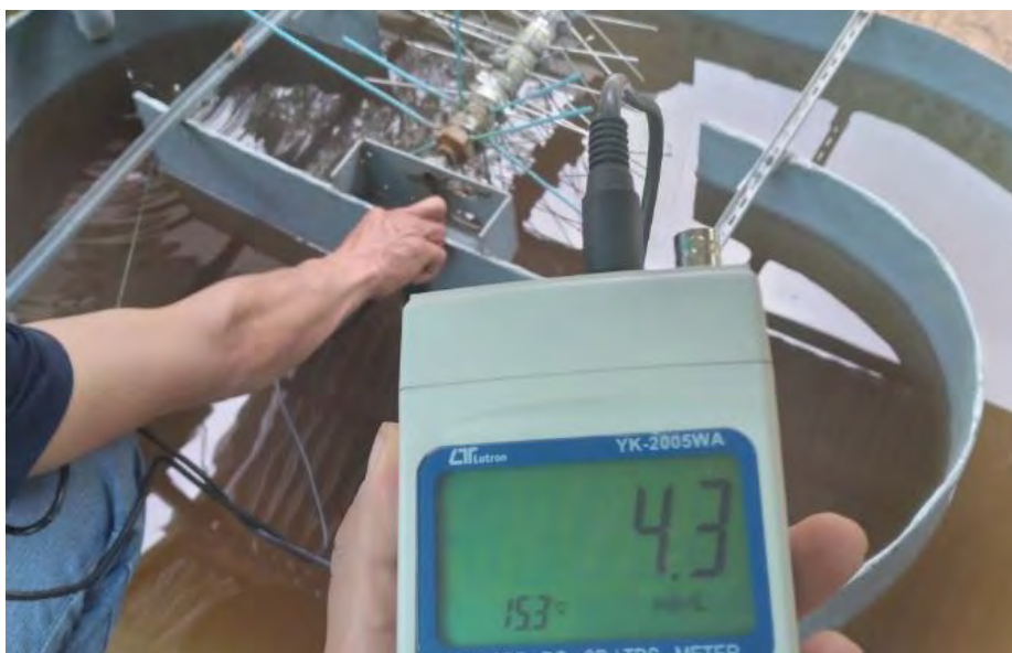
Fotografía 106. Medición del OD en la zona 2
