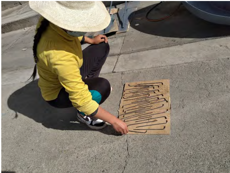
Fotografía 15. Paletas de la primera configuración del aireador
