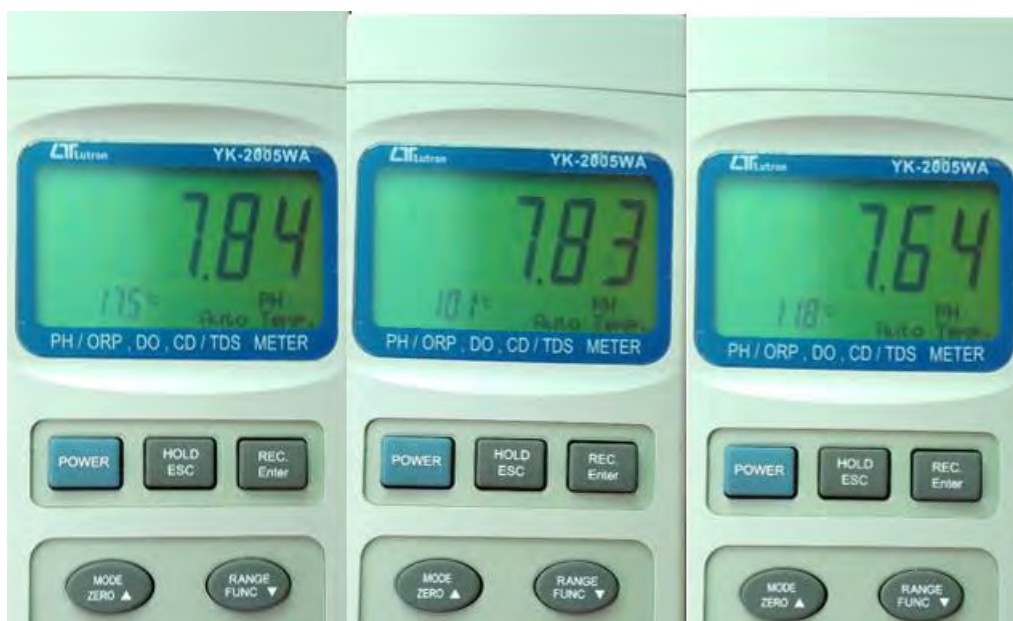
Fotografía 99. Reporte de pH, T° en la entrada, reactor y salida en la semana 14
