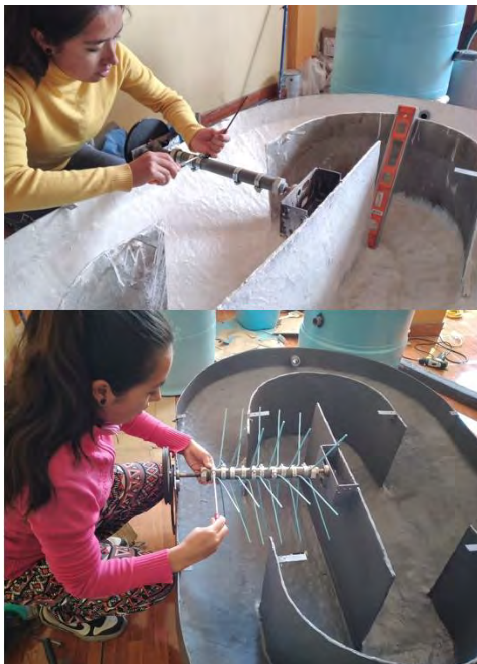
Imagen 8. Ensamblaje del aireador de superficie de cepillo giratorio
