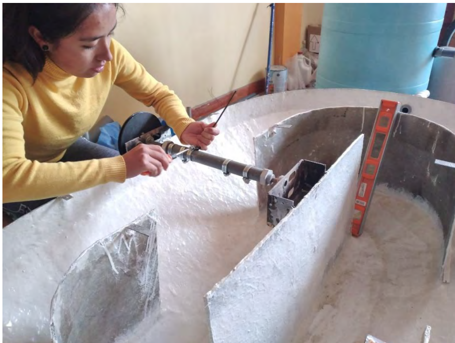
Fotografía 16. Adecuación de las paletas
