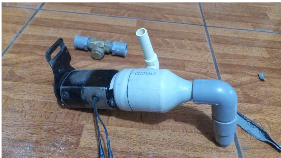
Fotografía 164. Equipo para la extracción de lodos viejos
