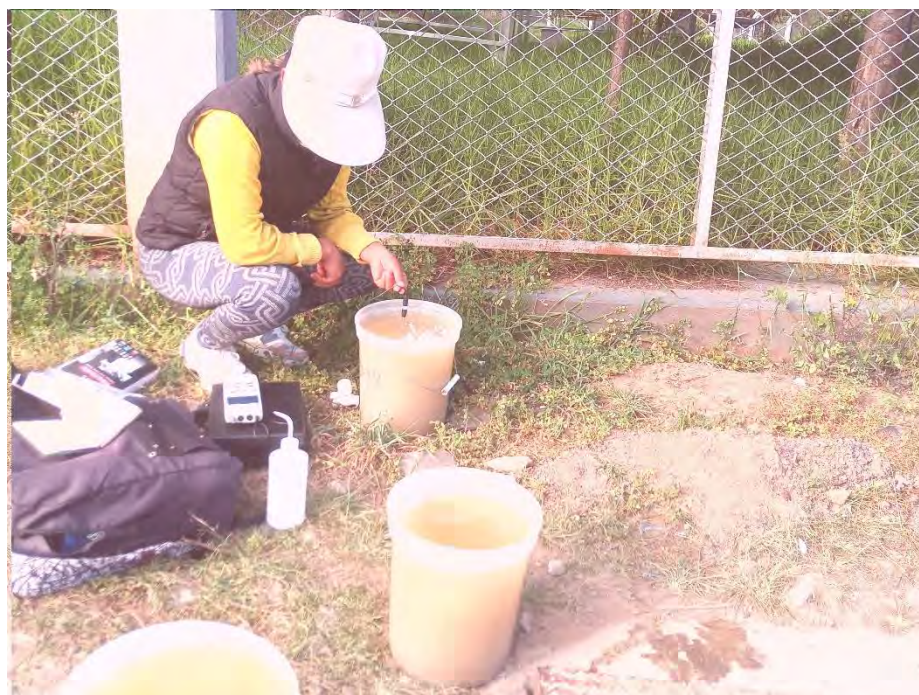
Fotografía 159. Monitoreo de pH y T° en el colector
