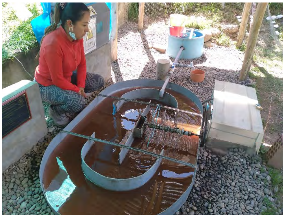
Fotografía 74. Mezcla completa del trazador en la zanja
