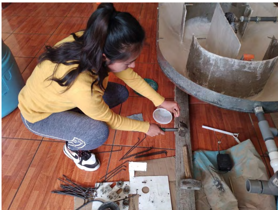
Fotografía 14. Forma de las paletas del aireador
