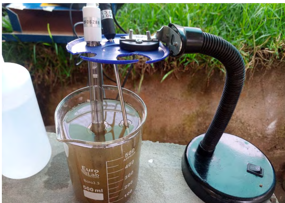
Fotografía 96. Medición de temperatura en el zanjón
