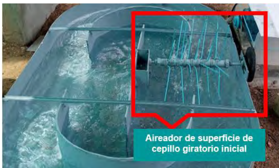
Imagen 23. Configuración de las paletas inicial
