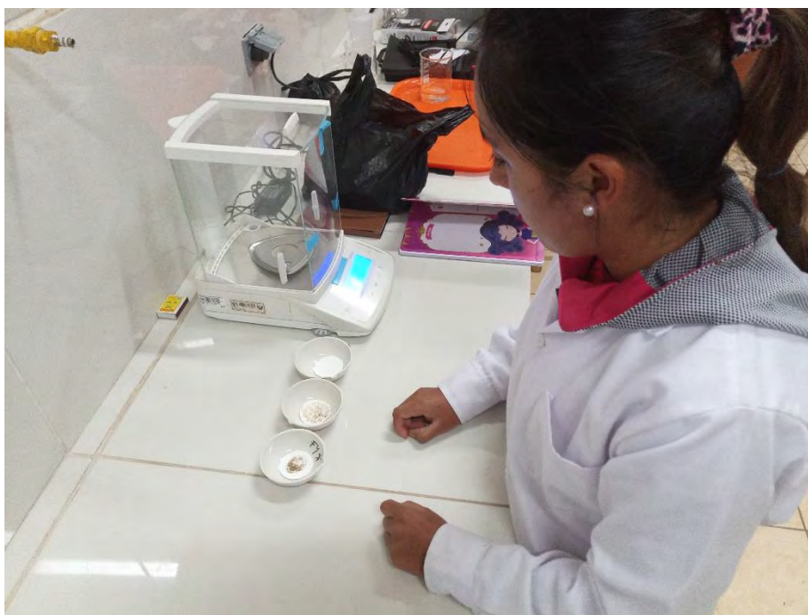
Fotografía 140. Pesado de los SST en la entrada, Zanja de Oxidación y salida
