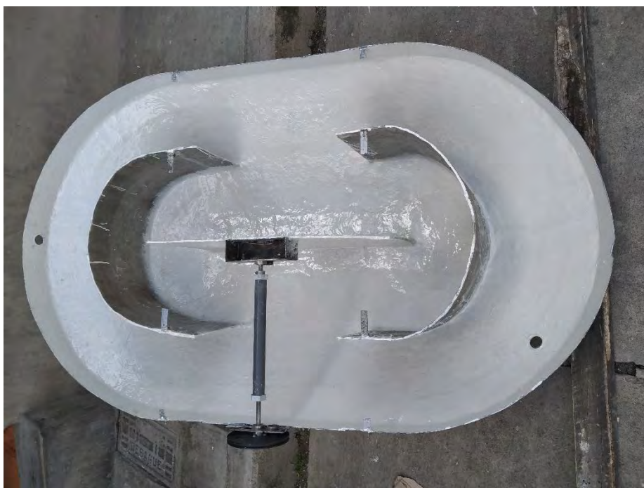
Fotografía 12. Acabo final con fibra de vidrio y resina de la estructura
