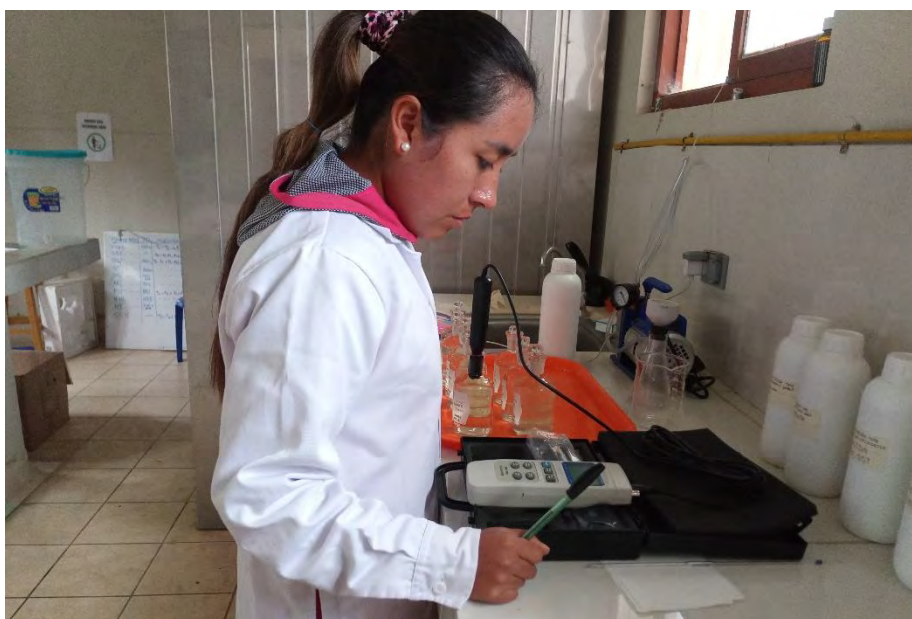
Fotografía 124. Medición de la DBO en el día 5
