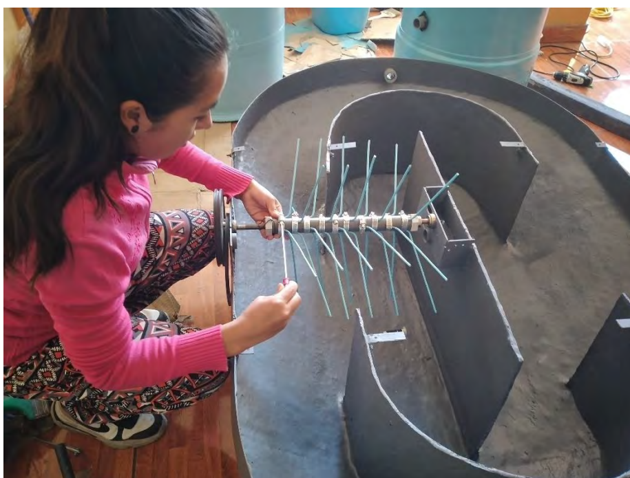
Fotografía 20. Adecuación de las paletas al medio de soporte
