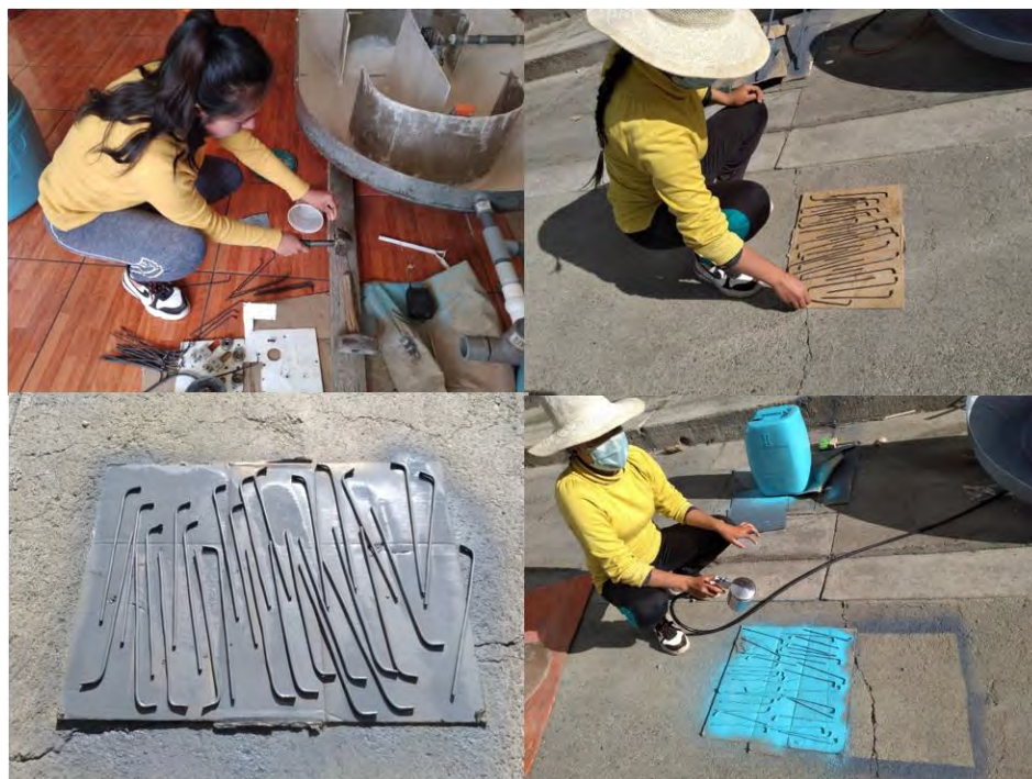
Imagen 6. Construcción y pintado del aireador de superficie de cepillo giratorio
