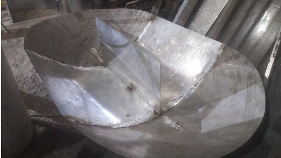
Fotografía 7. Pantalla vertical de acero inoxidable de 2 mm
