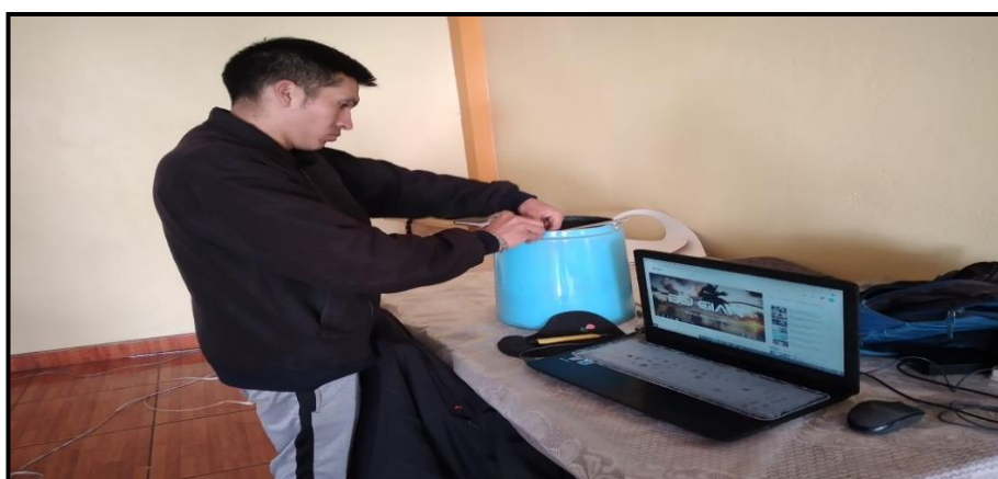
Fotografía 3. Construcción de la cámara de difusión del decantador circular tipo troncocónico doble.
