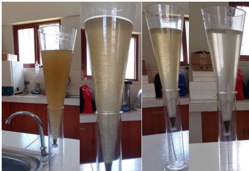
Fotografía 74. En la parte izquierda es al agua residual que ingresa al decantador circular tipo troncocónico doble y en la parte derecha es la extracción de lodos presentes en la parte cónica del decantador circular.
