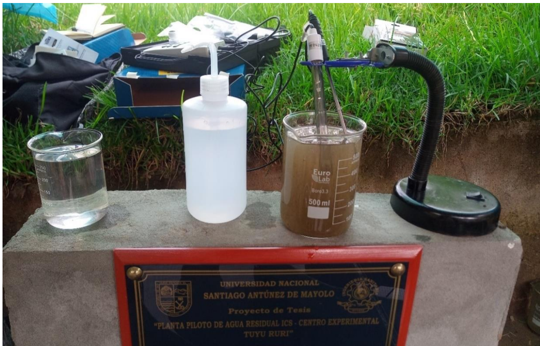
Fotografía 59. Determinación de pH y temperatura del afluente al decantador circular tipo troncocónico doble.
