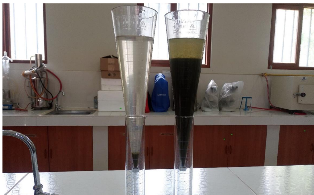
Fotografía 74. En la parte izquierda es al agua residual que ingresa al decantador circular tipo troncocónico doble y en la parte derecha es la extracción de lodos presentes en la parte cónica del decantador circular.
