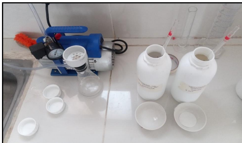
Fotografía 27. Determinación de sólidos suspendidos totales del afluente y efluente del decantador.
