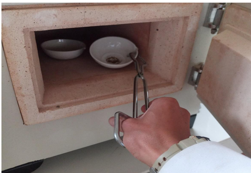
Fotografía 68. Utilización de mufla en la determinación de sólidos suspendidos totales.
