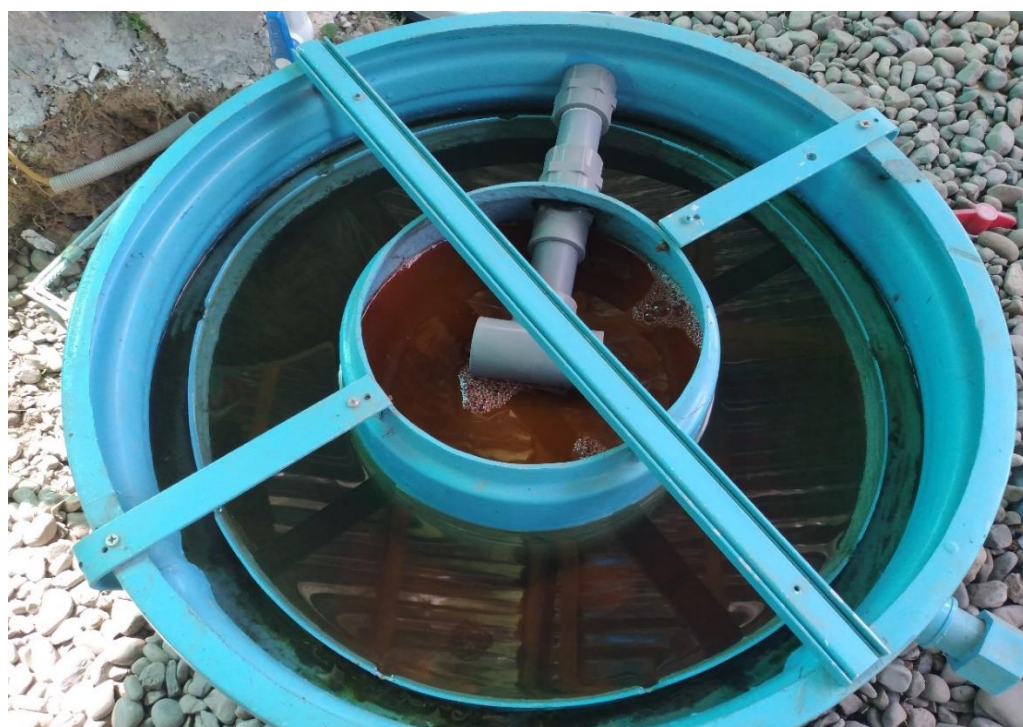
Fotografía 78. Dispersión del trazador en el decantador circular tipo troncocónico doble.
