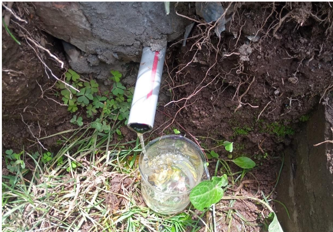
Fotografía 61. Determinación de pH y Temperatura del efluente del decantador circular tipo troncocónico doble.
