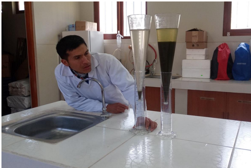
Fotografía 76. Toma de muestra para la determinación de la turbiedad al ingreso y salida del decantador circular tipo troncocónico doble en la cuarta semana de monitoreo.
