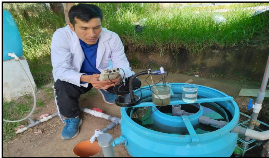
Fotografía 25. Monitoreo de la temperatura y pH en el decantador circular tipo troncocónico doble.
