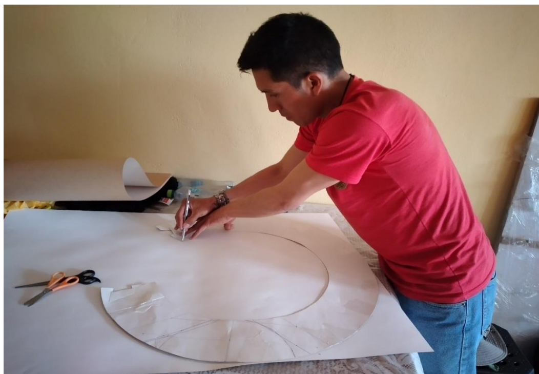
Fotografía 36. Diseño de la falda superior de la campana de difusión del decantador circular tipo troncocónico doble.
