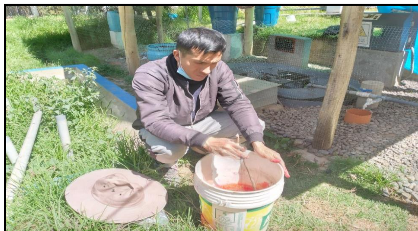
Fotografía 26. Realización de trazadores, para la determinación de tiempo de retención hidráulica.
