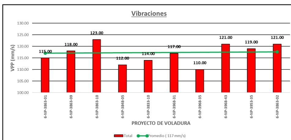
**Figura 24:** Niveles de vibraciones. Tomado del área de Asistencia técnica Enaex, 2019.
