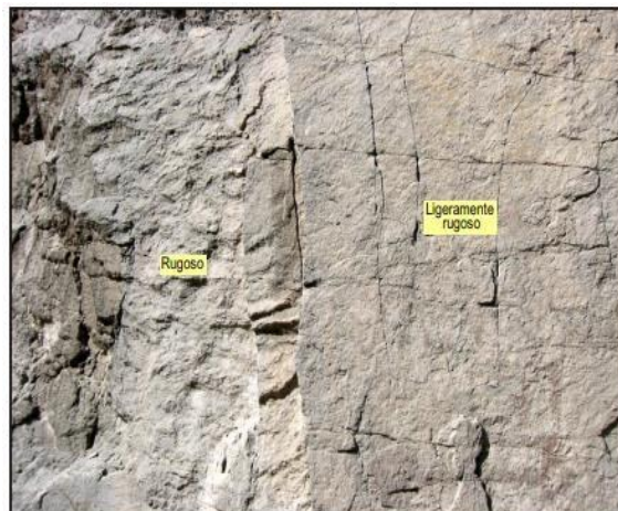
FIGURA N° 06: RUGOSIDAD DE UNA DISCONTINUIDAD
