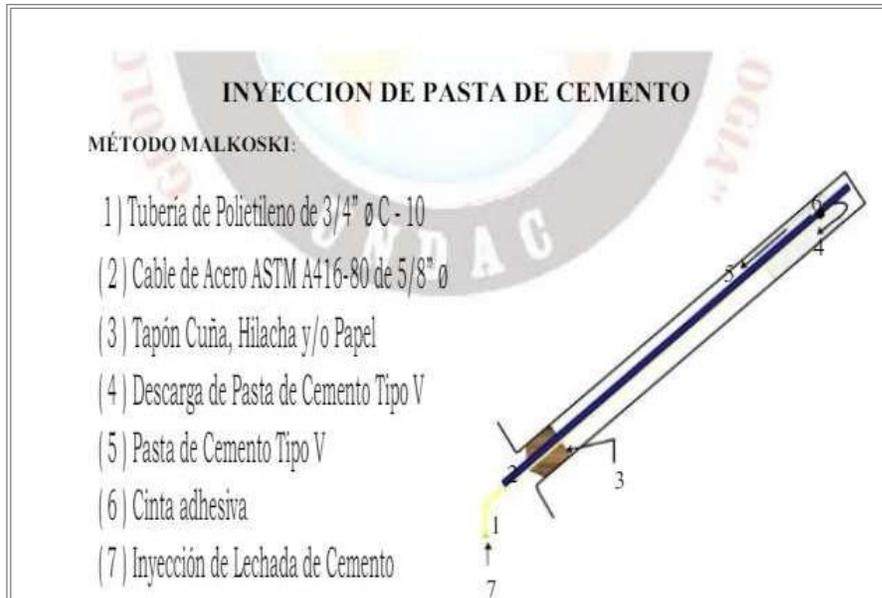
FIGURA N°06 Método de inyección Malkoski
