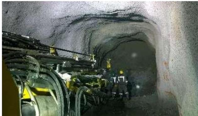
FIGURA N°04: JRC Ingeniería y Construcción SAC-Equipo perforación Atlas Copco Boomer S1D (04).
