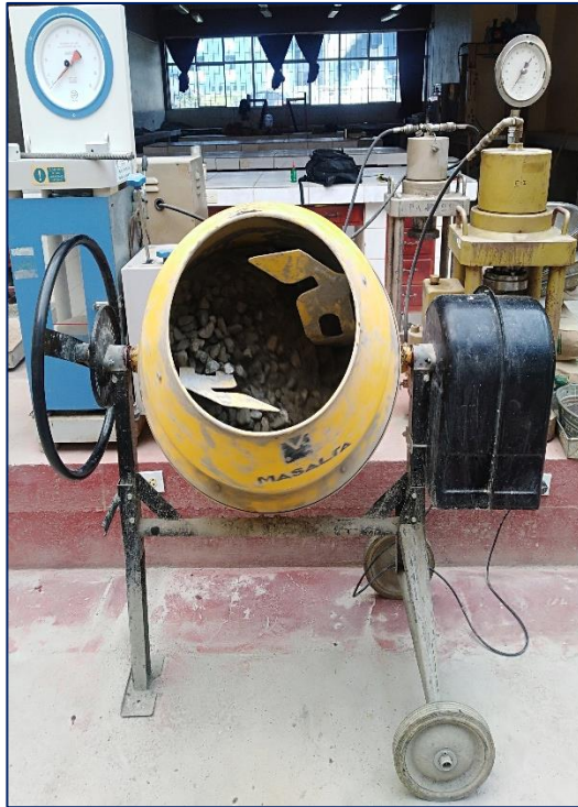
Se mezcla el concreto durante 3 min seguido por 3 min de reposo y luego 2 min finales de mezclado.
