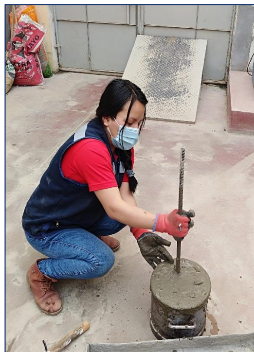
Para la consolidación por varillado, se llena el recipiente en 3 capas, apisonando cada capa con 25 golpes
