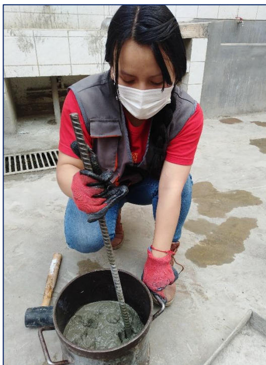
Se coloca el recipiente en una superficie plana, nivelada y firme y se coloca el concreto en el recipiente de medición.
