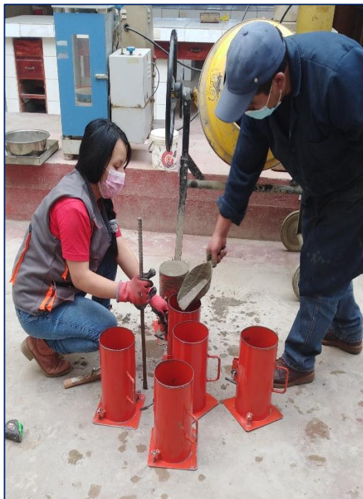
Se coloca el concreto en los moldes, utilizando un cucharón y distribuyendo simétricamente, evitando la segregación.
