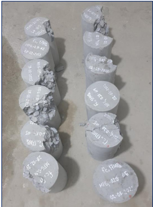
Se muestran los especímenes de concreto luego de ser ensayados y sometidos hasta la rotura.
