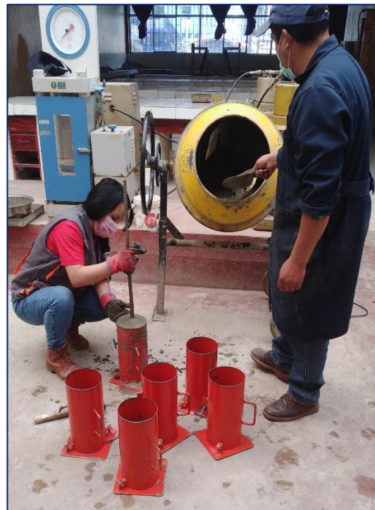
Para especímenes cilíndricos de 6" de diámetro, se usa el método del varillado y compactar el concreto en tres capas.
