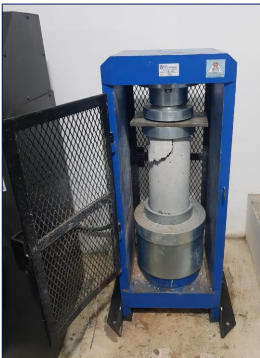
Los especímenes de concreto para la edad de 28 días fueron ensayados dentro de la tolerancia permisible de \pm 20 h.
