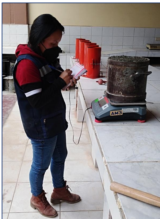
Se humedece el recipiente de medida y se determina la masa del recipiente vacío.
