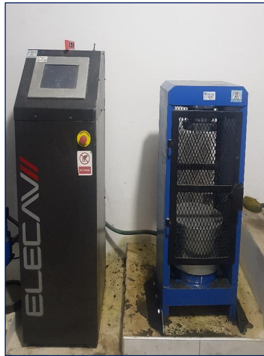
Se muestra la Máquina de ensayo de resistencia, calibrada y cumpliendo los requisitos de la NTP 339.034.
