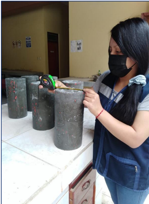
Se retiran los especímenes de las pozas de curado, luego son pesados y, se mide el diámetro y la altura.
