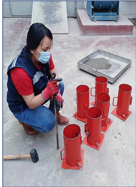
Se coloca los moldes de los especímenes en una superficie rígida libre de vibraciones o en el piso.
