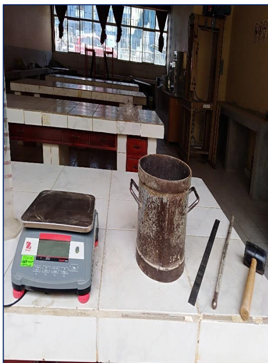
Se selecciona el apisonado como método de consolidación, debido a que el asentamiento es de 25 a 75 mm.
