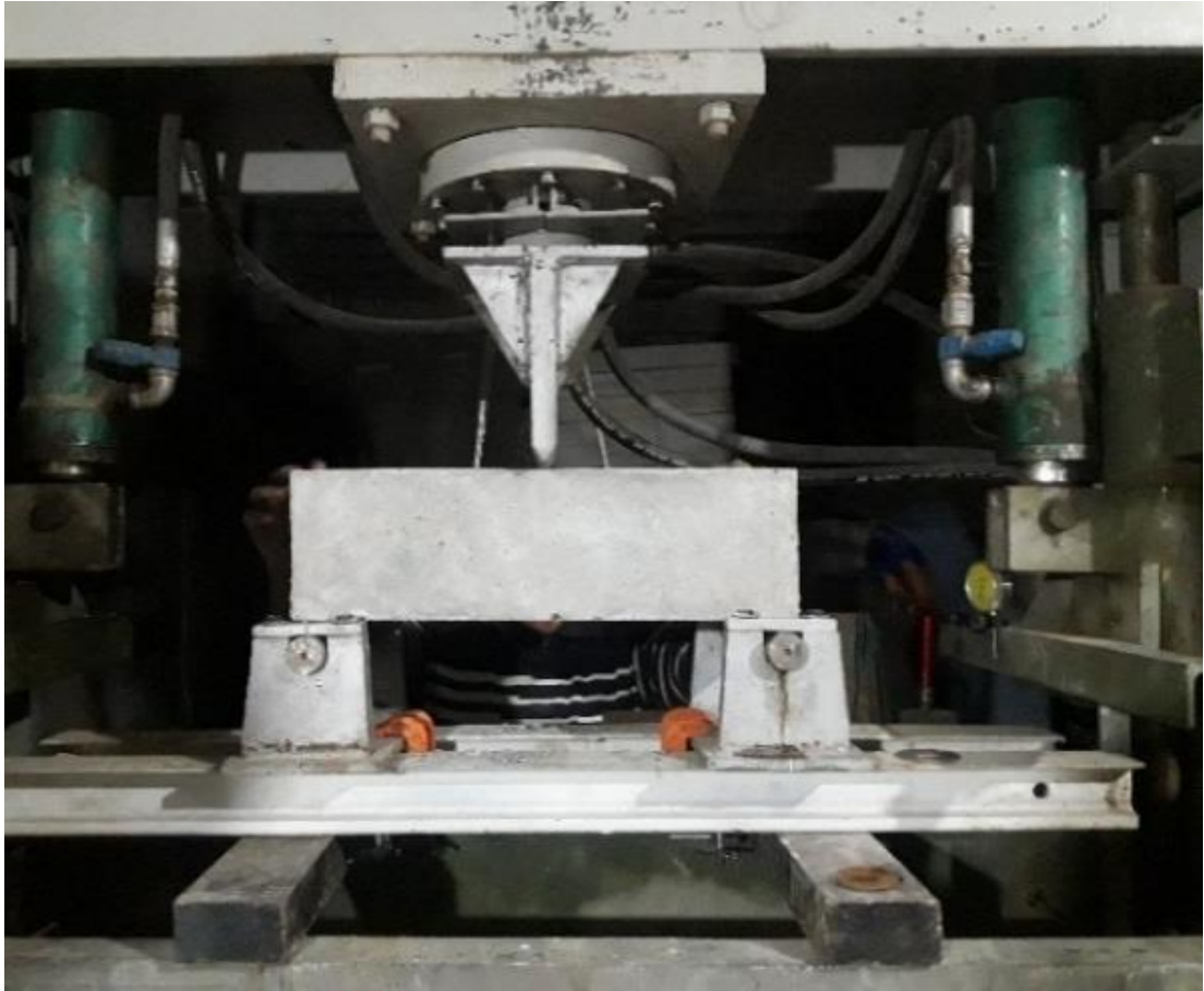
Fotografía N° 19. Rotura de probetas prismáticas con refuerzo de 0.75% de fibra reciclable
