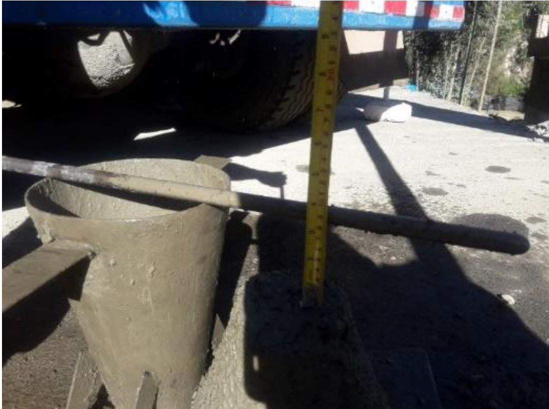
Fotografía N° 3. Ensayo de asentamiento (Slump), concreto sin fibra
