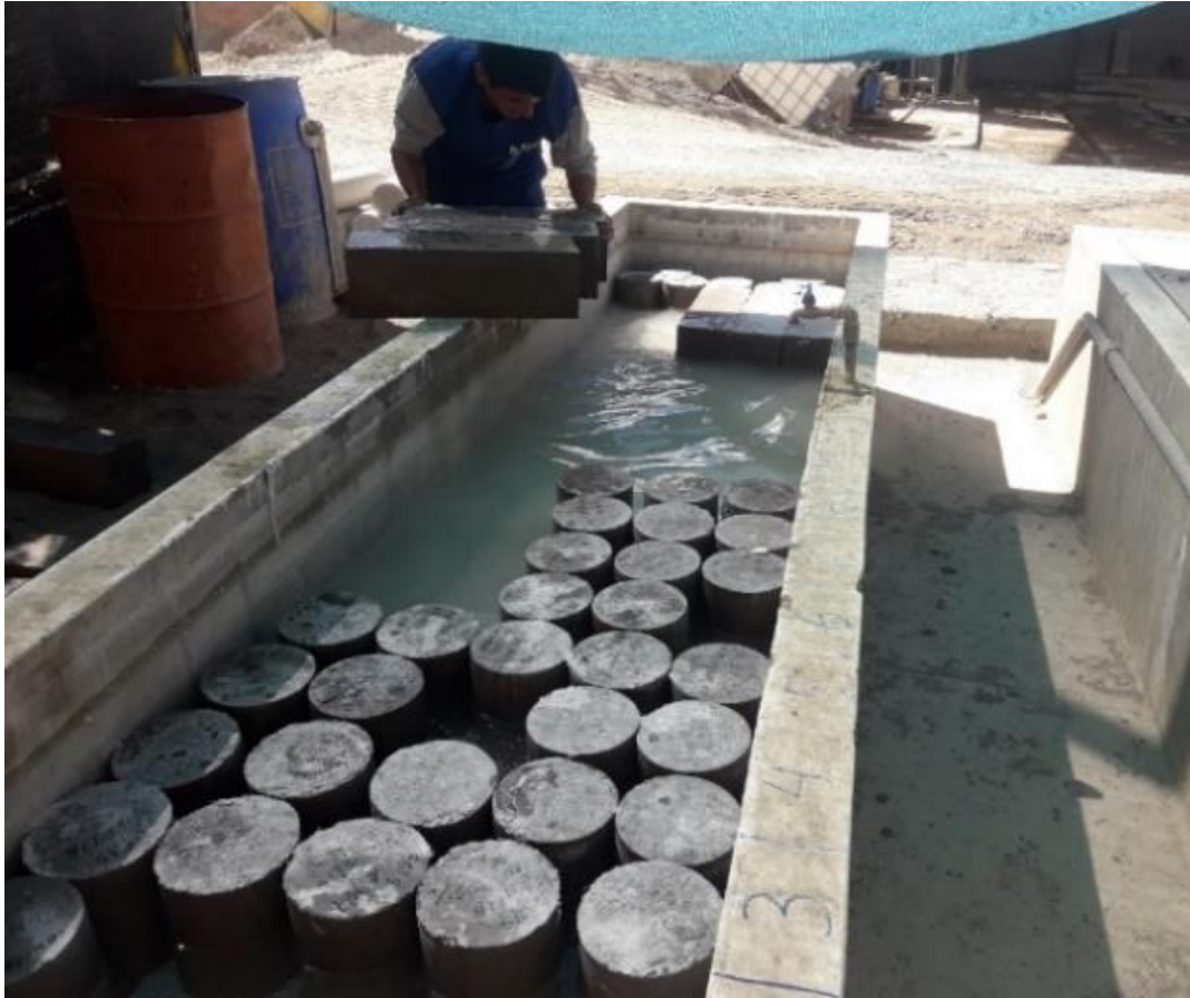
Fotografía N° 9. Curado de probetas cilíndricas
