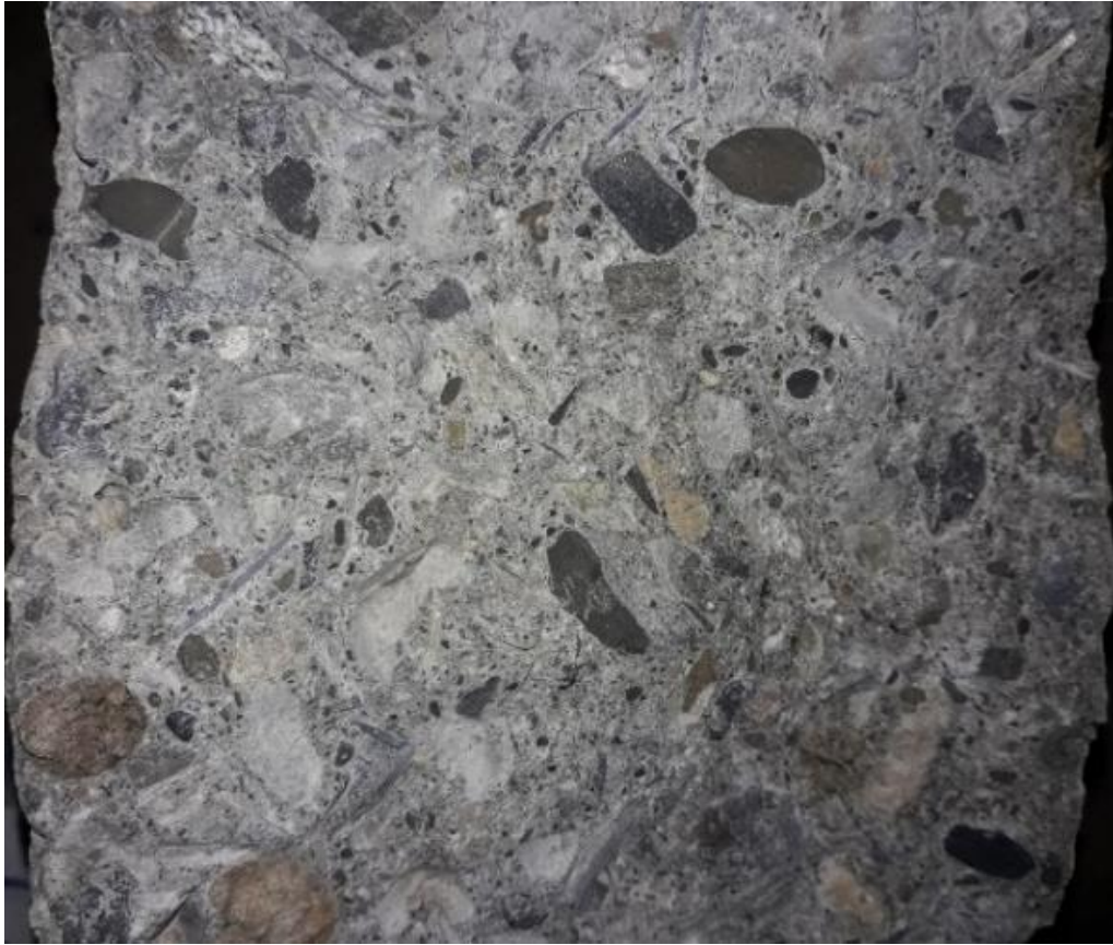
Fotografía N° 21. Sección de probeta prismática sin refuerzo
