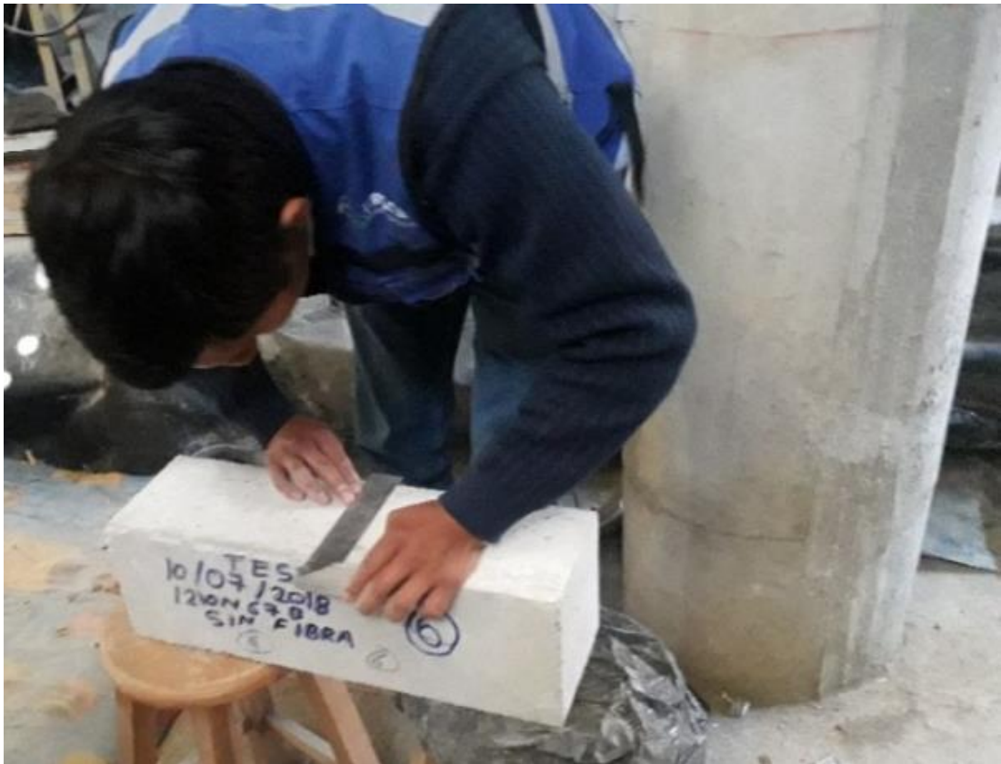
Fotografía N° 13. Registro de probetas prismáticas
