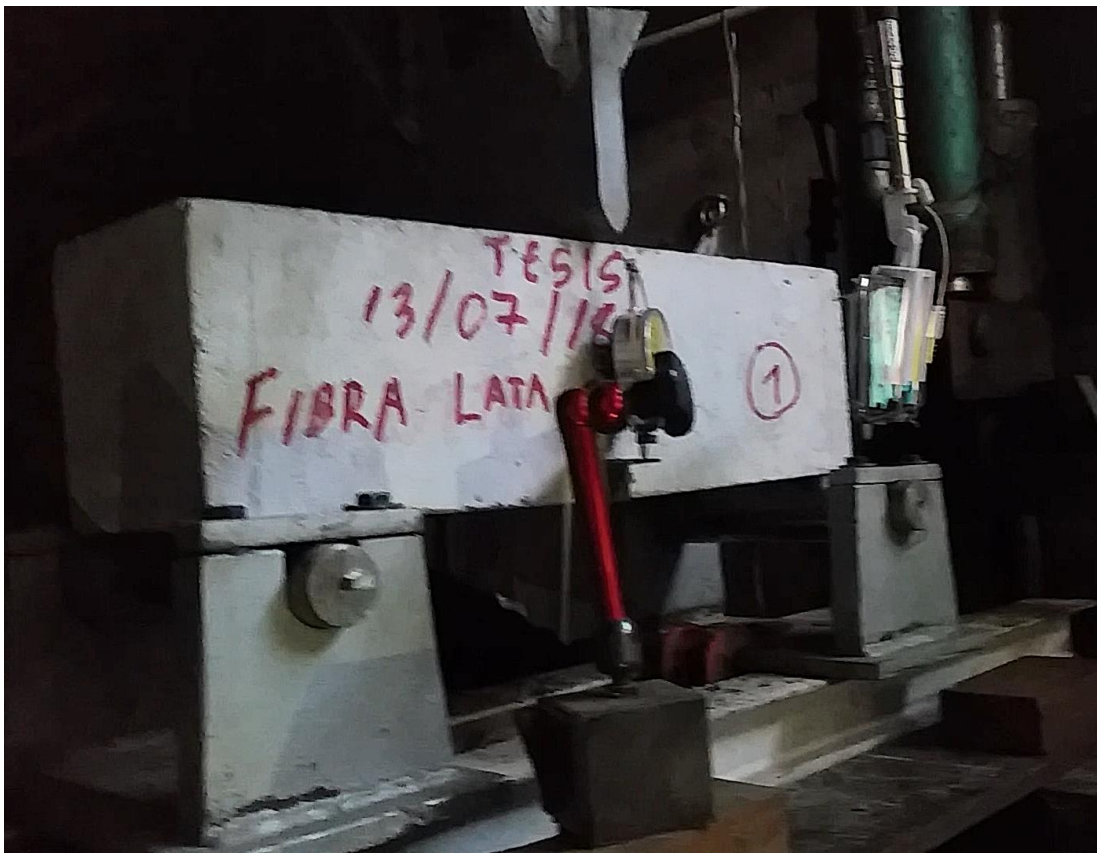
Fotografía N° 18. Rotura de probetas prismáticas con refuerzo de 0.50% de fibra reciclable
