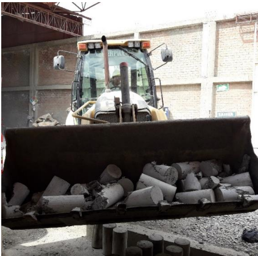
Fotografía N° 32. Eliminación de probetas cilíndricas después de ensayo
