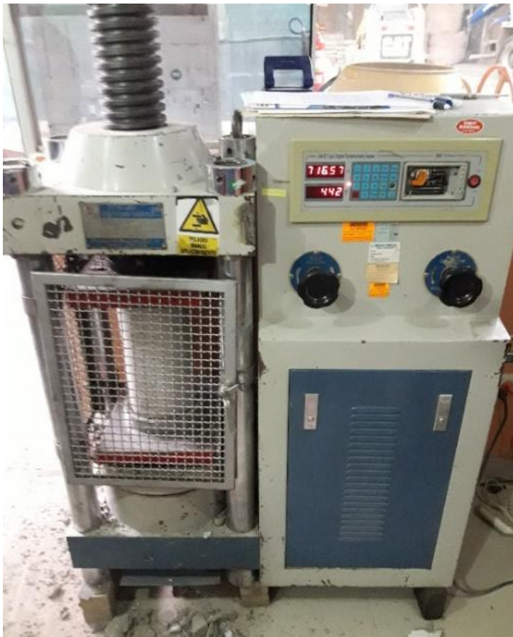
Fotografía N° 28. Ensayo de resistencia compresión de probetas cilíndricas
