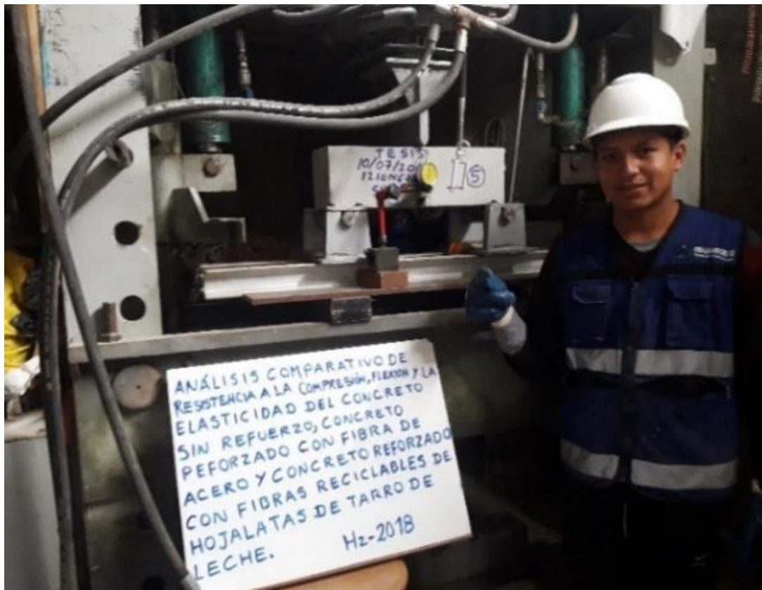
Fotografía N° 15. Rotura de probetas prismáticas sin refuerzo
