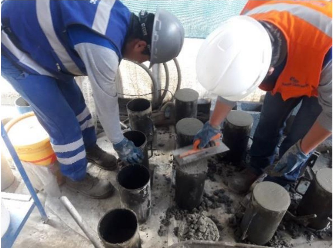
Fotografía N° 7. Elaboración de probetas cilíndricas
