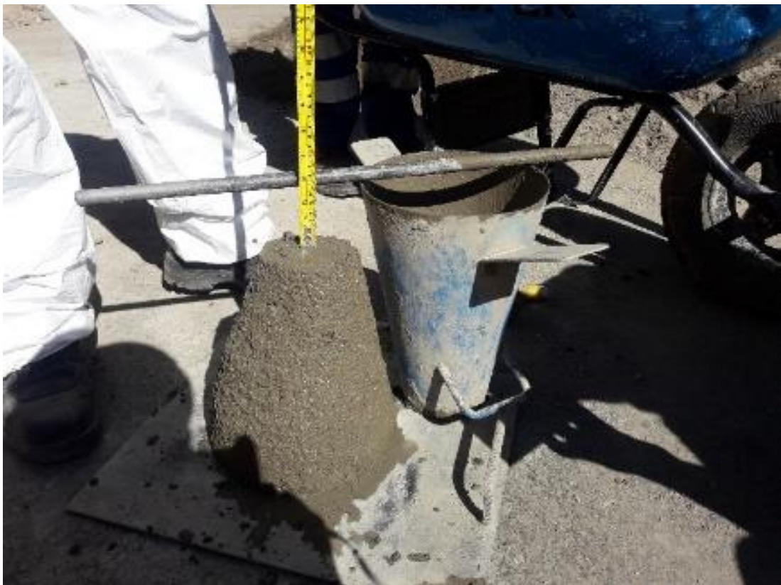
Fotografía N° 4. Ensayo de asentamiento (Slump), concreto con fibra
