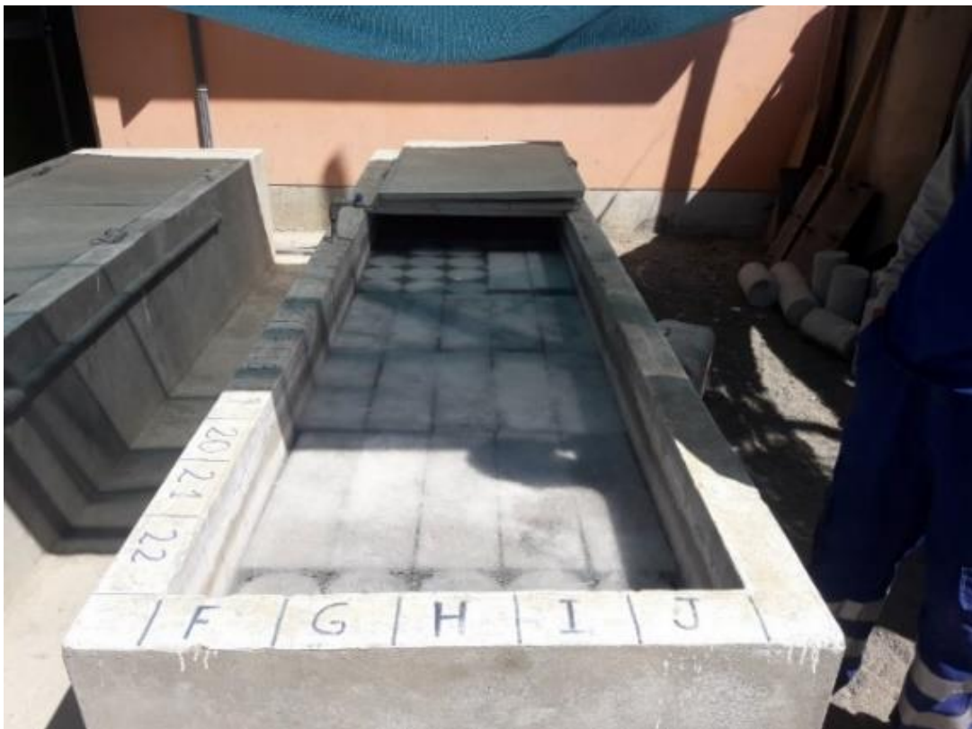
Fotografía N° 10. Curado de probetas prismáticas
