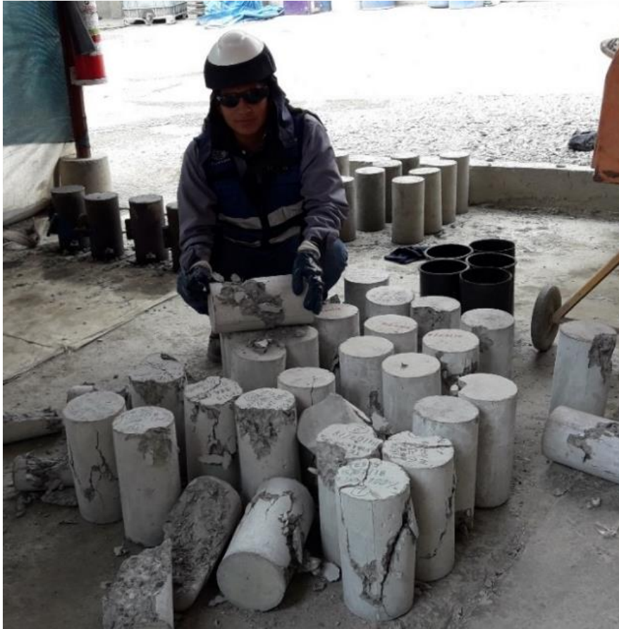
Fotografía N° 31. Probetas cilíndricas ensayados en resistencia a la compresión
