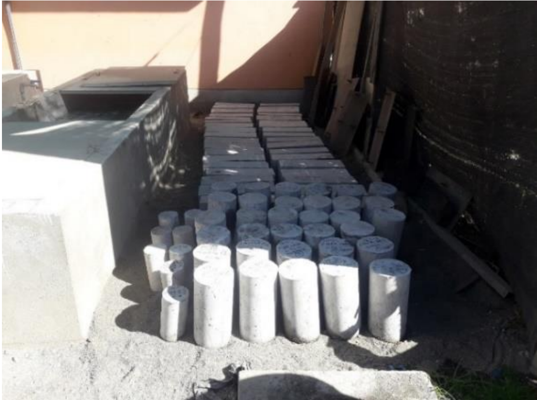
Fotografía N° 11. Probetas cilíndricas y prismáticas después del curado
