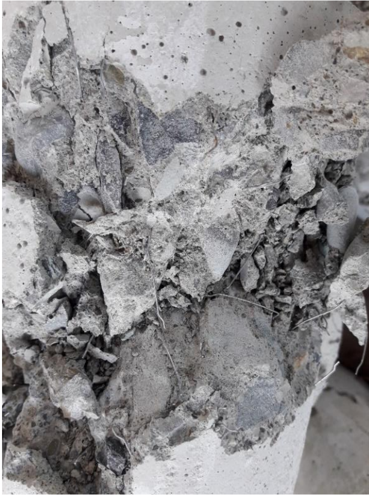
Fotografía N° 29. Rotura de probeta cilíndrica reforzado con fibra de acero
