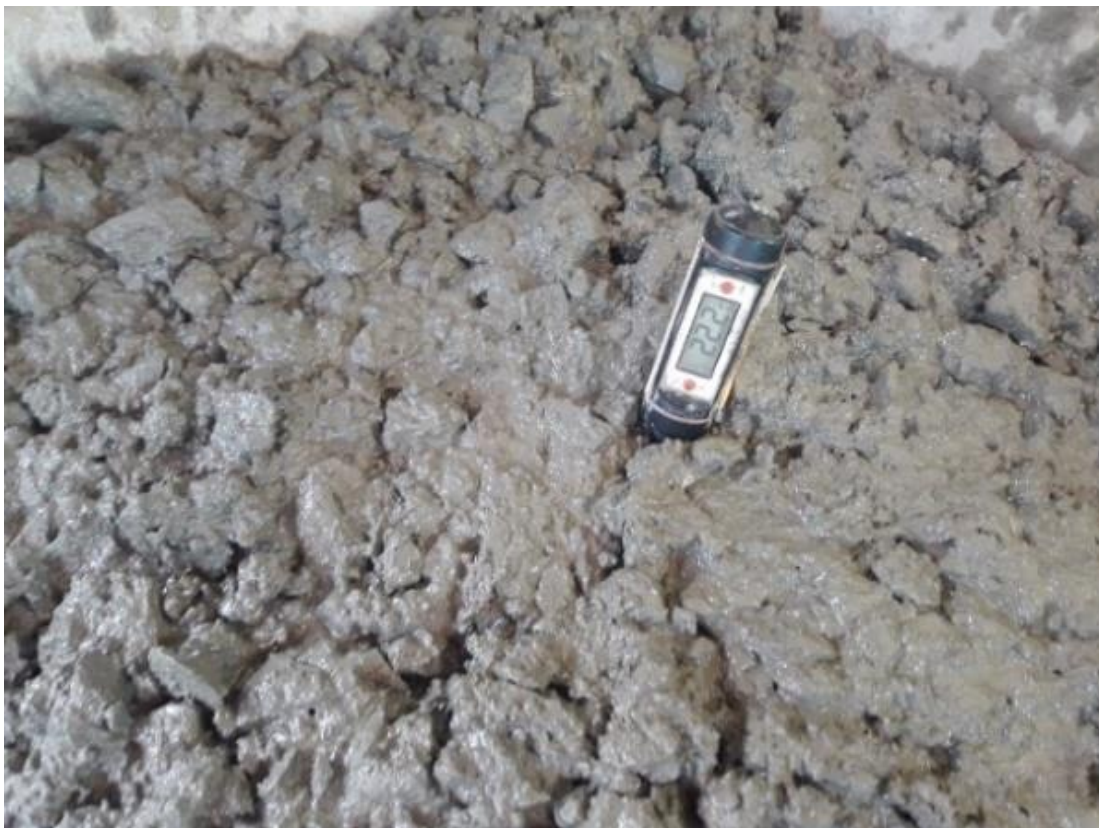
Fotografía N° 6. Temperatura de concreto con fibra
