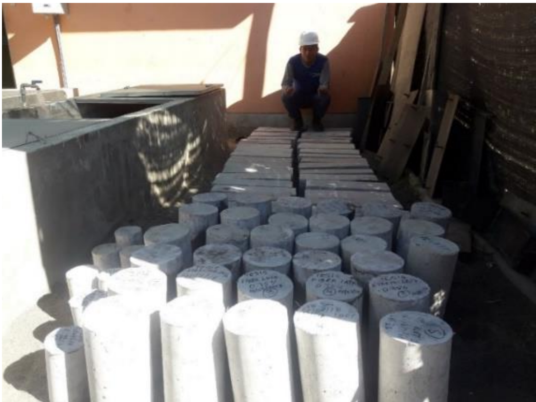
Fotografía N° 12. Probetas cilíndricas y prismáticas para sus ensayos respectivos
