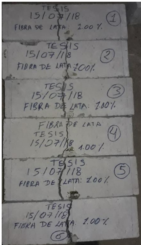
Fotografía N° 26. Fallas de probetas prismáticas
