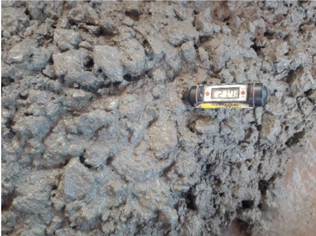
Fotografía N° 5. Temperatura de concreto sin fibra
