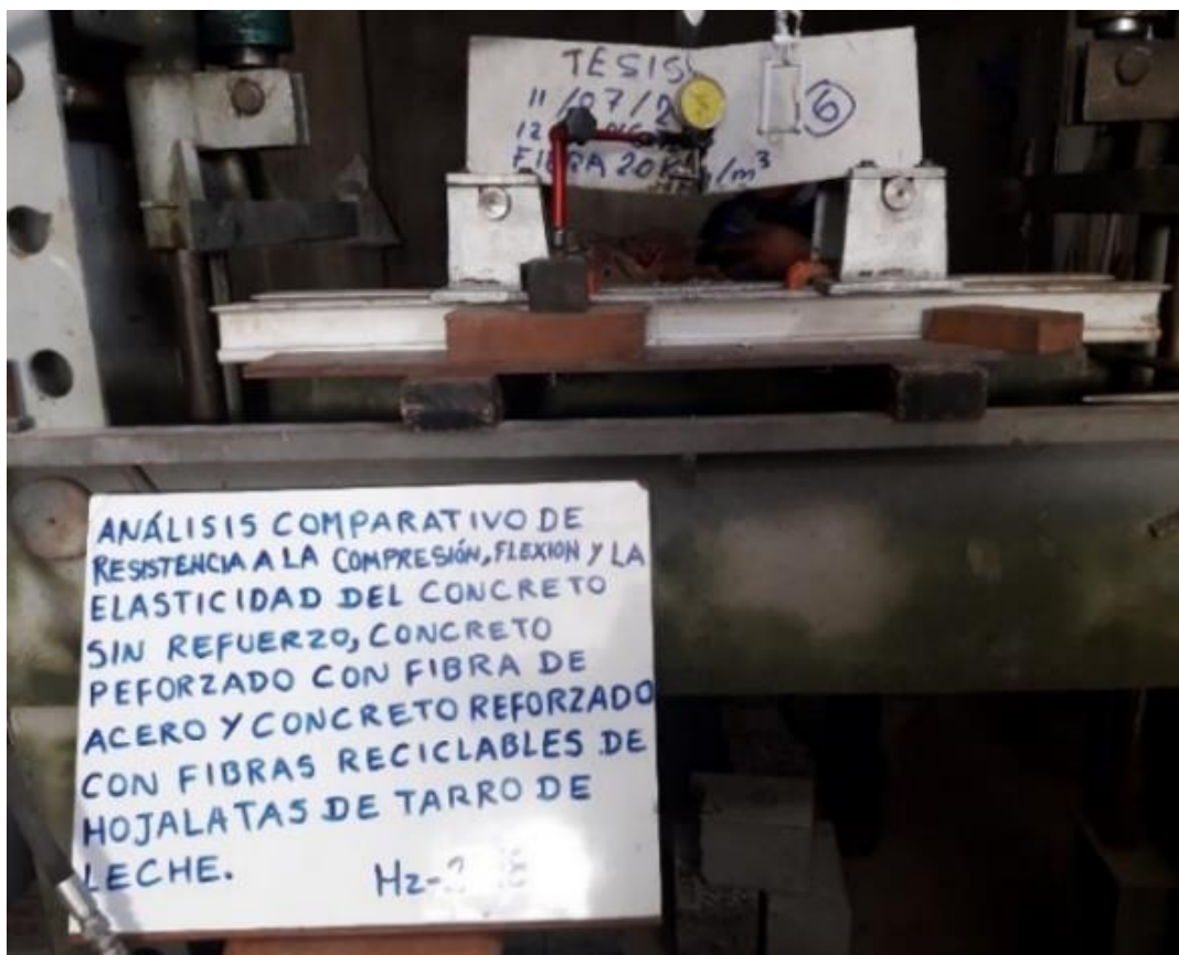
Fotografía N° 16. Rotura de probetas prismáticas con refuerzo de 20 kg/m 3 de fibra de acero
