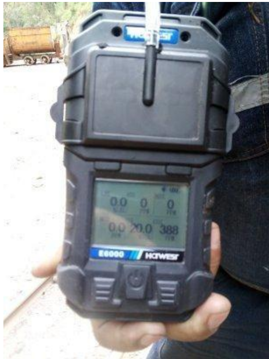
Fotografía 7. Medidor de Gases
