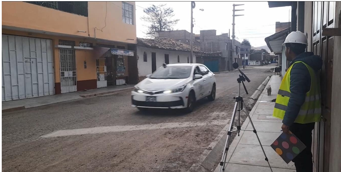
Figura 48: Medición del nivel de ruido de auto en situación sin tráfico
