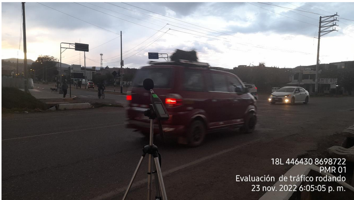
Figura 49: Medición del nivel de ruido de auto en situación con tráfico.
