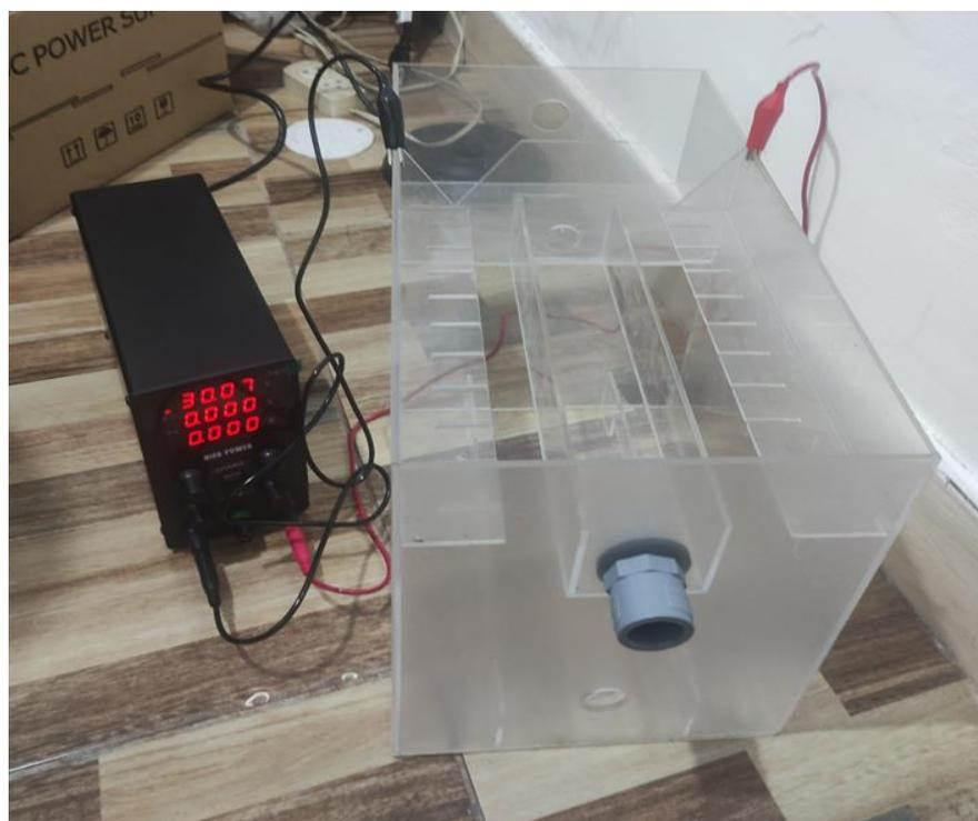
Fotografía 7 y 8: Armado final de la celda de electrocoagulación.
