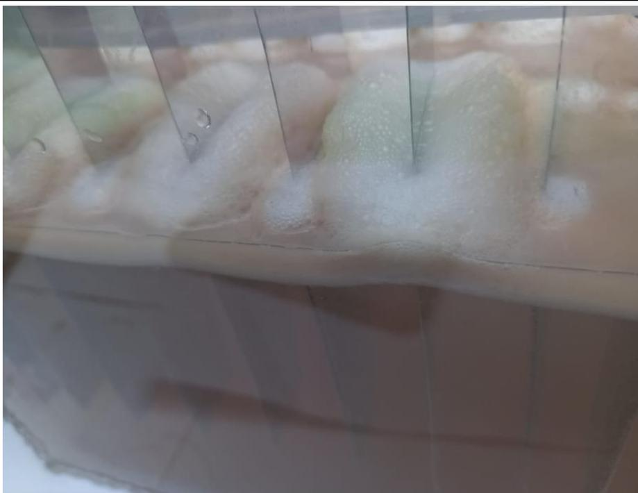
**Fotografía 28:** Formación de hidrogeno en el Cátodo
