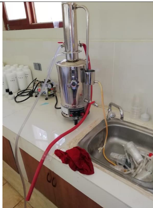
Mantenimiento del destilador.
