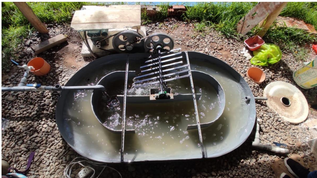
Foto 21: Prueba Hidráulica y Puesta en Marcha de la Zanja de Oxidación
