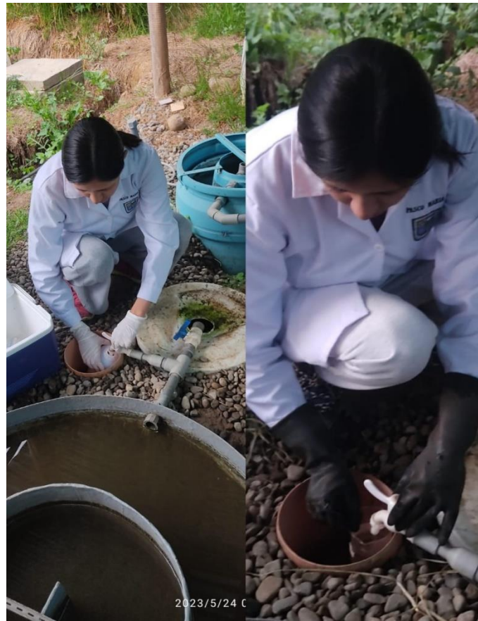
Foto 52: Toma de Muestra a la Salida de la Zanja
