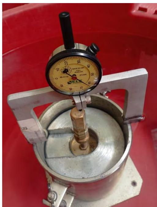
Sumergido de moldes para posterior ensayo.
