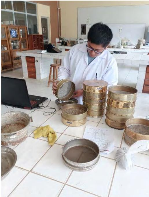
Separación y pesado de material retenido en los tamices.
