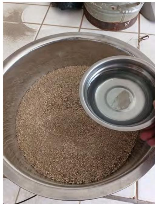
Mezcla del Polycom diluido con agua con la muestra a estabilizar.
