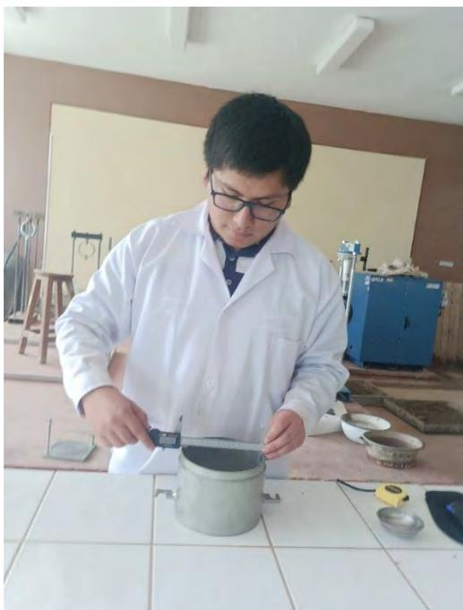
Verificación de medidas de los moldes a usar para los ensayos correspondientes.
