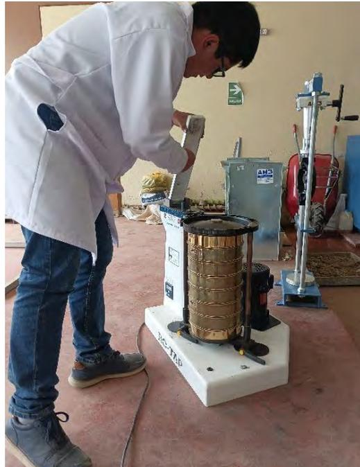
Vibrado de tamices para análisis granulométrico.
