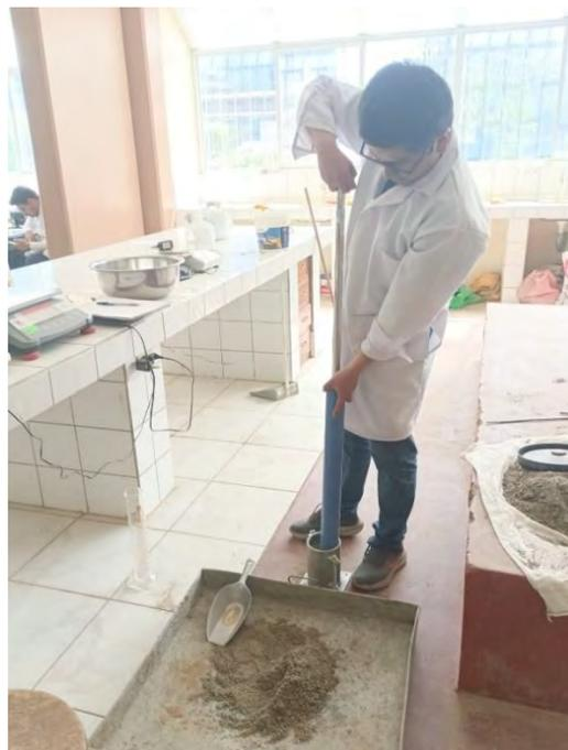
Ensayo de compactación de suelos en laboratorio utilizando una energía modificada.
